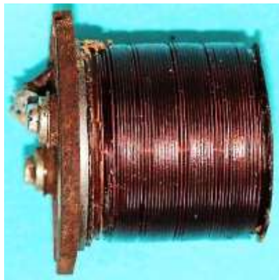
Bild 2.22: Untere Klauenpolanordnung mit Ankerspule: a) Aufgeschobene Spule, b) Ringspule, c) Ringspule und untere Klauenpolanordnung
