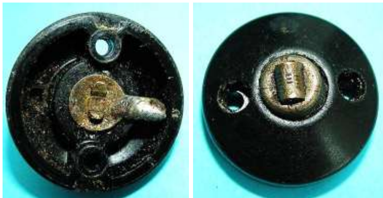
Bild 7.10: Boden: a) Innenseite mit Kabelschuh b) Kabelanschluss
