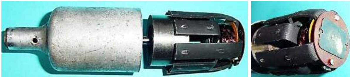
Bild 6.9: Lagerhalstopf, Magnetläufer, Klauenpolanker, Kontaktplatte
