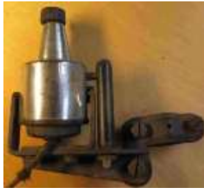
Erster Philips-Dynamo: 1935 Modell 7404, 4 V, 1,4 W Modell 7406, 6 V
