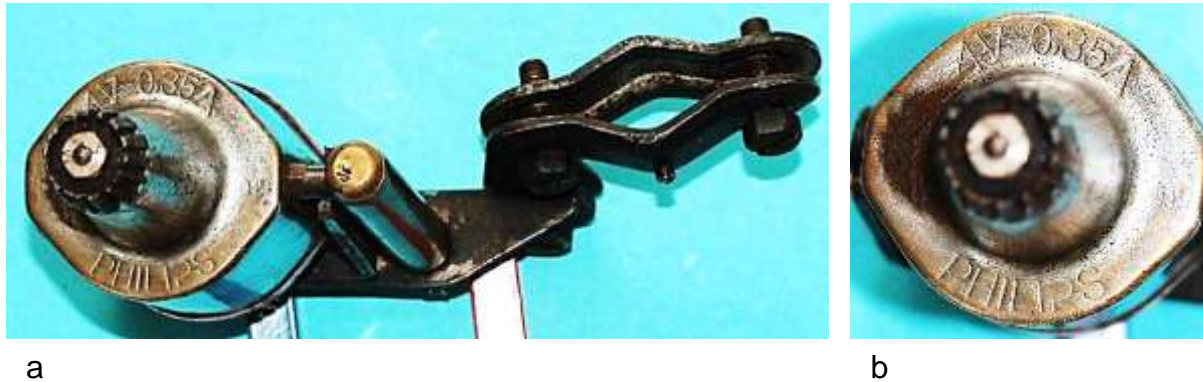
Bild 2.11: Ansicht von oben: a) Dynamo mit Halter, b) Beschriftung auf dem Lagerhalsfuß: 4 V, 0,35 A, PHILIPS
