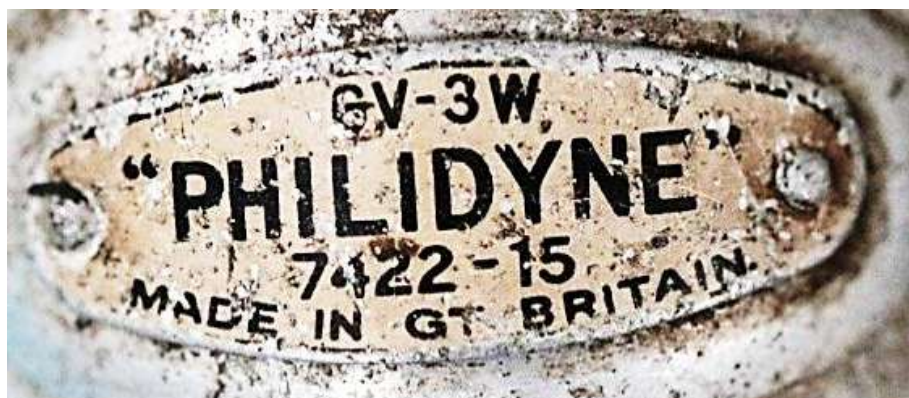
Bild 1.16: Leistungsschild der englischen Variante des Typs Philidyne 7422
