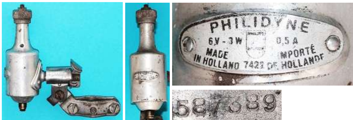
Bild 5.2: Philidyne 7422, 3 W mit der Fertigungsnummer 587389
