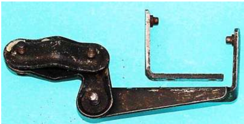
Bild 2.13: Basisblech mit angeschraubtem Halter und abgehobenem Winkelblech
