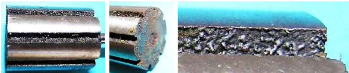
Bild 2.25: Oberflächenrauigkeit auf der Polfläche und in der Pollücke
