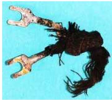
Bild 2.20: Kabelanschluss a) Spulenanschlüsse b) Am Kabel angelötete offene Kabelschuhe
