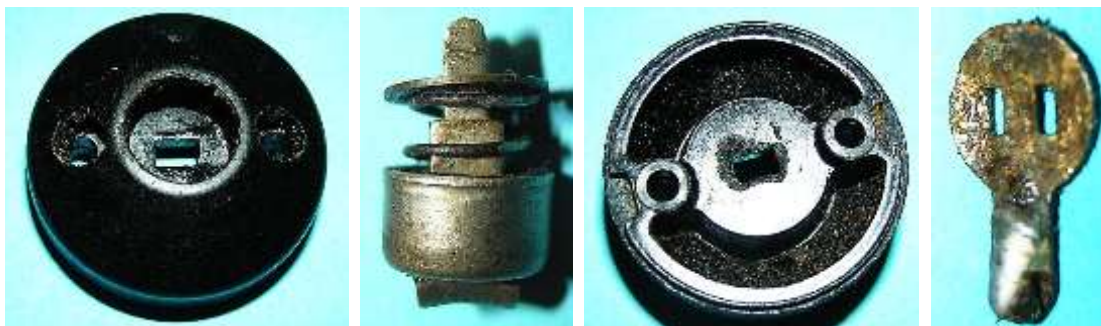
Bild 7.12: Boden mit den Komponenten des Kabelanschlusses
