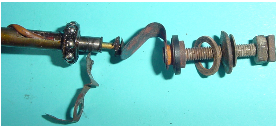
Bild 1.11: Stromleitung von der Spule zum Kabelanschluss
