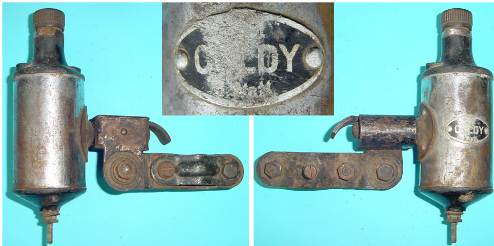
Bild 1.1: Stabmagnet-Dynamo mit der Typenbezeichnung „Coldy“ (3 W)
