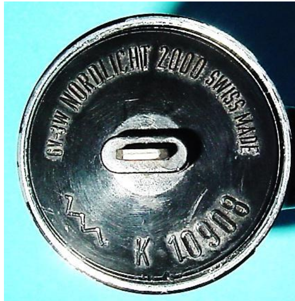
Bild 7.18: Nordlicht 2000, K 10908, pulverbeschichteter Lagerhalstopf
