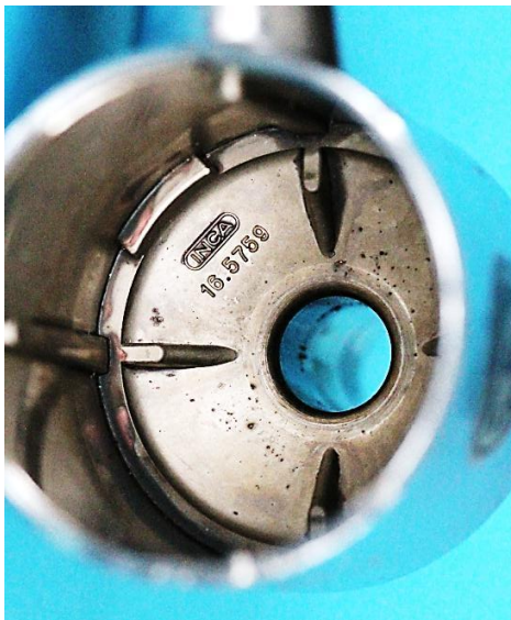
Bild 7.19: Gleiche Werkzeugnummern (INCA 16.5759) im Lagerhalstopf: a) K 10869, b) K 10908
