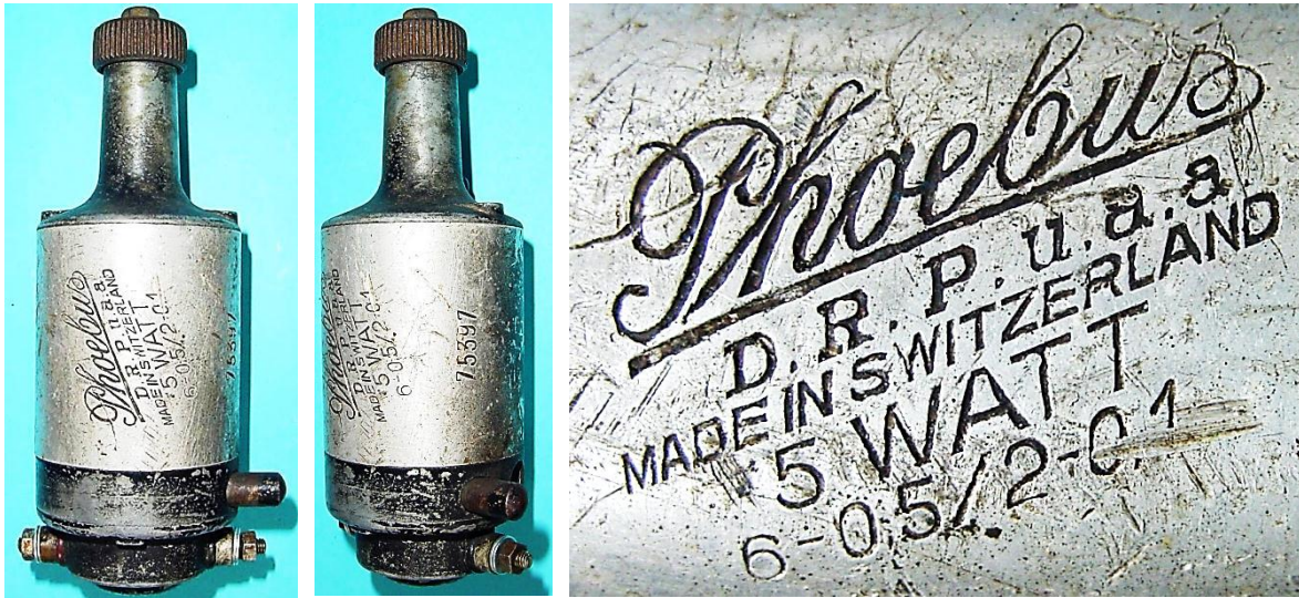
Bild 5.31: Dynamo von Phoebus für die Nennleistung von 5 W (Phoebus achtpolig)
