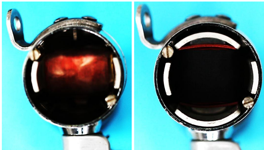
Bild 6.9: Ankerpositionen: a) Anker für das Rücklicht, b) Anker für den Scheinwerfer über dem Rücklichtanker
