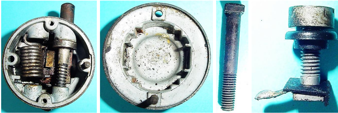
Bild 5.38: Boden: a) Zwischenboden mit Kippvorrichtung, b) unterer Boden, c) Bolzen mit quadratischem Kopf, d) Bolzen mit Lötstützpunkt
