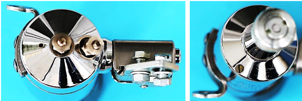
Bild 6.5: Ansichten: a) Boden mit zwei Kabelanschlüssen, b) Lagerhals mit Befestigungsschrauben im Lagerhalsfuß
