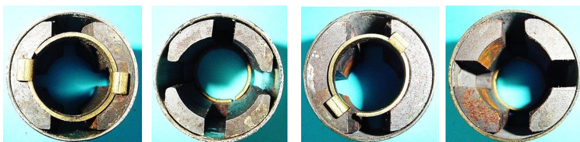
Bild 5.2: Vierpoliges Magnetsystem mit unterschiedlichen Magnetdicken: a) Joche 5 mm, b) Stirnseiten der Pole, c) Joche 7 mm, d) Stirnseiten der Pole
