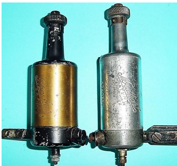
Bild 2.9: Ausgeführte Typen mit unterschiedlichen Längen der Polpaarsegmente
