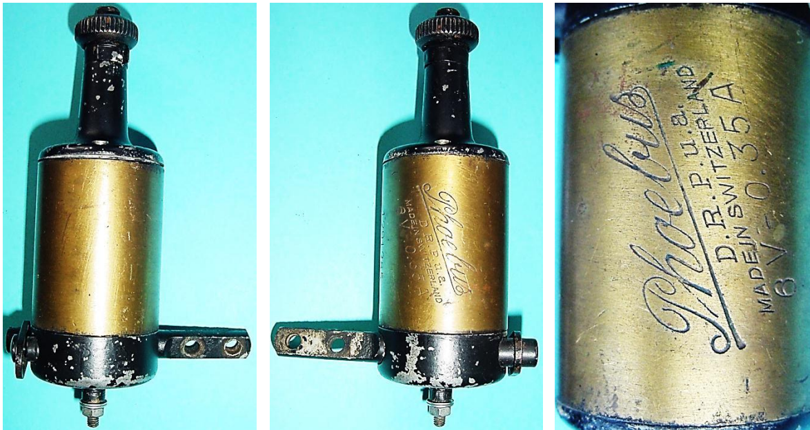
Bild 5.7: Vierpoliger Tulpenmagnet mit Polpaarsegmenten, 6 V, 0,35 A
