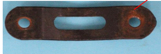
Bild 4.6; Verkürzung des Drehbolzens und Halterblech mit Langloch
