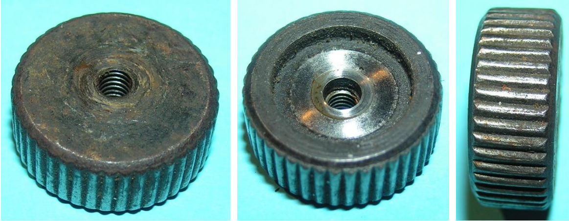
Bild 5.18: Massives Stahlreibrad: Durchmesser 21 mm, axiale Länge 8 mm
