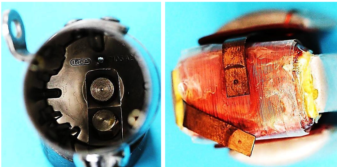
Bild 6.8: Kontakte: a) Durchführungskontakte im Boden, b) Blattfederkontakte der Spannungsführenden Spulenschlüsse
