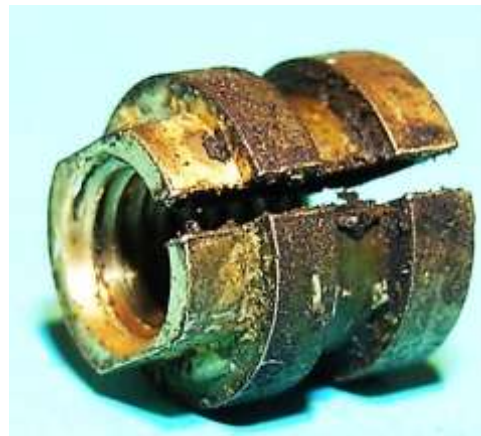
Bild 4.25: Reibrad und geschlitzte Mutter
