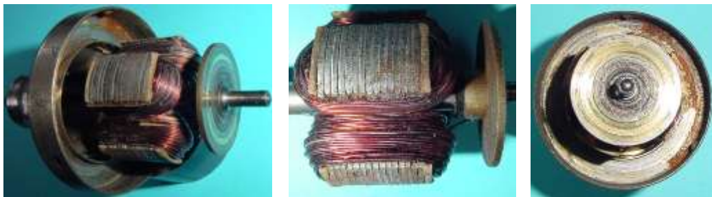
Bild 2.25: Wicklungsausführung des Sternankers und Kontaktteller
