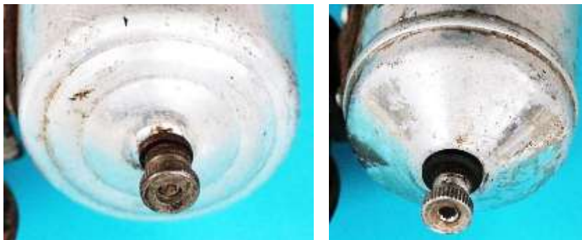
Bild 5.10: Bodengestaltung: a) G4.1a, ENWELL b) G4.1c, Elite
