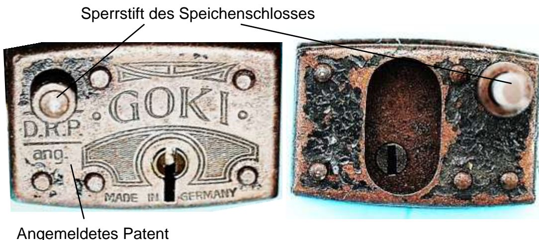
Bild 3.29: Vernieteter Schließkasten: a) Schlüssellochseite, b) Ausnehmung auf der Rückseite
