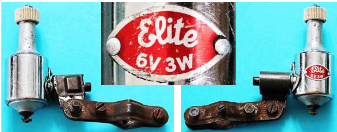
Bild 1.21: Elite-Dynamo mit ruhendem AlNi-Magneten
