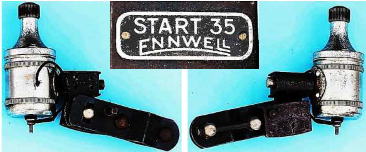
Bild 3.24: EnnWell Start 35, 2,1 W, Nr.A876590 mit Diebstalsicherung und Fahrrad-schloss
