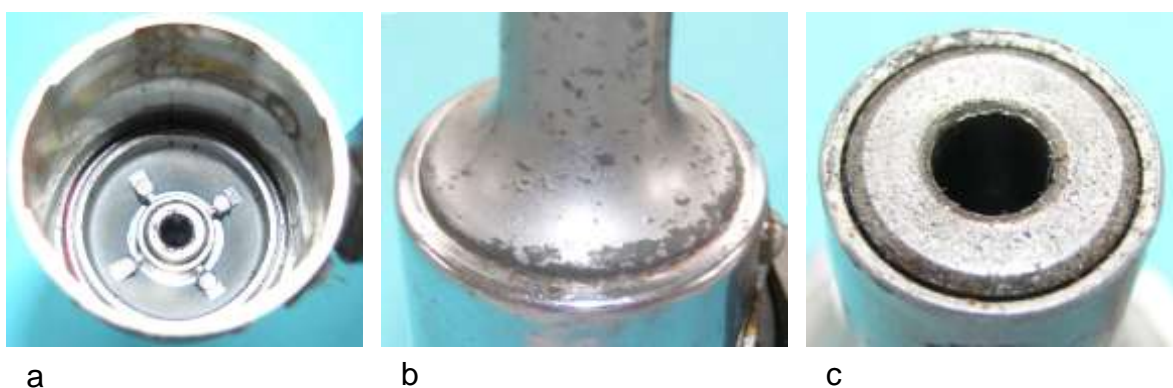
Bild 7.2: Lagerhals: a) Gehäusemantel mit Lagerhals, b) Umbörtelung des Mantels am Lagerhalsfuß, c) Oberes Gleitlager
