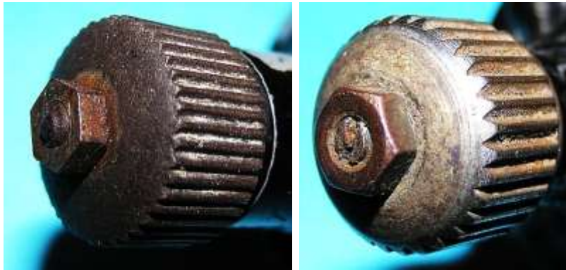
Bild 5.7: Reibräder d=19 mm: a) G4a und b, b) G4c
