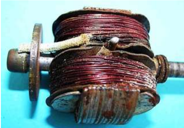
Bild 3.17: Schleifkontakte: a) Lötstützpunkt für den Spannung führenden Anschluss, b) Schleifkappe und Schleifscheibe
