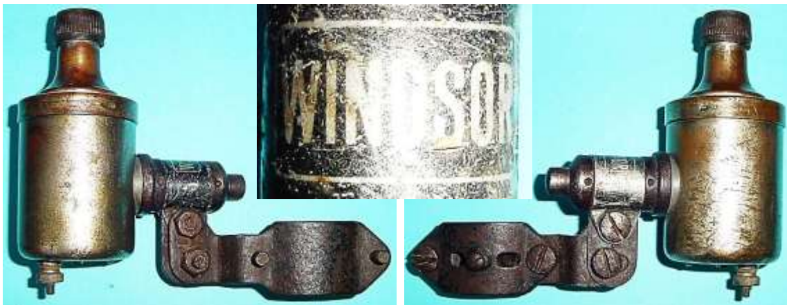
Bild 2.2: Windsor mit zweipoligem Tulpenmagneten
