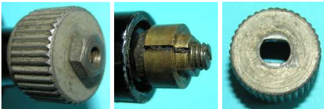
Bild 6.33: Befestigung des Reibrades: a) Reibrad mit Mutter, b) Geschlitzte Kontermutter, c) Öffnung des Reibrades mit konischen Seitenflächen
