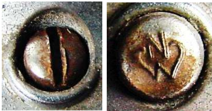
Bild 4.4: Deckkappe für die Schlitzschraube mit den eingepreßten Buchstaben N und W
