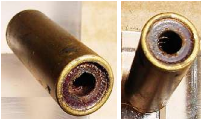
Bild 3.2: Stapellager bestehend aus einem Messingrohr und Perlinaxscheiben
