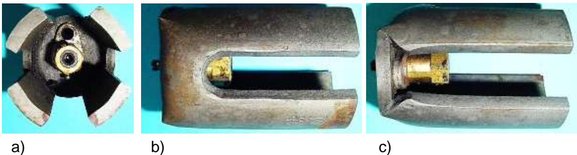
Bild 2.20: Vierpoliges Tulpenmagnetsystem: a) Innenansicht, b) Kurze Pollücke, c) lange Pollücke
