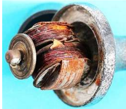
Bild 3.17: Schleifkontakte: a) Lötstützpunkt für den Spannung führenden Anschluss, b) Schleifkappe und Schleifscheibe
