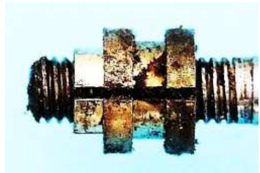
Bild 3.39: Reibrad: a) Gesehnte Bohrung, b) Versenkte Kontermutter, c) Axial geschlitzte Kontermutter
