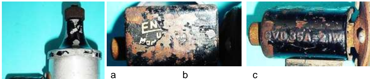
Bild 5.12: G41. a) ENNWEILL-US-Zone 2,1 W, a) Gesamtansicht, b) Schrift auf schwarzem Grund auf der Kippvorrichtung c) Eingeprägte Nenndaten auf der Kippvorrichtung
