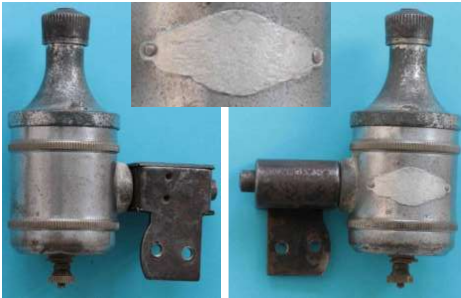
Bild 3.9: Dynamo mit zwei poligem Tulpenmagneten,
