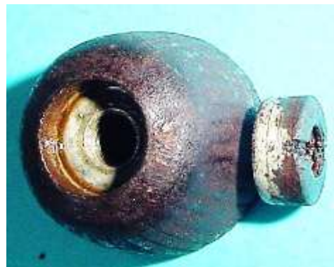
Bild 4.37: Reibrad mit Kontermutter
