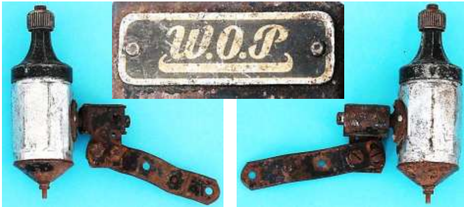
Bild 6.22: Dynamo W.O.P mit dreiteiligem Gehäuse
