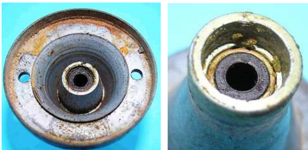
Bild 4.29: Gleitlager aus Petinaxschei- ben
