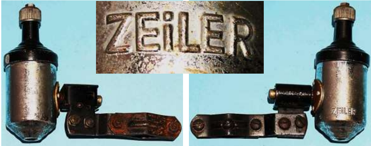
Bild 5.25: Zeiler-Dynamo 2,1 W, Manteldurchmesser 45 mm
