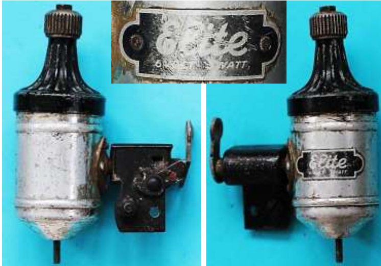
Bild 5.17: G4b: ENNWELL - Elite, Eingeprägte Nenndaten auf der Kippvorrichtung: 6 V, 0,5 A = 3 W
