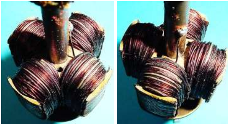
Bild 2.19: Sternanker mit der Kontaktierung eines Spulenenendes an der Welle
