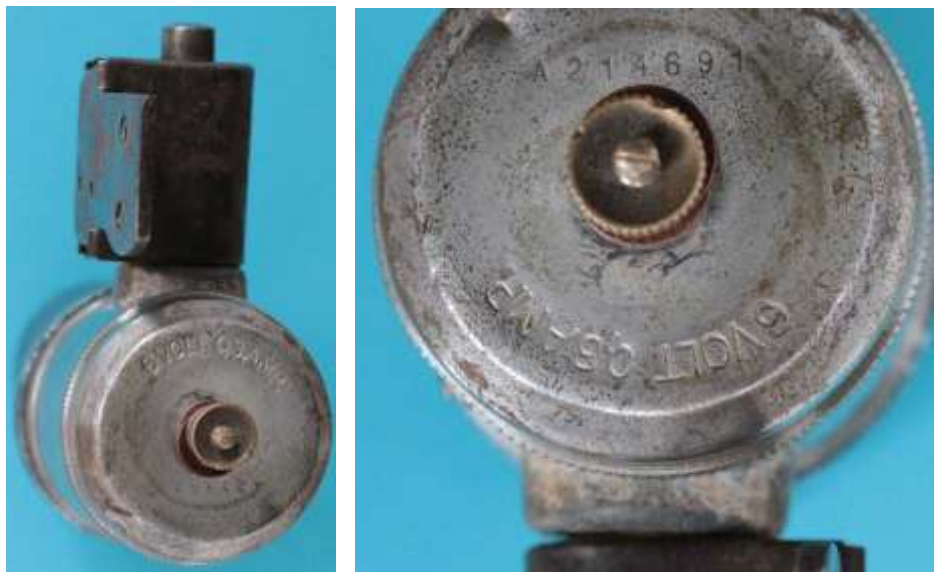
Bild 3.10: Beschriftung des Bodens mit den Nenndaten 6 V; 0,3 A und der Fertigungsnummer A214691
