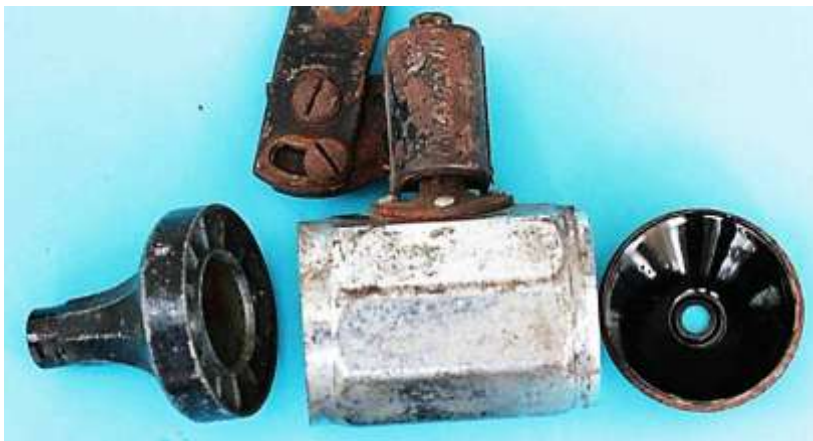
Bild 6.23: Gehäuseteile a) Spritzgusslagerschild b) Gehäusemantel aus Messing, c) Boden aus Eisenblech
