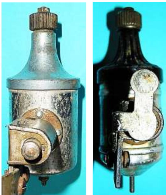
Bild 5.8: Einsatz eines Fußhebels zur Entriegelung des Dynamos a) G4.1a und b, b) G4.1c
