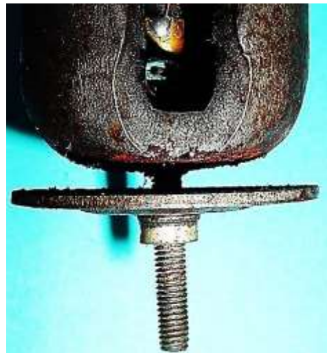
Bild 6.18: Ein- engung des Jochs für die Spannbolzen
