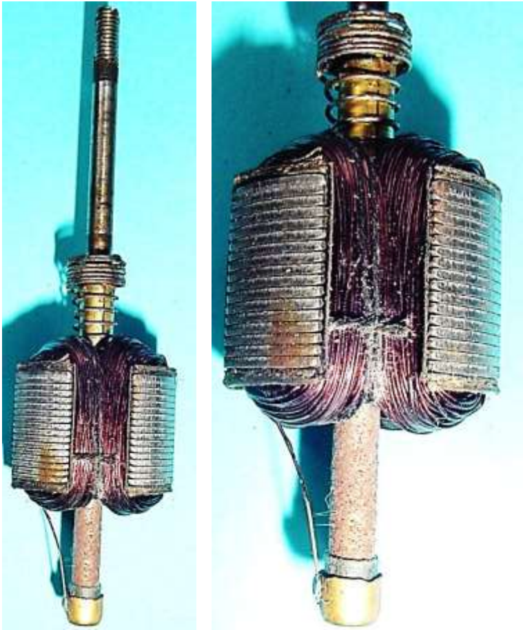
Bild 6.21: Anker mit abge- bundener Wicklung, 17 Ble- che
