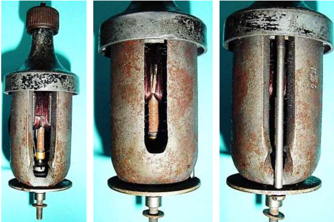
Bild 6.17: Abgenommener Gehäusetopf mit Blick auf den Federkontakt, b) Kurze Pol- lücke, c) Lange Pollücke mit Spannbolzen
