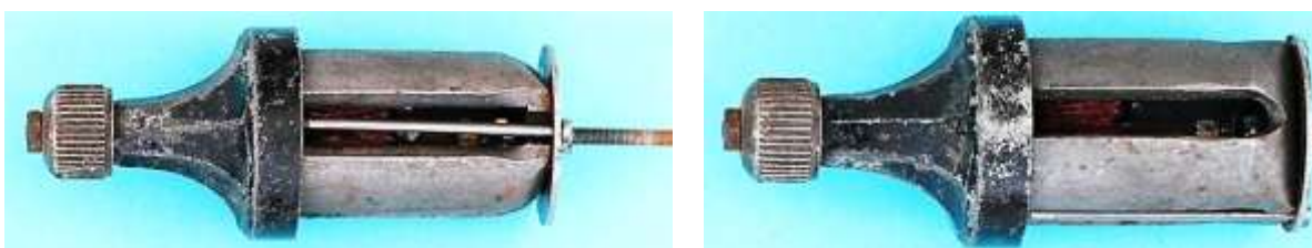
Bild 6.24: Pollücken mit und ohne Spannbolzen
