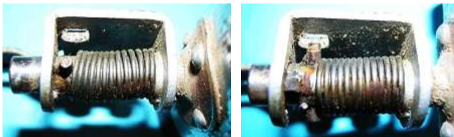
Bild 6.6: Stellungen des Sperrstiftes: a) Ruhestellung, b) Betriebsstellung
