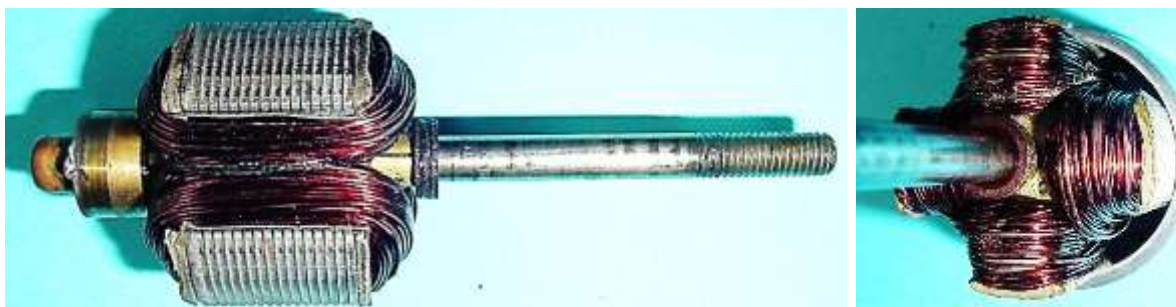
Bild 4.9: Spulenseiten und Wicklungsköpfe der Ankerwicklung
