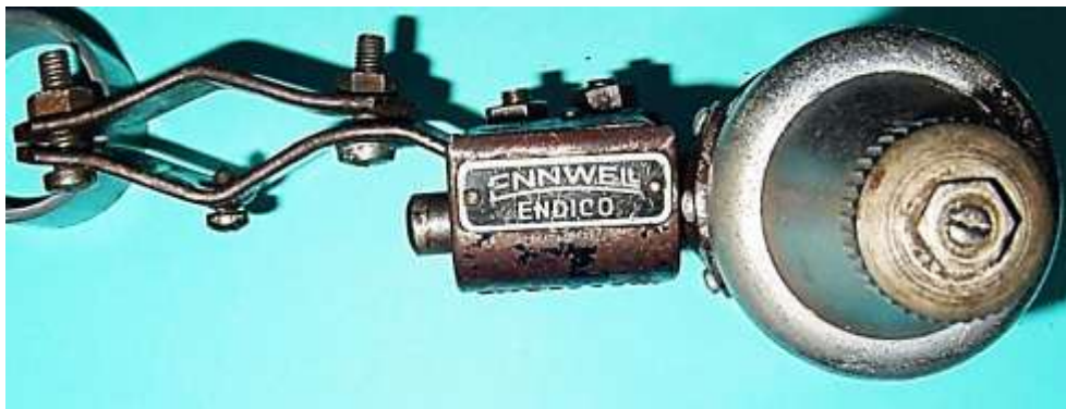
Bild 6.39: An- sicht des Hal- ters, der Kippvorrich- tung und des Reibrades
