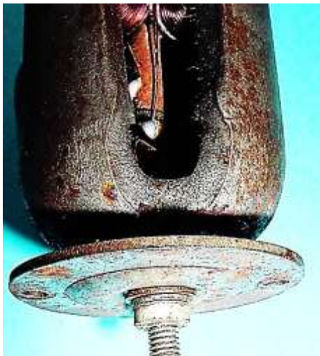
Bild 6.17: Abgenommener Gehäusetopf mit Blick auf den Federkontakt, b) Kurze Pol- lücke, c) Lange Pollücke mit Spannbolzen
