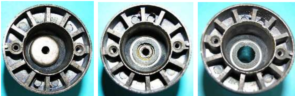
Bild 6.34: Lagerhalsfuß: a) Kontaktscheibe, b) Stapellager: c) Entferntes Lager
