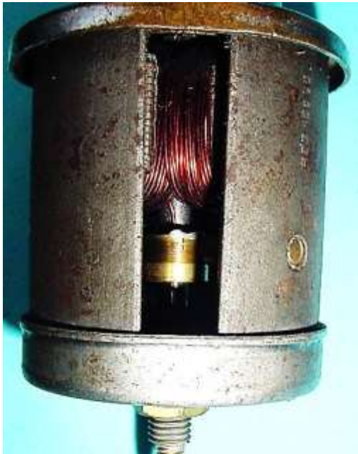
Bild 4.43: Massekontakt: a) Schleifring, b) Kupferbürste und Bürstenhalter
