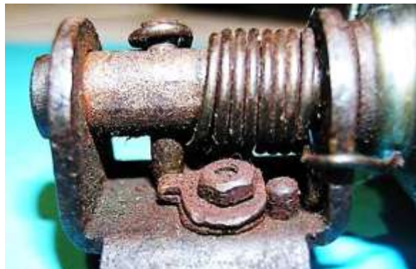
Bild 4.36: Kippvorrichtung a) Bedienungsseite b) Drehpunkt des Hebels mit Sperrstift
