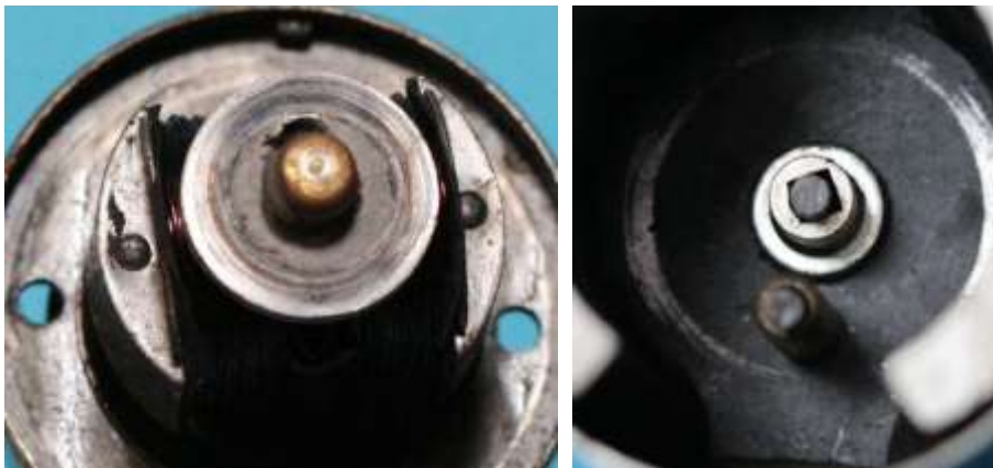
Bild 3.7: Schleifkontakte: a) Schleifscheibe und Schleifkappe b) Kohlebürsten (nicht original)
