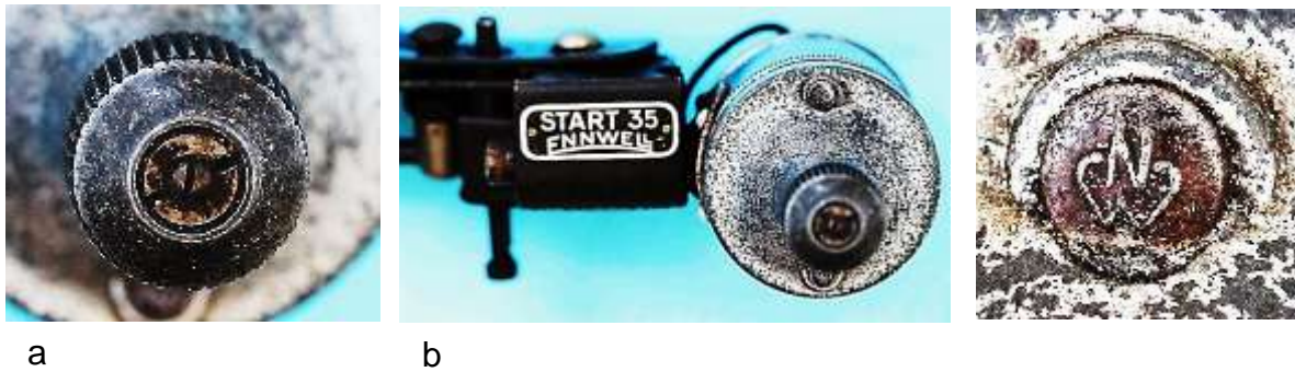
Bild 3.27: Ansicht von oben: a) Befestigung des Reibrades durch eine geschlitzte Kontermutter, b) Angenietetes Typenschild, c) Monogramm auf der Versiegelung der Bolzenköpfe
