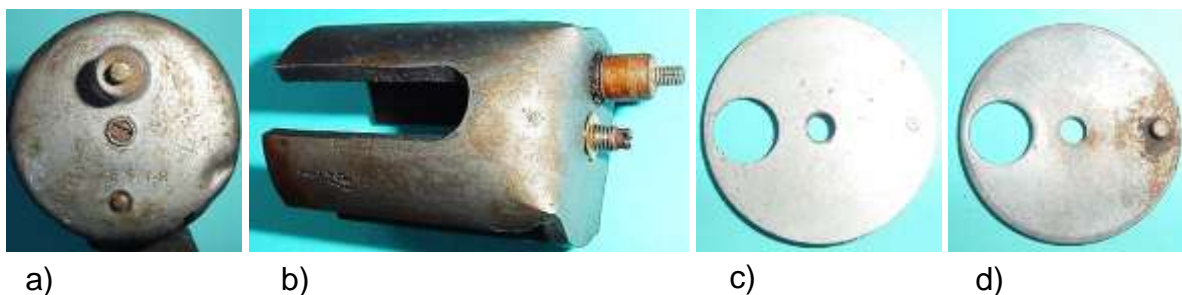
Bild 2.22: Einzelteile im Bodenbereich: a) Gehäuseboden, b) Kontakt und Spannschraube, c) Oberseite der Druckplatte, d) Unterseite der Druckplatte mit Justierstift
