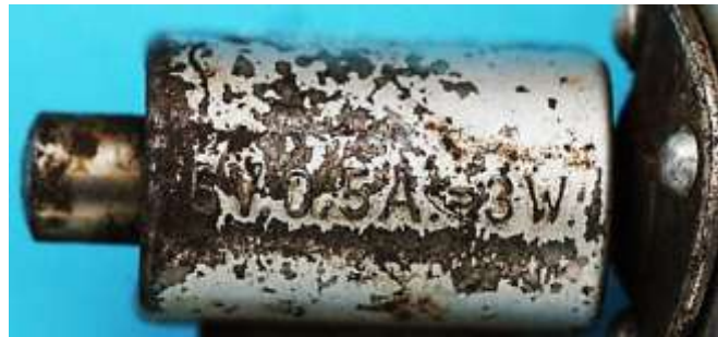
Bild 5.6: Nenndaten auf der Abdeckung der Kippvorrichtungen: a) G4.1a, b) G4.1b
