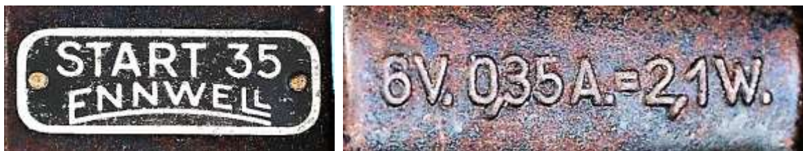
Bild 3.25: Informationen auf der Abdeckung der Kippvorrichtung: a) Aufgenietetes Typenschild, b) Eingepreßte Nenndaten
