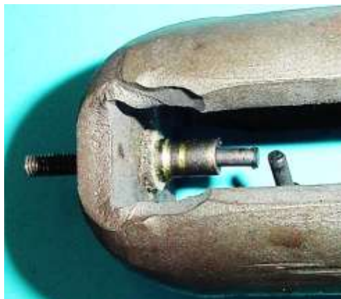
Bild 4.7: Blick auf die Bürsten durch unterschiedlich gestaltete Pollücken
