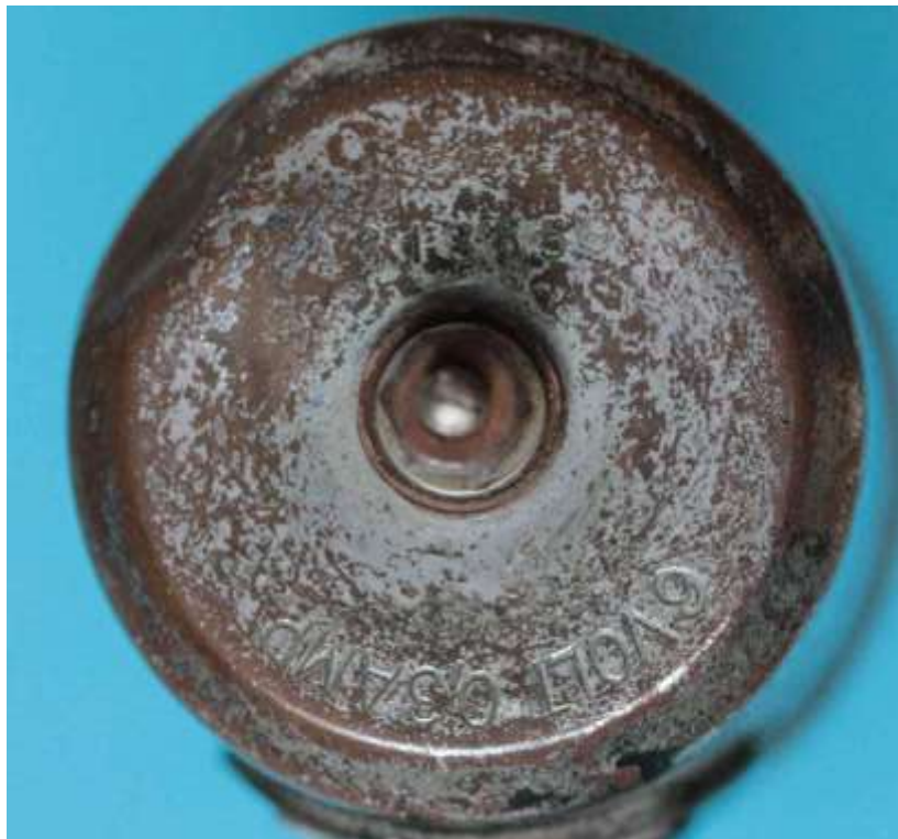
Bild 3.21: Eingeprägte Informationen a) Bodenbeschriftung: Nenndaten 6 VOLT und 0,3 AMPER (unten) und Fertigungsnummer A 31365 (Im Foto unleserlich), b) Firmenstempel des Magnetherstellers „Zwillings“ mit der Kennzeichnung der Polarität und mit der zusätzlichen Ziffer 4
