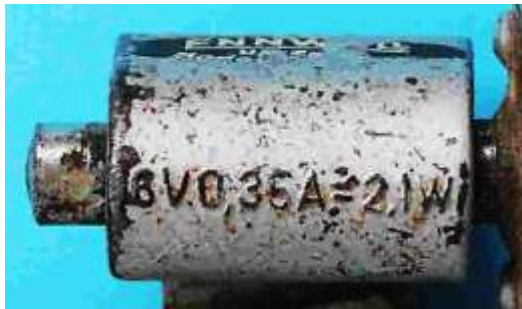
Bild 5.6: Nenndaten auf der Abdeckung der Kippvorrichtungen: a) G4.1a, b) G4.1b
