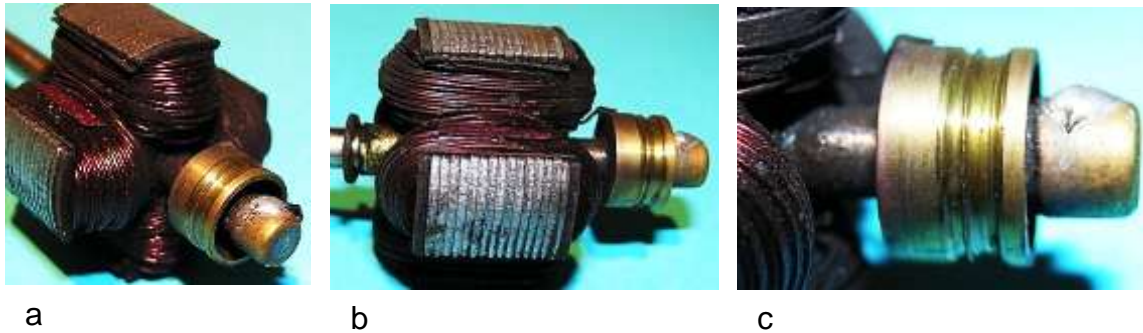
Bild 4.21: Masseschleifring: a) Stirnseite des Ankers mit beiden Schleifelementen, b) Seitenansicht des Ankers, c) Von der Bürste eingeschleifene Rille
