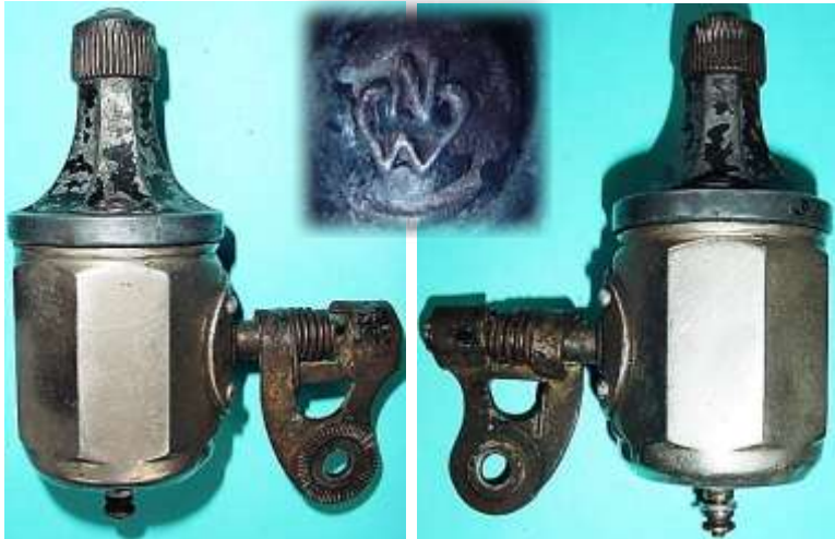
Bild 4.13: Vierpoliger ENWELL-Dynamo mit modifizierter Kippvorrichtung und dem Firmenlogo auf den Schraubenköpfen
