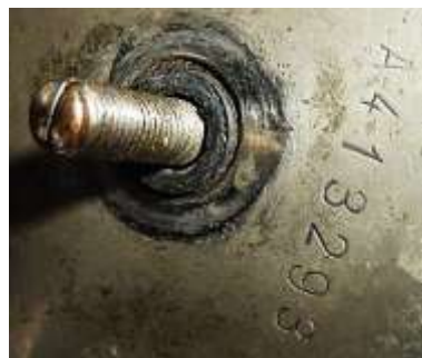
Bild 4.17: Befestigung des Gehäusetopfes am Spannung führenden Bolzen
