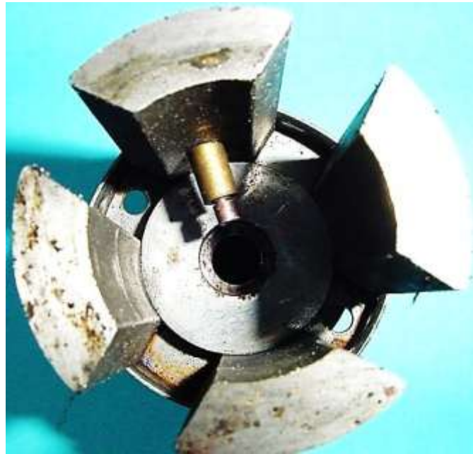
Bild 4.43: Massekontakt: a) Schleifring, b) Kupferbürste und Bürstenhalter
