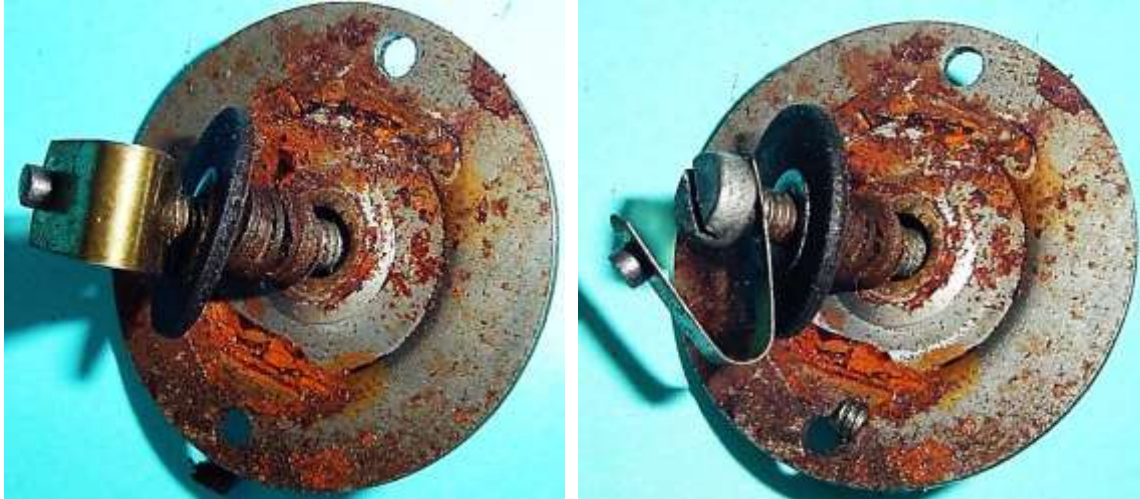
Bild 6.20: Blattfeder mit Kabelanschlussbolzen und Spannplatte
