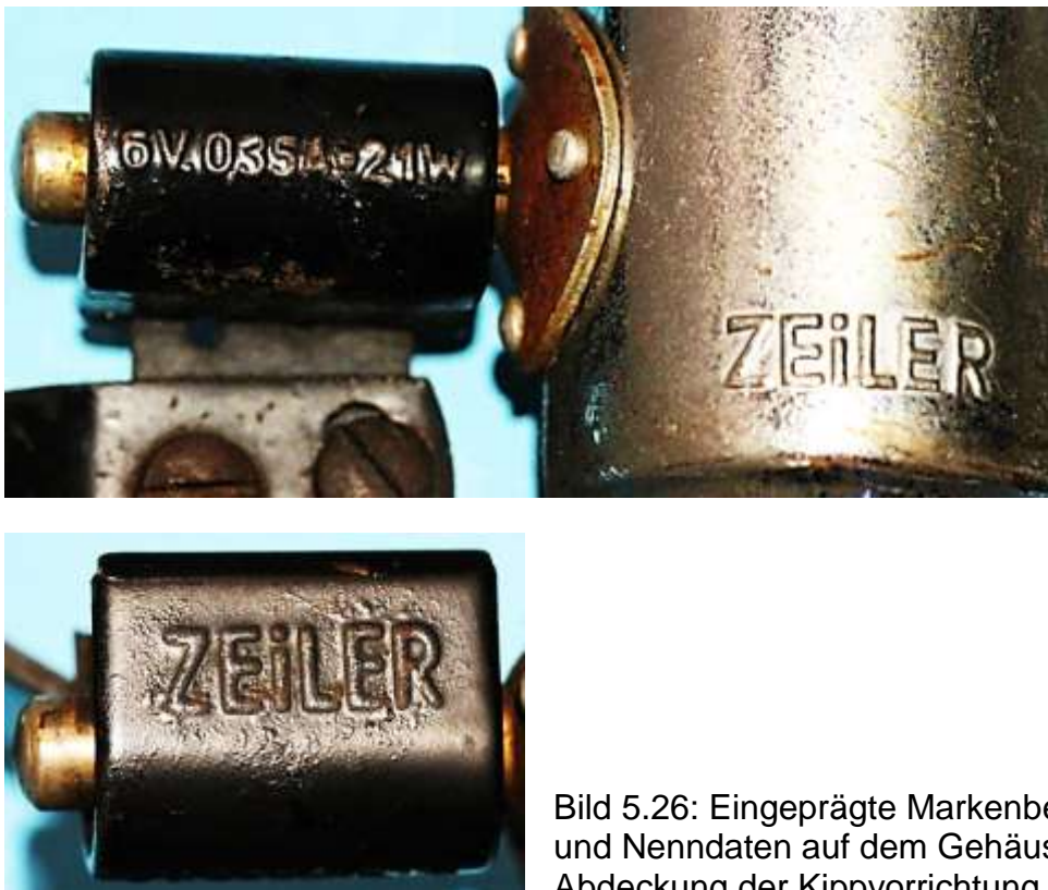
Bild 5.25: Zeiler-Dynamo 2,1 W, Manteldurchmesser 45 mm
