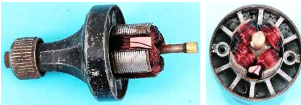
Bild 6.26: Anker mit Lagerhals: a) Polfläche des Blech- pakets, b) Wick- lungsköpfe
