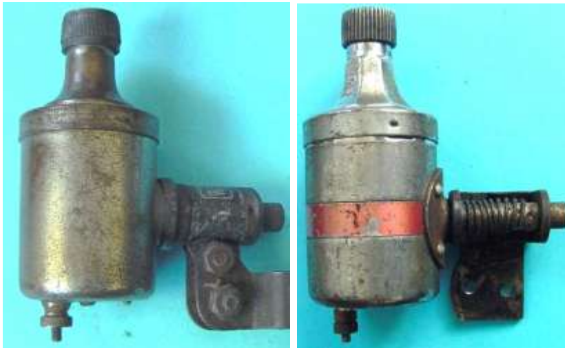
Bild 2.1: Dynamos mit zweiseitiger Lagerung a) Zweipolig b) Vierpolig
