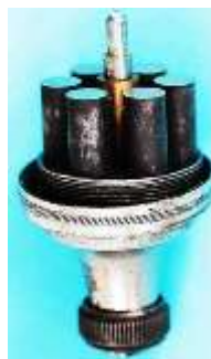
Bild 2.2: 6-polige Generatoren a) Anordnung von Emil Stöhrer (1813-1890) mit rotierenden Spulen b) Dynamomarkte Assmann (20er Jahre) mit rotierenden Magneten
