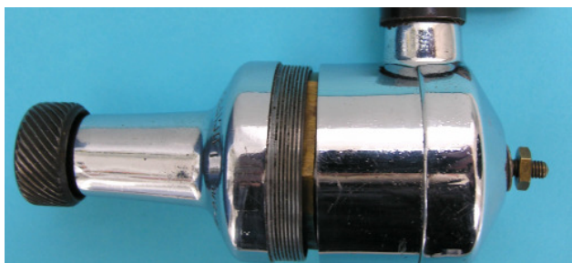
Bild 1.2: Schraubverbindung der zwei Gehäuseteile
