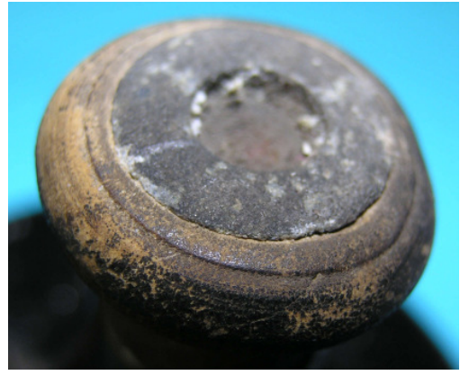
Bild 1.5: Details: a) Originaler Kabelanschluss, b) Reibrad mit Gummiring
