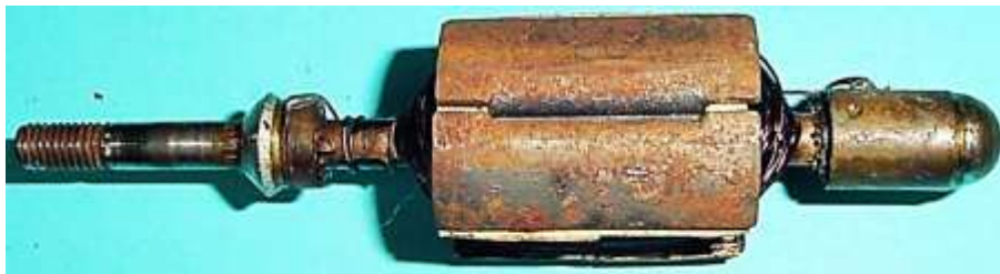
Bild 4.7: Anker mit den Wicklungsanschlüssen
