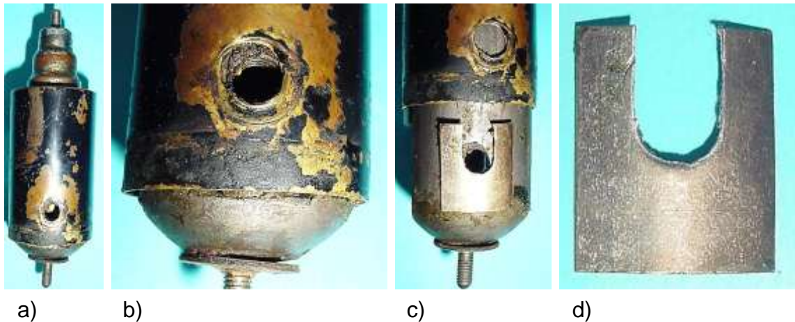
Bild 8.4: Befestigung des Drehbolzens: a) Bohrung im Gehäusemantel, b) Gewindebohrung im Magneten, c) Hochgeschobener Gehäusemantel, d) Stabilisierungsblech
