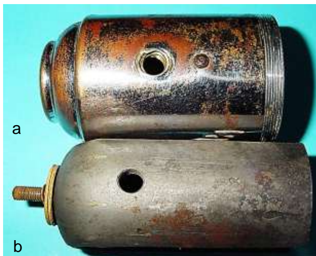
Bild 4.5: Polsystem, a) Gehäusemantel b) Zweipoliger Tulpenmagnet 78 mm lang, 5 mm dick
