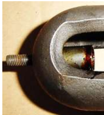
Bild 12.13: Axiallager: a) Lagerpfanne am Wellenende, b) Konstruktive Vereinigung von Axiallager und Kabelanschlussbolzen, c) Sitz der Kugel des Axiallagers
