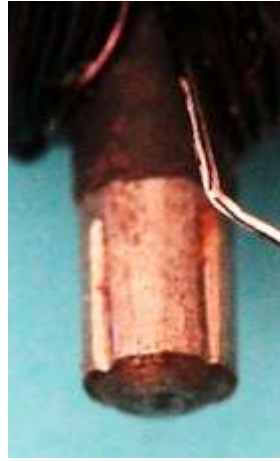
Bild 11.6: Kontaktzylinder: a) Kugelpfanne, b) Isolierter Innenraum, c) Gekerbtes Wellenende
