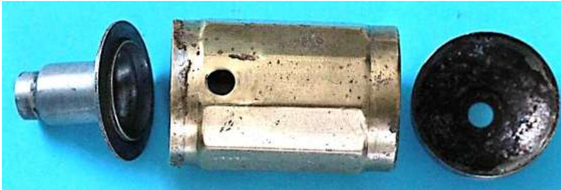
Bild 7.2: Dreiteiliges Gehäuse: Lagerhals, Mantel und Boden
