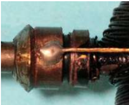
Bild 5.3: Masseanschluss des Schaltdrahtes
