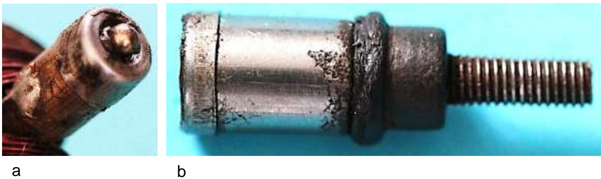
Bild 7.6: Axiallager: a) Kugelpfanne auf dem Wellenende, b) Federzylinder mit Kabelanschlussbolzen
