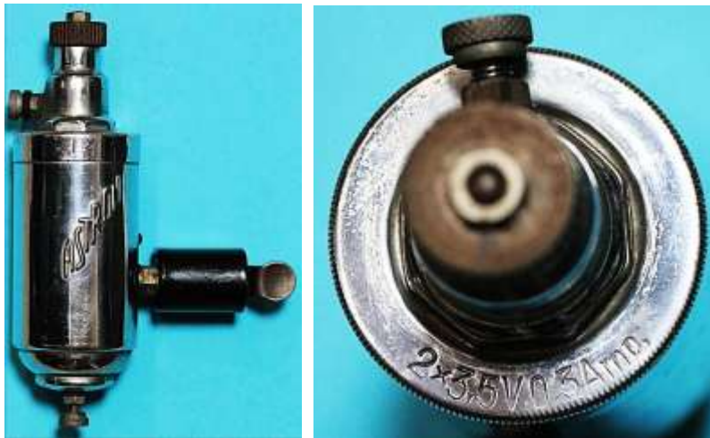
Bild 5.1: Astron (1), Nenn- daten 2x3,5 V; 0,5 A
