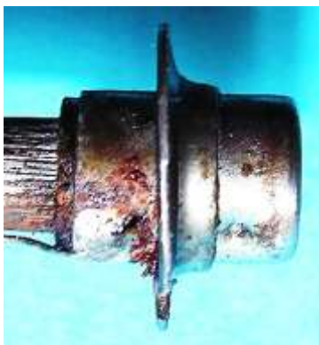
Bild 12.14: Spannung führender Kontakt: a) Fedia-Dynamo b) Astron-Dynamo
