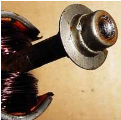
Bild 12.13: Axiallager: a) Lagerpfanne am Wellenende, b) Konstruktive Vereinigung von Axiallager und Kabelanschlussbolzen, c) Sitz der Kugel des Axiallagers
