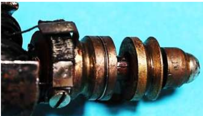
Bild 3.6: Befestigung der mit Widerstandsdraht umwickelten Blattfeder auf dem Kunststoffkörper
