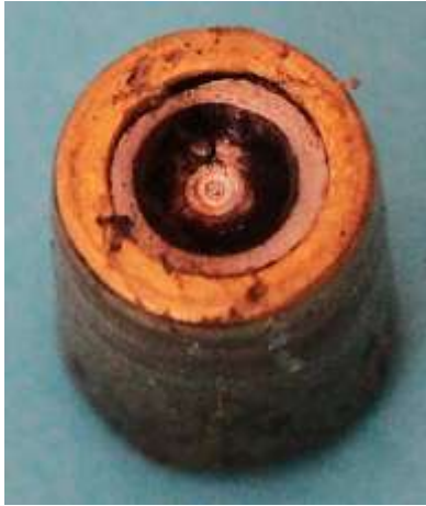
Bild 11.6: Kontaktzylinder: a) Kugelpfanne, b) Isolierter Innenraum, c) Gekerbtes Wellenende
