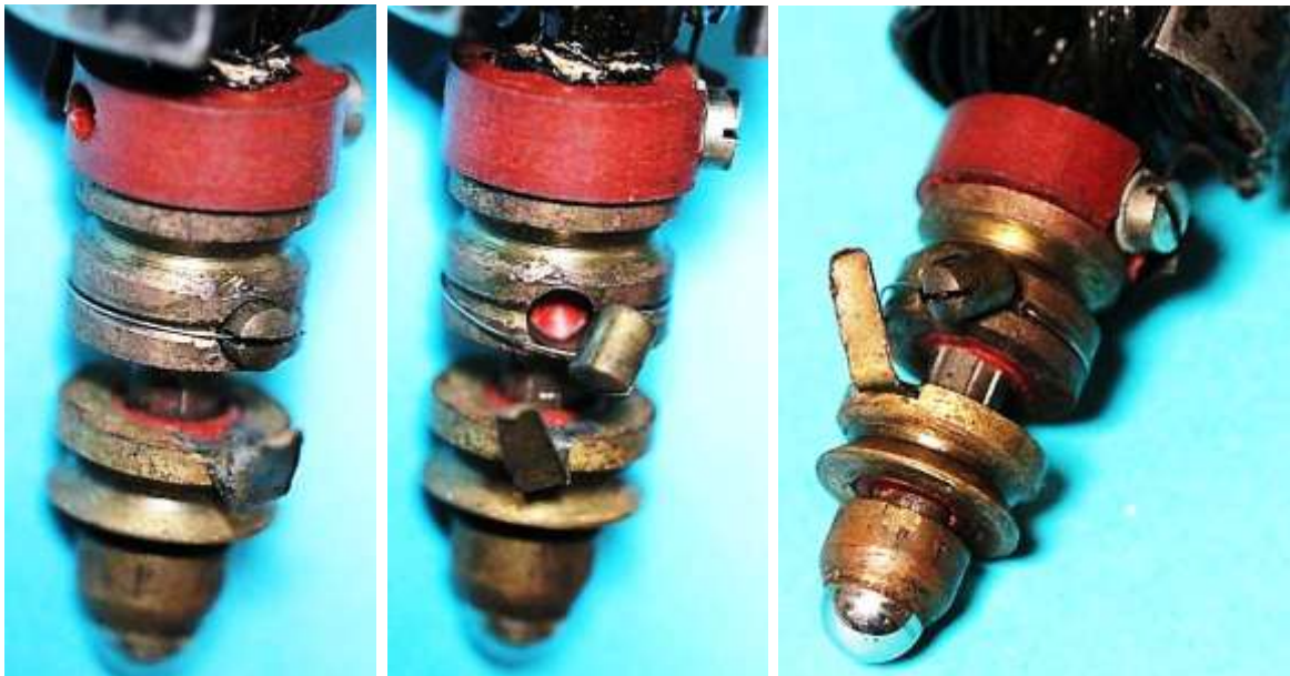
Bild 3.10: Kurzschließer: a) Fliehkraftbolzen in der Ruheposition, b) und c) Herausgehobener Fliehkraftbolzen
