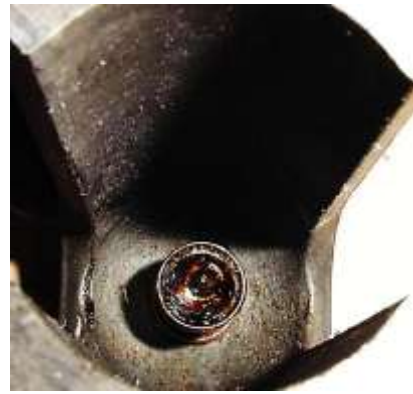
Bild 12.13: Axiallager: a) Lagerpfanne am Wellenende, b) Konstruktive Vereinigung von Axiallager und Kabelanschlussbolzen, c) Sitz der Kugel des Axiallagers
