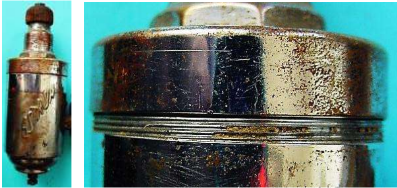
Bild 4.4: Feingewinde zur Verschraubung von Lagerhals und Gehäusetopf
