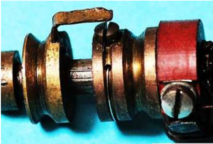
Bild 3.9: Ringförmige Drahtfeder des Fliehkraftschalters
