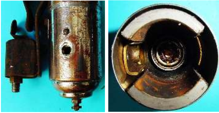
Bild 4.11: Befestigung der Kippvorrichtung am Gehäuse: a) Kippvorrichtung und Dynamokörper, b) Position des Blechs in der Pollücke, c) Eingeschraubter Drehbolzen
