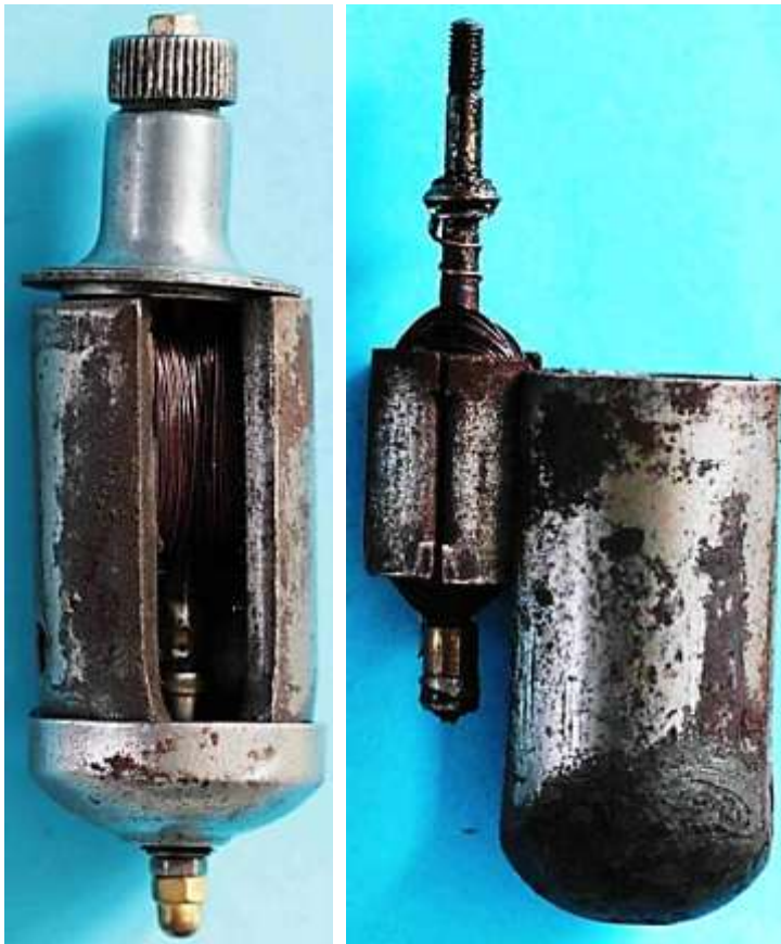
Bild 7.3: Generatorbauteile: a) Entfernter Gehäusemantel, b) Anker und Tulpenmagnet.
