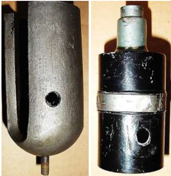
Bild 12.7: Gewindebohrung im Magnetschenkel und Bohrung im Gehäusemantel
