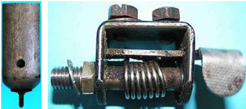
Bild 2.8: Im Magneten eingeschraubter Drehbolzen
