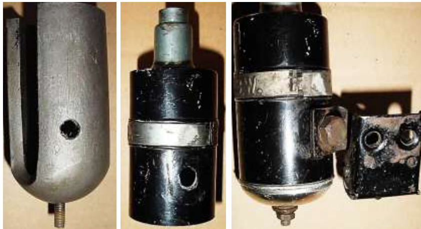
Bild 2.10: Befestigung der Kippvorrichtung mit einem Gewindebolzen a) Magnet mit Gewinde- loch, b) Gehäusemantel mit Bohrung c) Angeschraubtes Flanschblech
