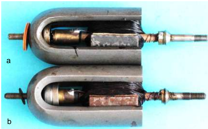
Bild 6.5: Vergleich der Magnetlängen: a) Astron 2 b) Astron 4
