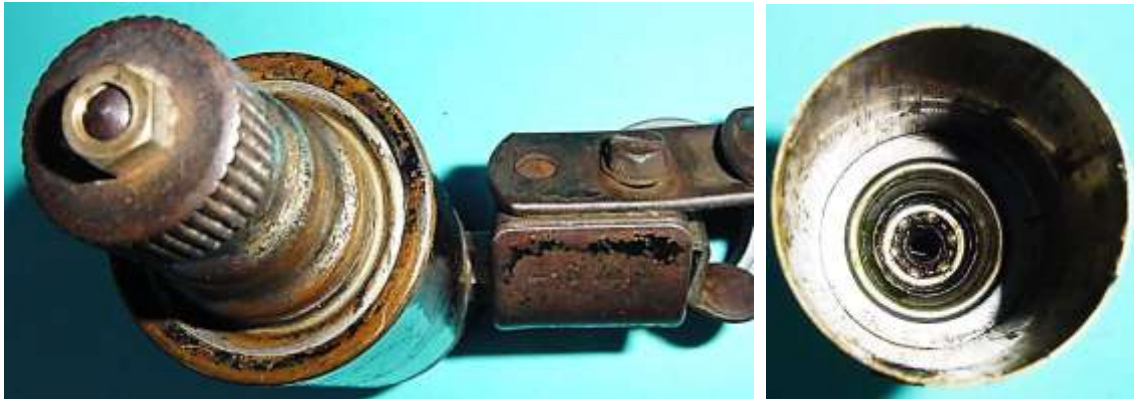
Bild 8.6: Lagerhals und Gehäusemantel
