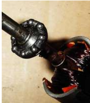
Bild 12.12: Oberes Kugellager: a) Kugellager im Lagerhals, b) Kugellager auf der Welle
