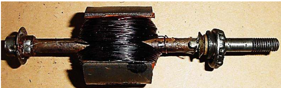
Bild 12.11: Läufer mit Anker und den Lötkontakten
