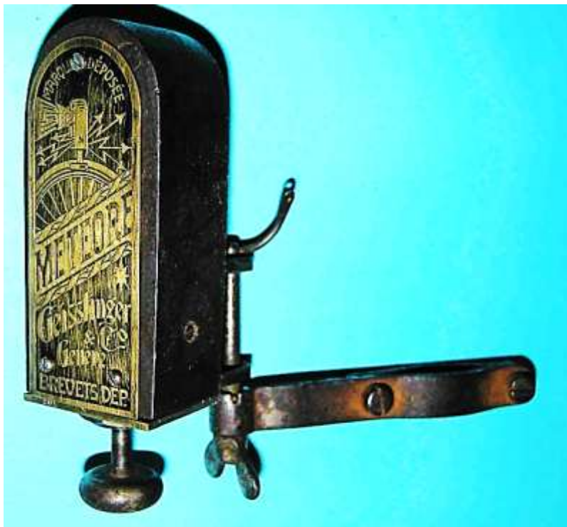
Bild 1.9: Frontansicht des Hufeisenmagnet-Dynamos von Geisslinger & Co
