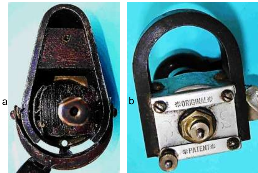
Bild 1.2: Ankerachse steht senkrecht auf der vom Magneten aufgespannten Fläche a) Voltalite b) System Schmidt (Berko)
