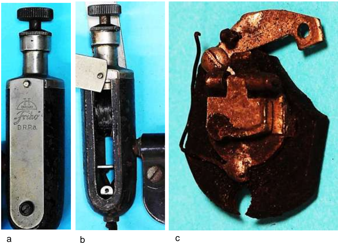
Bild 1.19: Friho mit Fliehkraftschalter: a) Position des Pollückenblechs, b) Freier Bau- raum für den Fliehkraftregler zwischen Anker und Magnetjoch, c) Reste des Flieh- kraftschalters
