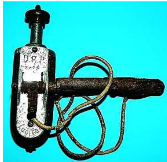
Bild 1.12: Dynamos mit dem Pollückenblech als Basis für die Kippvorrichtung: a) „Dynalite“, Englische Ausführung mit Schmierbüchse im Lagerhals, b) Vorliegendes Exemplar ohne Schmierbüchse im Lagerhals
