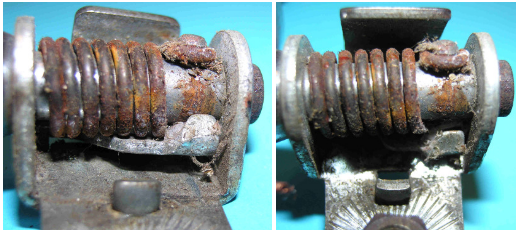
Bild 1.11: Veränderung der relativen Lage von Sperrstift und Fußhebel: a) Ruhestellung, b) Betriebsstellung
