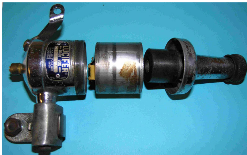
Bild 1.12: Baugruppen des Dynamos: a) Gehäusetopf mit Kippeinrichtung, Kabelanschluss und Lampenarm, b) Ankerjoch, c) Walzenmagnet, Durchmesser 24 mm, axiale Länge 20 mm
