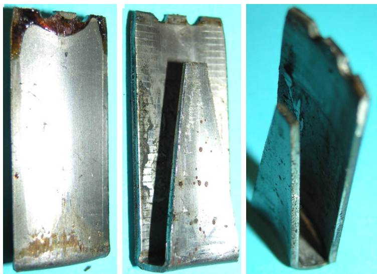
Bild 1.15: Polelement: a) Fläche für den Übergang des magnetischen Flusses zum Joch, b) Trapezförmige Polfläche, c) Wickelraum
