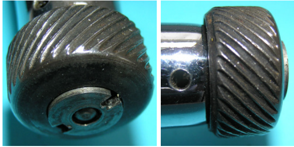
Bild 1.6: Reibrad in Vorgängervarianten ohne Schleuderkante
