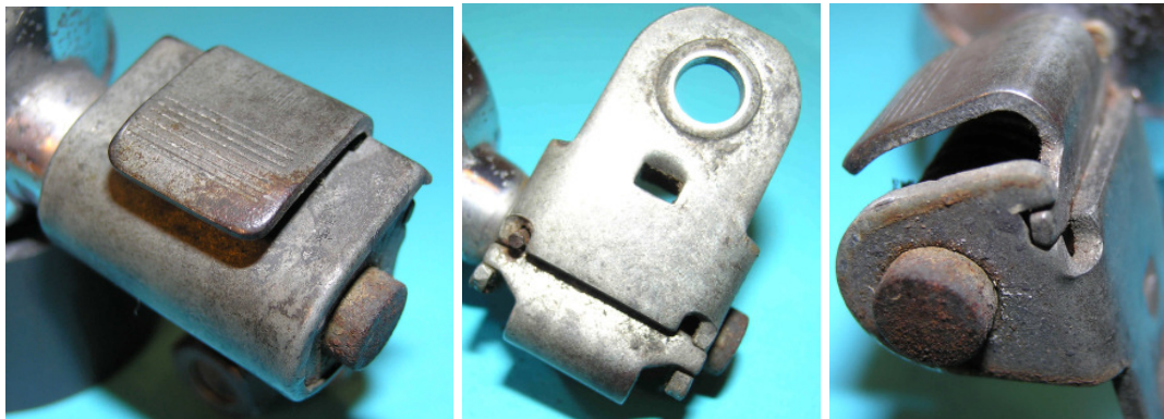
Bild 1.10: Kippvorrichtung mit Fußhebel: a) Fußhebel, b) und c) Lagerung des Fußhebels im Basisblech
