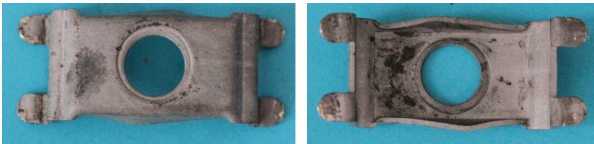
Bild 3.13: Kontaktsteg mit zentraler Bohrung und Befestigungslaschen
