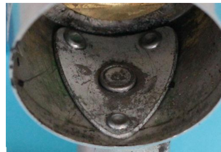
Bild 2.36: Zusammenfügen der Gehäuseteile: a) Lagerhals mit zweiteiligem Gleitlager, b) Lagerhalsrand mit Nut, c) Flansch innerhalb des Gehäusetopfes
