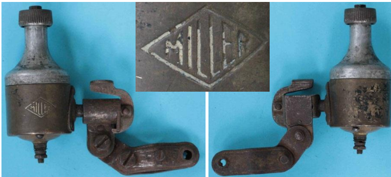
Bild 2.12: Dynamo mit dreieckförmigem Flansch
