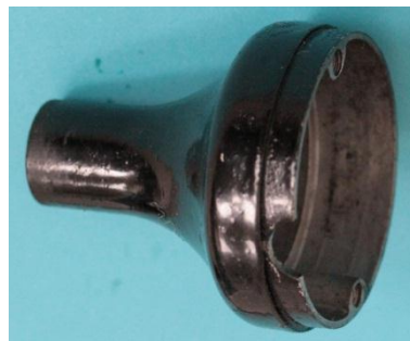
Bild 2.36: Zusammenfügen der Gehäuseteile: a) Lagerhals mit zweiteiligem Gleitlager, b) Lagerhalsrand mit Nut, c) Flansch innerhalb des Gehäusetopfes
