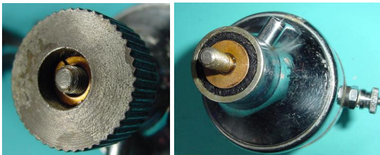
Bild 4.8: Reibrad und Ankerwelle mit Gewinde
