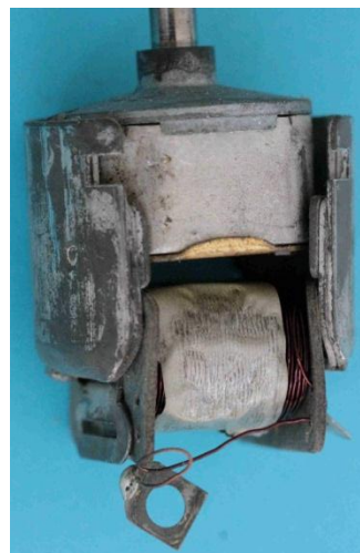
Bild 3.12: Generator: a) Polschuhe im Lagerhalsfuß eingeklinkt, b) Anker und Polrad ohne Lagerhals
