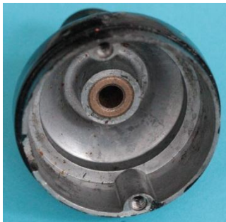
Bild 2.36: Zusammenfügen der Gehäuseteile: a) Lagerhals mit zweiteiligem Gleitlager, b) Lagerhalsrand mit Nut, c) Flansch innerhalb des Gehäusetopfes
