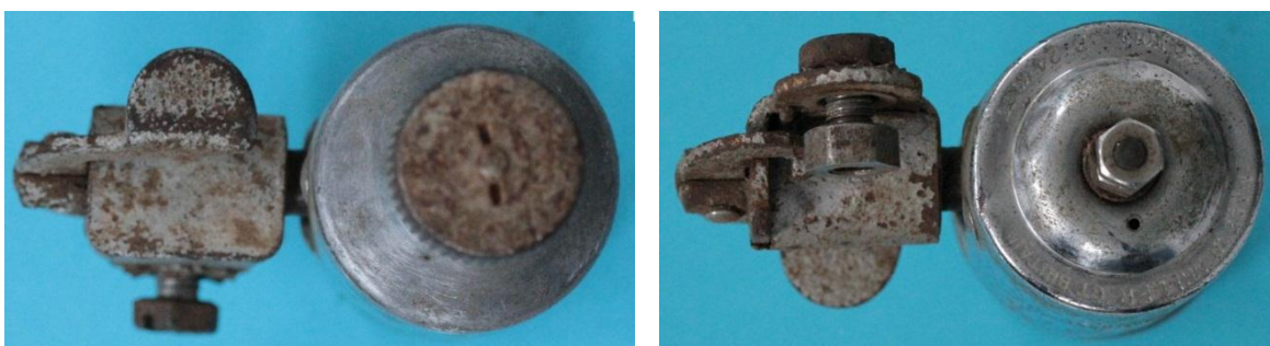
Bild 3.2: Ansichten von oben und unten: a) Reibrad, b) Boden mit Lüftungsloch
