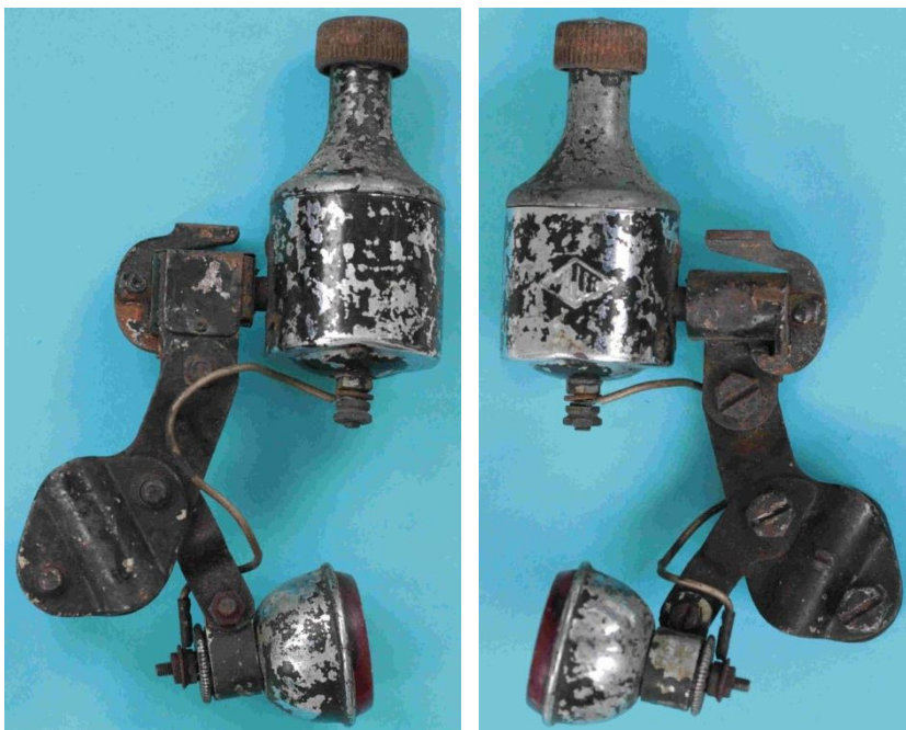
Bild 2.7: Dynamo mit Rücklicht
