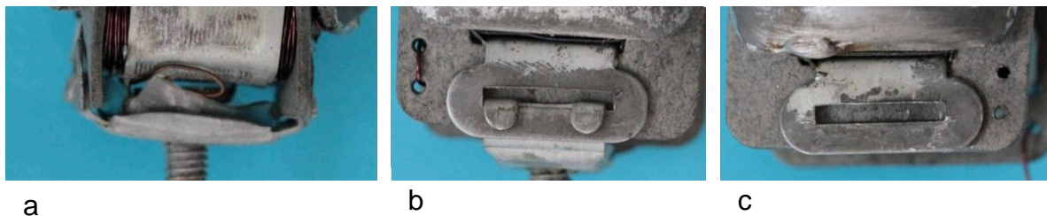
Bild 3.14: Befestigung des Kontaktstegs: a) Überbrückung der Ankerspule mit dem Kontaktsteg, b) Halblech mit eingeklinktem Kontaktsteg, c) Schlitz des Halblechs
