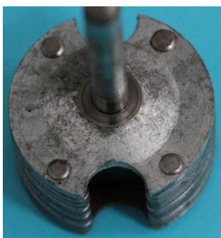
Bild 2.37: Polrad: a) Wellenteller mit Welle, b) Blockmagnet mit geblechten Polschuh, c) Befestigung der Welle am Wellenteller
