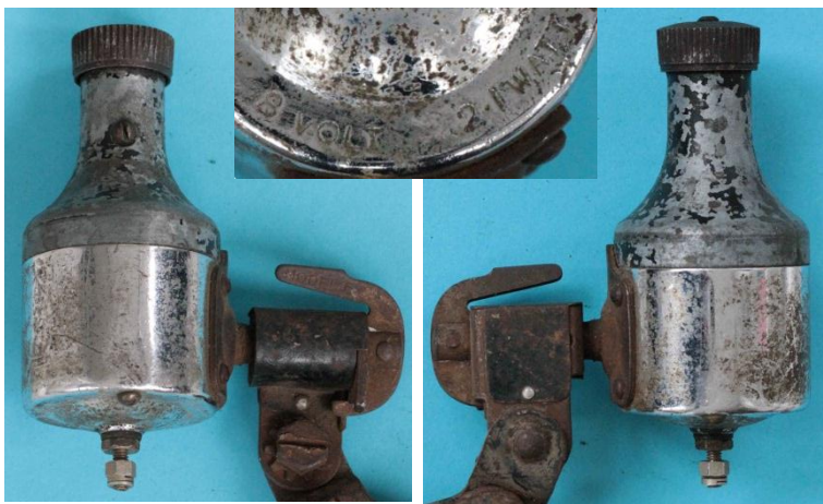
Bild 2.28: Dynamo mit massiven Ankerpolblechen
