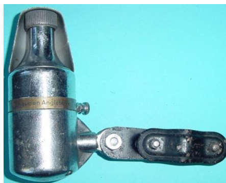
Bild 2.2: Dynamos mit integrierter Kippvorrichtung:
