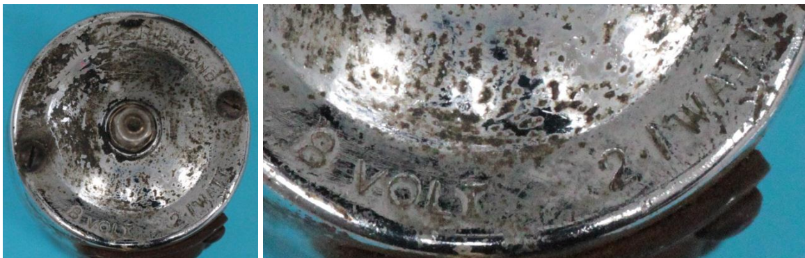
Bild 2.29: Beschriftung des Bodens mit den Nenndaten 8 V und 2,1 W
