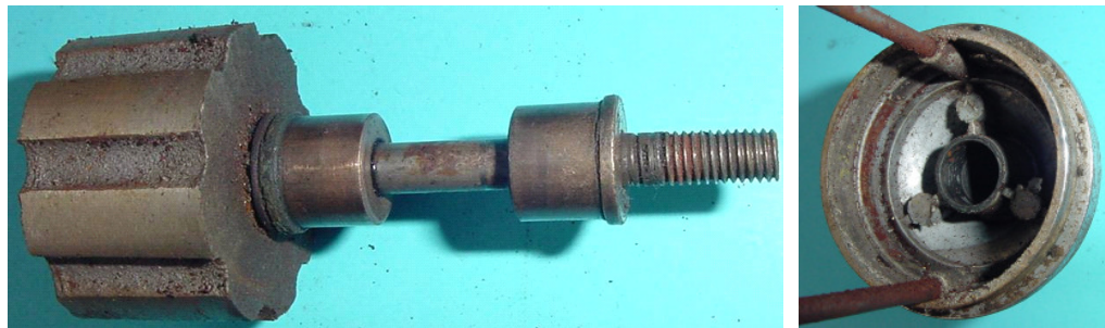
Bild 1.7: Lagerung des Polrads
