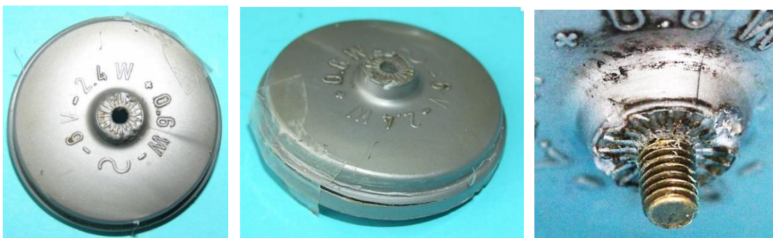
Bild 8.2: Boden mit den Nenndaten: 2,4 W+0,6 W
