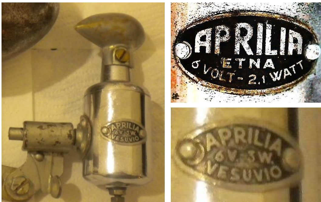
Bild 4.1: Typ Aprilia Vesuvio, Vergleich des Leistungsschildes mit dem des Typs ETNA
