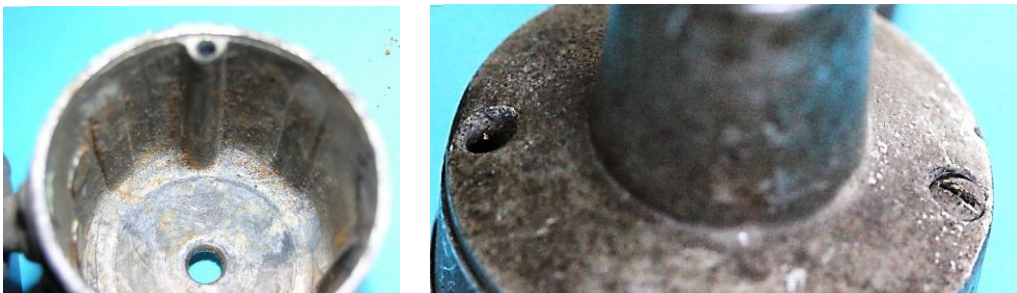
Bild 5.2: Schraubverbindung der Gehäuseteile
