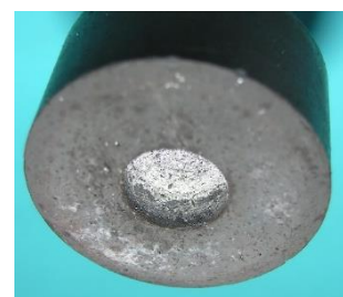
Bild 6.15: Polrad: a) Sitz der Anlaufkappe, b) Anlaufkappe, c) Obere Stirnseite des Magneten, d) Untere Stirnseite des Magneten
