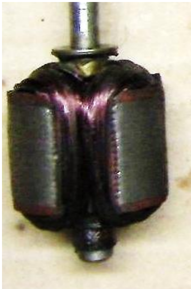
Bild 2.4: Generator: a) Anker mit 14 Blechen im Ankereisen, b) Magnetsystem mit vier Magnetstahlsegmenten
