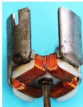
Bild 1.7: Anker Ausführungen der Generatoren mit rotierenden Magneten: a) und b) Typenbezeichnung RIO, c) Typenbezeichnung „chig“
