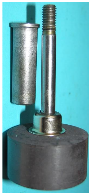
Bild 6.17: Stahlsinterlager: 28 mm lang, Bohrung 5 mm, Wandstärke 1,5 mm
