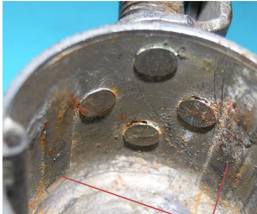
Bild 5.10: Gestaltung der Gehäusetopfwand zum sicheren Einsetzen des Ankers: a) Innenwand des Gehäusetopfes mit Gleitschienen und Nietköpfen, b) Luftspalte zwischen den Ankerpolen und der Gehäuseinnenwand
