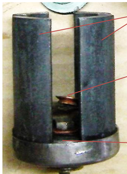
Bild 2.4: Generator: a) Anker mit 14 Blechen im Ankereisen, b) Magnetsystem mit vier Magnetstahlsegmenten
