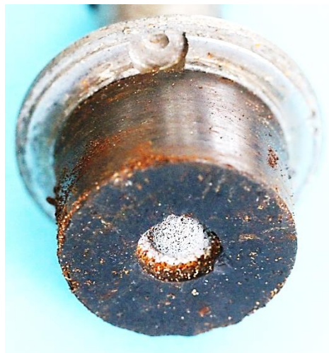
Bild 5.6: Polrad mit eingegossener Welle: Durchmesser 27,5 mm; Länge 16 mm
