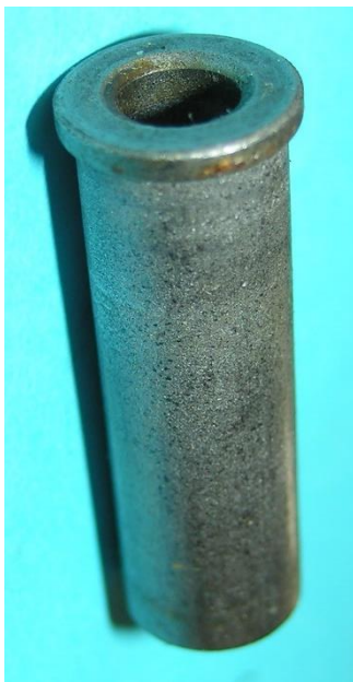
Bild 6.17: Stahlsinterlager: 28 mm lang, Bohrung 5 mm, Wandstärke 1,5 mm
