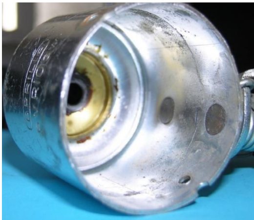
Bild 6.4: Befestigung des Flansches mit zwei Nieten, deren Köpfe mit der Gehäuseoberfläche übereinstimmen
