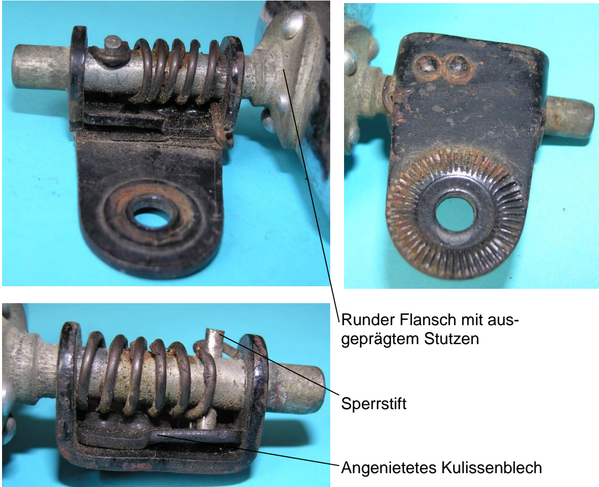
Bild 3.6: Kippvorrichtung mit angenietetem Kulissenblech
