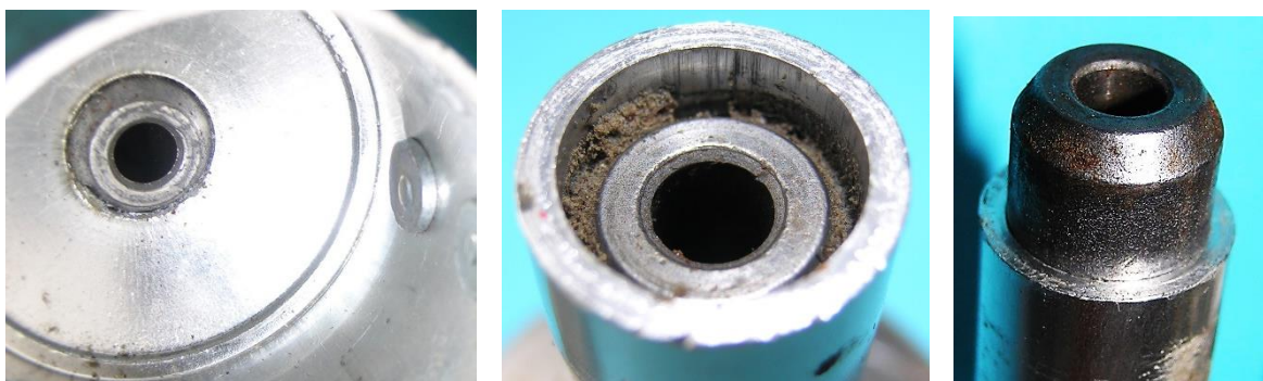
Bild 7.7: Gleitlager: 30 mm lang, 3,5 mm Wandstärke: a) Untere Stirnseite, b) Obere Stirnseite, c) Herausgeschobenes Lagerrohr
