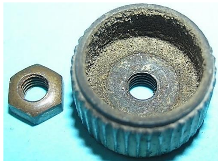
Bild 3.4: Reibrad in Form einer Kappe
