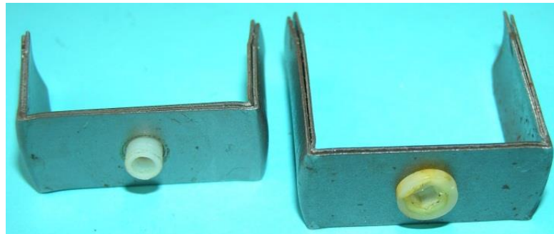
Bild 8.12: Einzelteile des Ankereisens: Spulenkern, kurze Gabel, Lange Gabel
