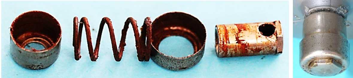
Bild 8.3: Federklemme: Zwei Endkappen, Schraubenfeder, Hutmutter mit Querbohrung
