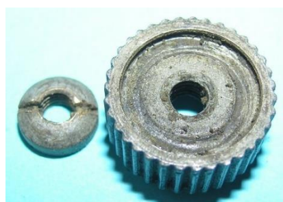
Bild 3.5: Reibrad mit versenkbarer Schlitzmutter
