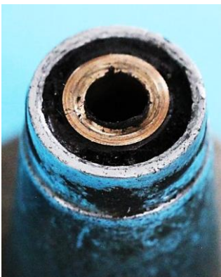
Bild 5.7: Lagerung des Polrades: a) Unteres Gleitlager im Lagerhalsfuß, b) Oberes Gleitlager
