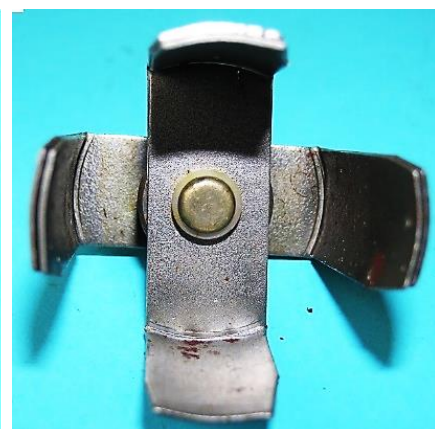
Bild 8.12: Einzelteile des Ankereisens: Spulenkern, kurze Gabel, Lange Gabel
