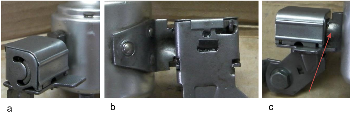
Bild 9.3: Kippvorrichtung mit Kombiflansch: a) b) Flansch und Rückseite der Kippvorrichtung, c) Übergang vom Flansch zum Drehbolzen
