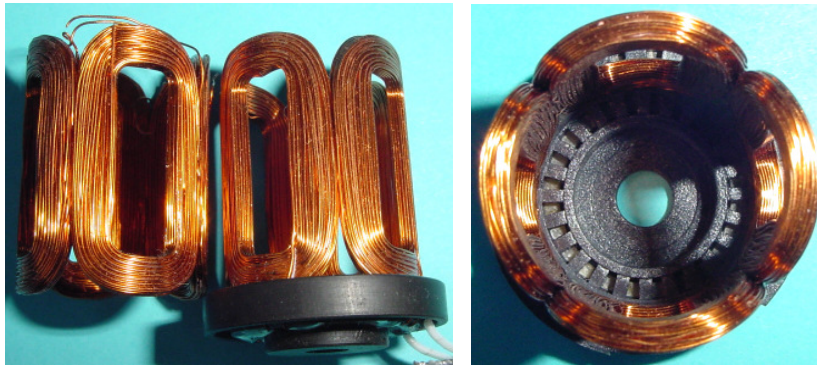
Bild 1.16: Ankerwicklung mit angespritztem Lager-schild
