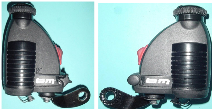
Bild 1.1: Dymotec mit feststehendem Ankerjoch
