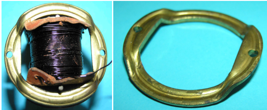
Bild 1.5: Ring zur Verdrehsicherung des Ankers
