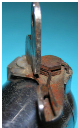
Bild 2.2: Kippvorrichtung mit sichtbarer Rückhaltefeder
