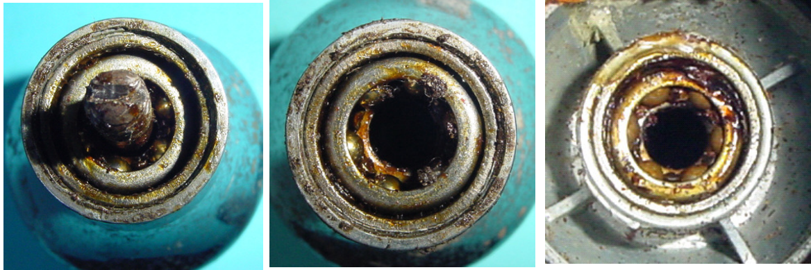
Bild 2.7: Lagerung: a) Welle mit Lager, b) Lager unter dem Reibrad, c) Unteres Lager
