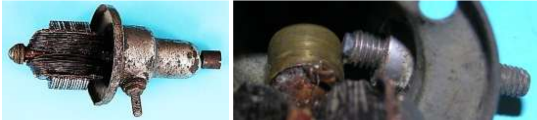
Bild 4.9: Spannung führender Kontakt: a) Kabelanschlussbolzen, b) Schleifring und Bürste
