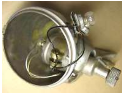
Bild 3.2: Position des Dynamos a) Dynamo im Lampenfuß, b) Auf dem Lampenfuß montier- tes Lampengehäuse
