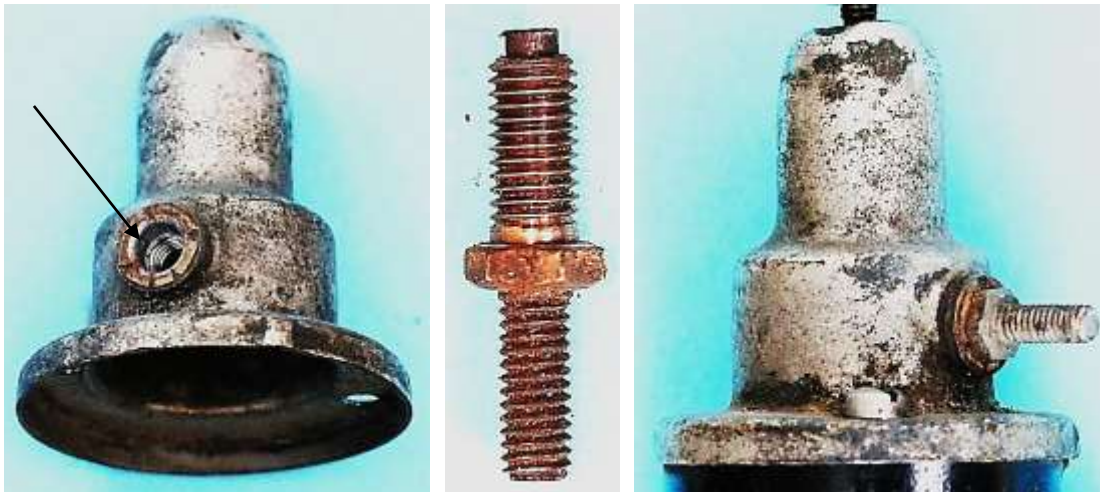
Bild 4.10: Lagerhals: a) Bohrung für den Spannung führenden Bürstenhalter, b) Kabelanschlussbolzen in Kombination mit dem Bürstenhalter, c) Eingeschraubter Bürstenhalter
