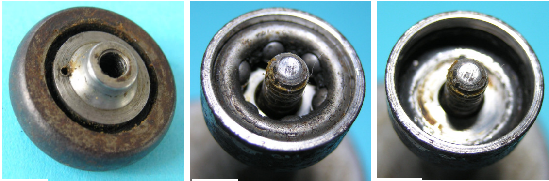
Bild 1.12: Oberes Kugellager: a) Reibrad mit Lagerkonus, b) Eingesetztes Kugellager, c) Lagerschale mit Wellenende
