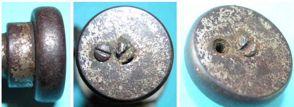
Bild 1.14: Reibrad: a) Lauffläche des Reibrads und Lagerschale, b) Reibrad mit Konterschraube und Ölkanalverschluss, c) Offener Ölkanal
