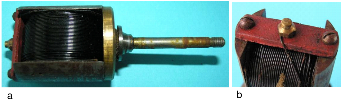
Bild 1.10: Anker (Pollänge 27,2 mm, Durchmesser 26,2 mm): a) Doppel-T-Anker mit Welle, b) Isoliersteg mit Schleifkontakt
