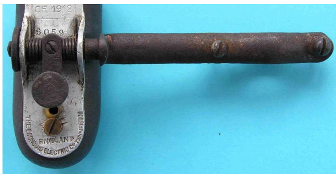
Bild 1.7: Starre Verbindung von Halter und Drehbolzen
