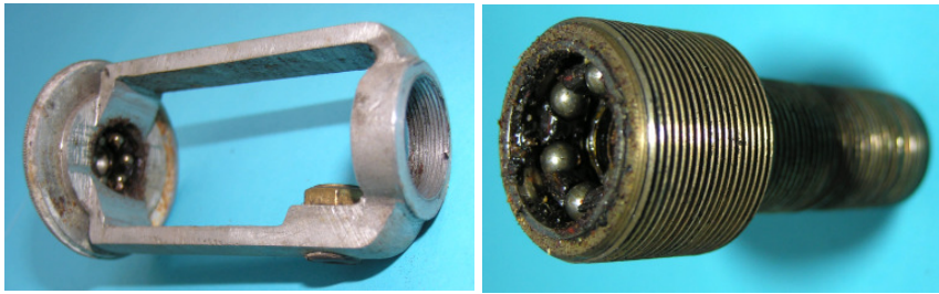
Bild 1.11: Rahmen mit zwei Kugellagern
