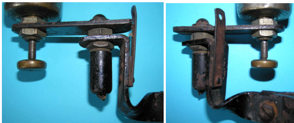
Bild 1.20: Arretierungsfeder: a) Ruhestellung b) Betriebsstellung
