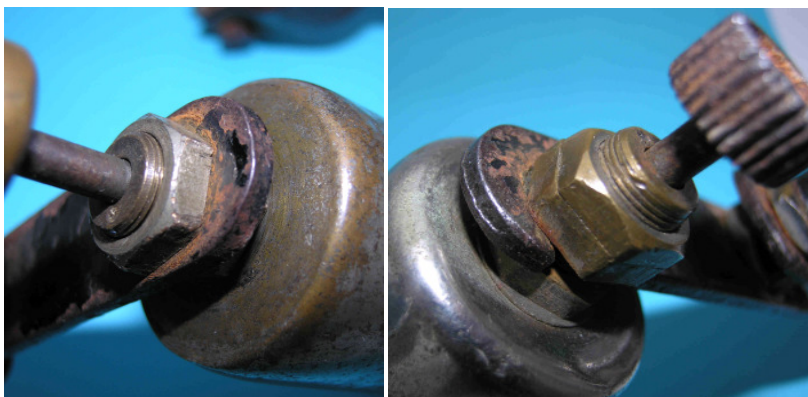
Bild 1.8: Befestigung der Drehvorrichtung am Dynamo
