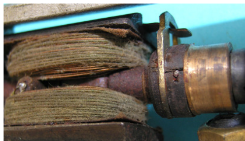
Bild 1.26: Gegenkontakt, der mit einer Wicklungsanzapfung verbunden ist
