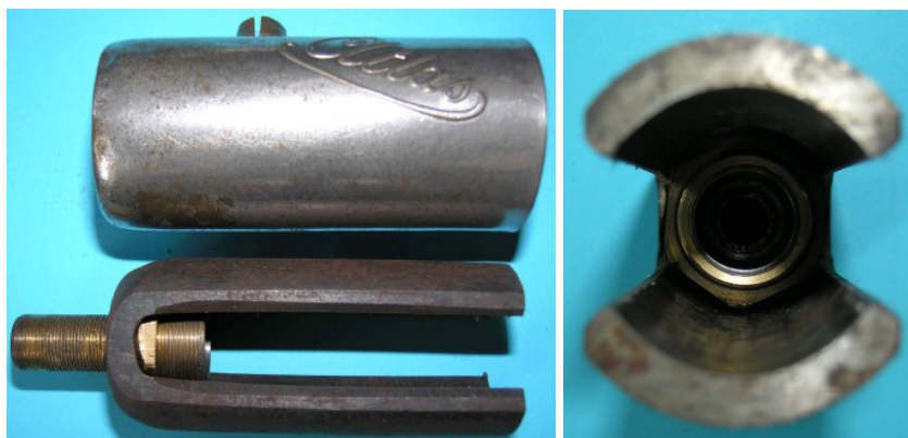
Bild 1.18: Magnet mit der Gewindehülse im Joch (4,5 mm Wandstärke)
