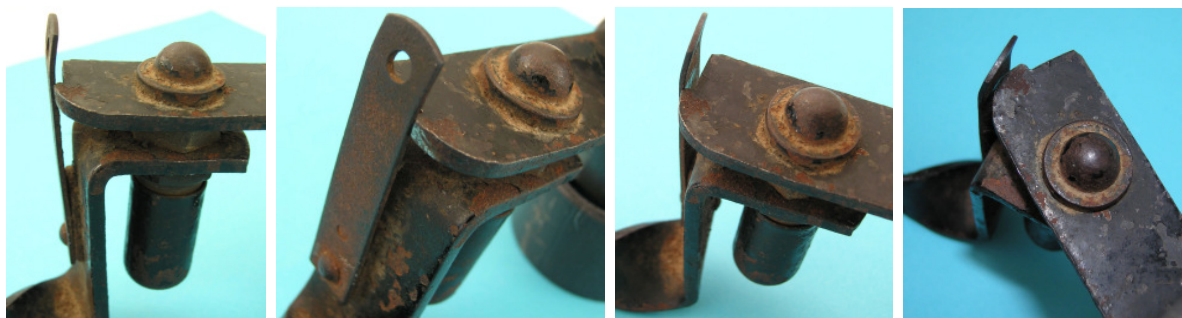
Bild 1.21: Blattfeder zur Arretierung des Dynamos in der Ruhelage: a) Blattfeder und Dreheinrichtung, b) Am Halter angenietete Blattfeder, c) Ruhestellung, d) Betriebsstellung
