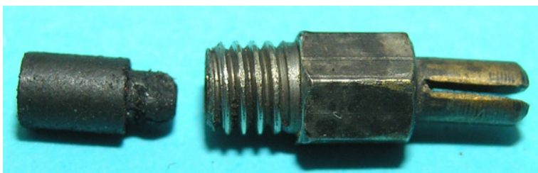
Bild 1.16: Kohlebürste und die Kombination Bürstenhalter und Stecker
