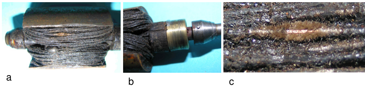
Bild 1.14: Kontaktierung der Ankerwicklung: a) Massekontakt, b) Anschluss am Schleifring, c) Sichtbare Seidenumspinnung
