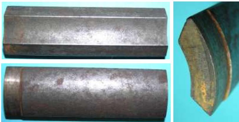
Bild 6.10: Bearbeiteter Abschnitt zur Einpassung in die Ringnut des Jochs
