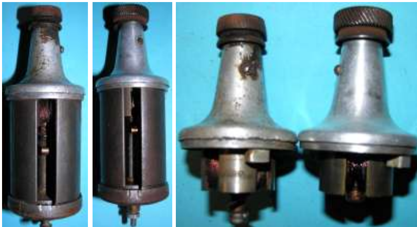
Bild 5.23: Verkürzung der Ankerachse im WGD, a) WGC b) WGD
