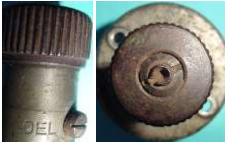
Bild 4.3: Ölschraube am Lagerhals und Schlitzmutter zur Befestigung des Reibrades
