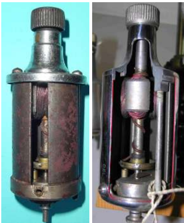
Bild 6.3: Aufbau der WH-Typen: a) WH ohne Gehausekopf, b) WHB als Schnittmodell
