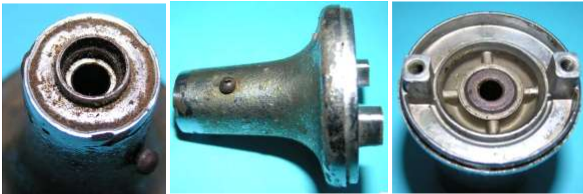
Bild 6.18: Gleitlager im Lagerhals (WHC)
