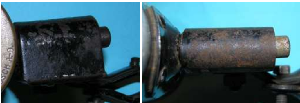
Bild 5.29: Reduzierung der Abmessungen der Kippeinrichtung beim WGD-Dynamo: a) WG,WGB und WGC, b) WGD
