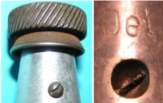
Bild 5.9: Ölbohrung am Lagerhals
