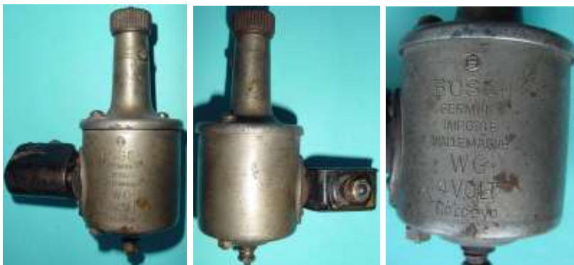
Bild 4.5: Konturen und Beschriftung des Bosch-Dynamos WG mit der Nennspannung 4 V
