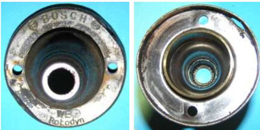
Bild 3.4: Lagerhals: a) Oberfläche, b) Innenansicht mit Lagerhülse
