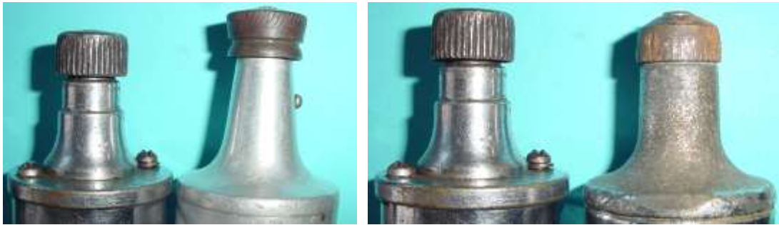
Bild 6.2: Vergleich der Lagerhuse: a) Verkurzter Lagerhals beim WH im Vergleich mit WGD, b) Lagerhuse von WH und WHA
