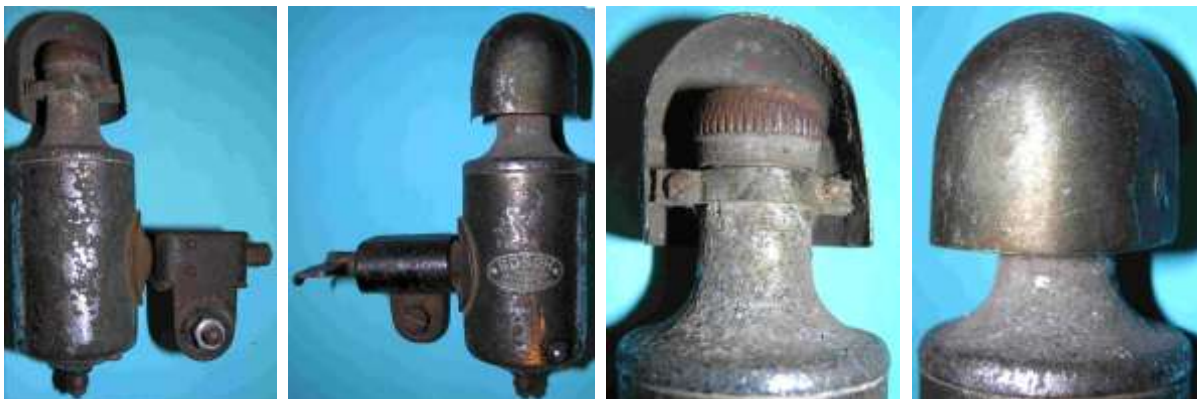
Bild 6.21: Original Bosch-Kotschutz am WHB
