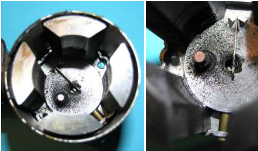
Bild 2.6: Schleifkontakte und Spurlager
