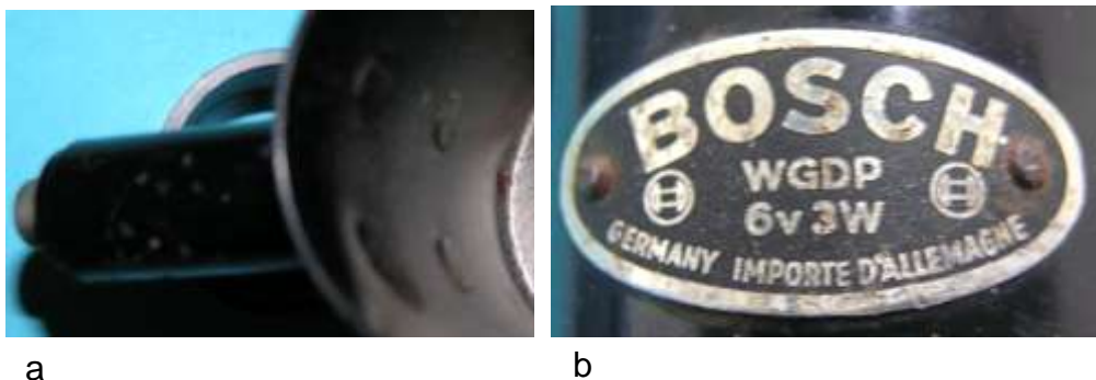
Bild 5.15: Änderungen am Gehäuse im Vergleich zur WG-Ausführung: a) Nietköpfe im Aluminiumgehäuse, b) Firmenschild mit Typenbezeichnung und Nenndaten
