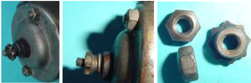
Bild 4.4: „Designermuttern“ zur Verschraubung der Gehäuseteile und für den Kabelanschluss
