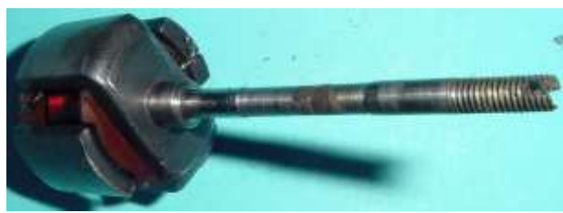
Bild 4.10: Dynamo ohne Gehäusetopf, Anker mit U-Flussleitstücken
