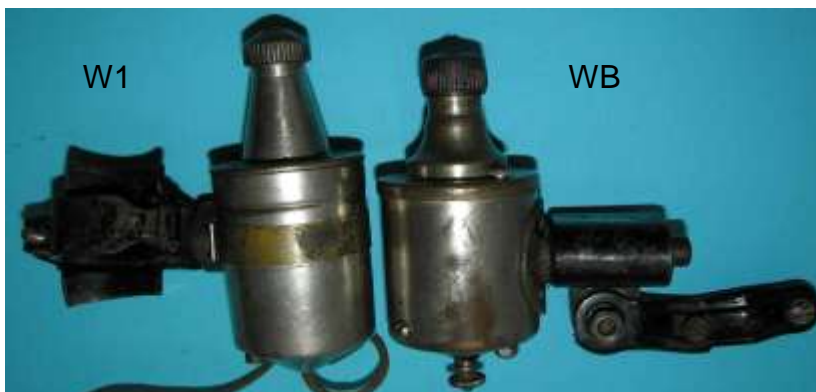
Bild 1.2: Entwicklungssprung von W1 zu WB
