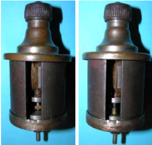
Bild 1.18: Blick durch die Pollücken auf die Schleifkontakte
