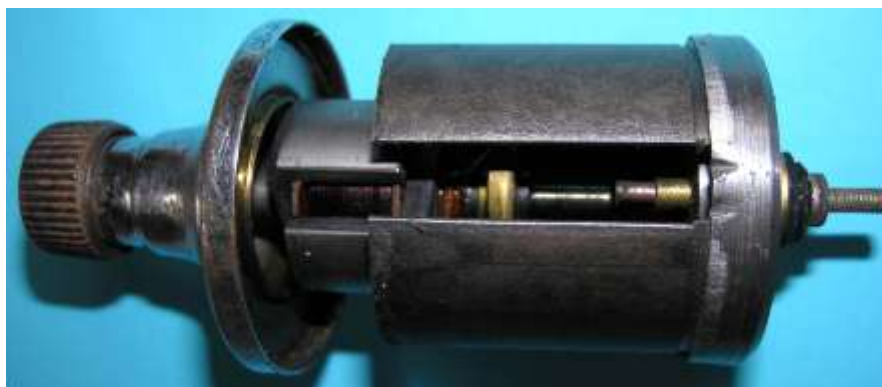
Bild 2.8: WDS1 ohne Gehäusekopf mit herausgezogenem Klauenpolanker
