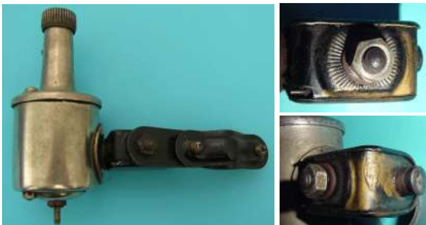
Bild 4.18: Schraubverbindung zur Befestigung des Halters
