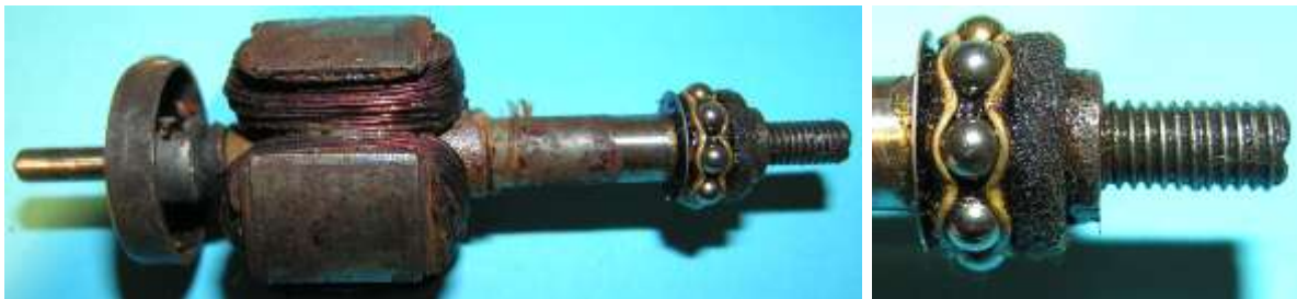
Bild 3.3: Läufer: a) Anker mit Schleifteller und Welle, b) Festes Kugellager
