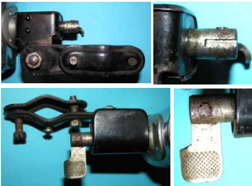
Bild 6.5: Fußbedienung der Kippvorrichtung
