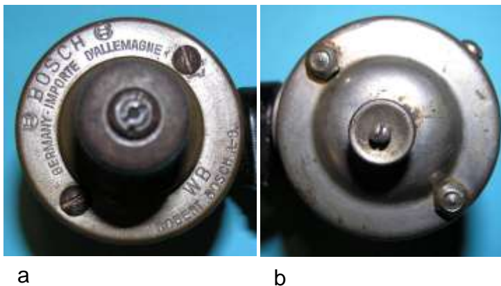
Bild 1.4: Ansichten von oben und von unten a) Reibrad und Lagerhalsfuß, b) Kabelanschluss und Boden
