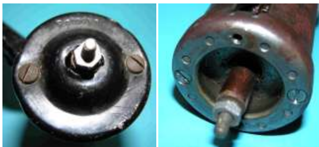
Bild 5.14: Befestigung des Gehäusetopfes am Joch mit zwei Schlitzschrauben
