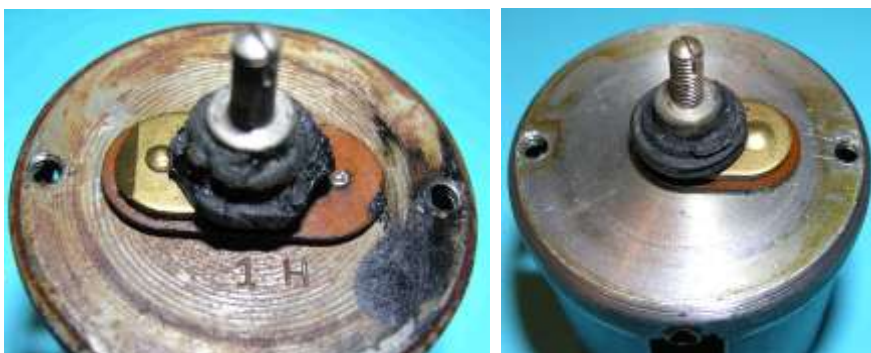
Bild 2.7: Spannung führender Kontakt unter dem Joch: a) WB, b) WDS1
