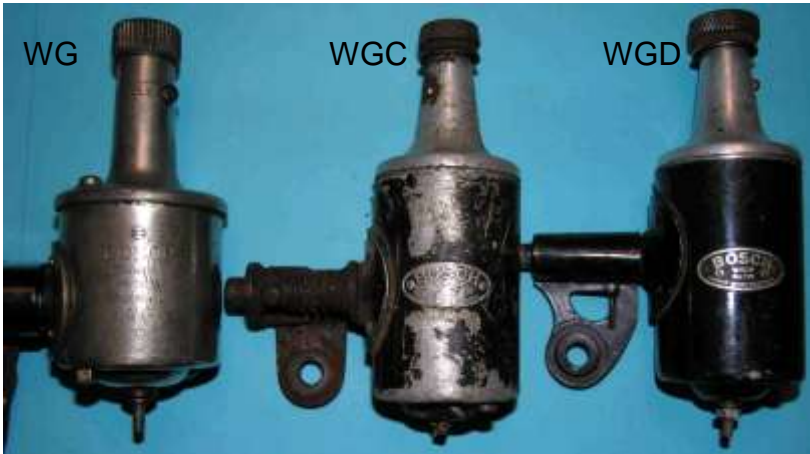
Bild 5.4: Drei WG-Bauformen (freifliegende Lagerung)
