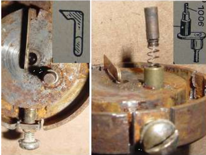
Bild 6.12: Schleifkontakte: a) Blattfeder für die Masseverbindung, b) Spannung führende Bürste mit Schraubenfeder
