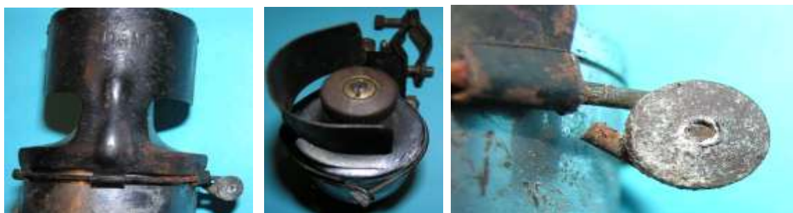
Bild 6.23: Dynamo WHA mit Spritzschutz
