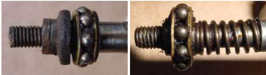
Bild 6.16: Lager im Lagerhals mit Abdichtring und Axialdruckfeder beim WH
