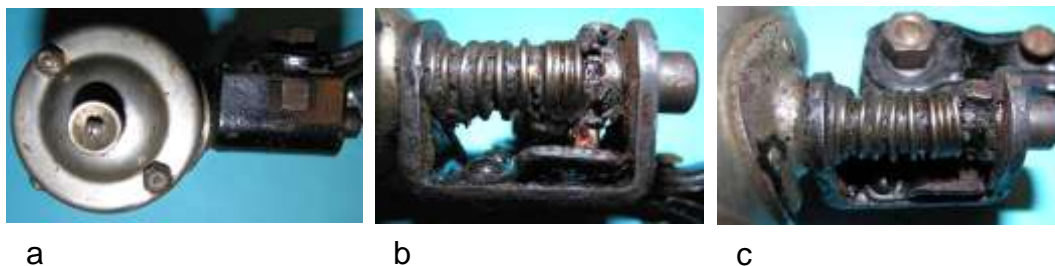
Bild 1.6: Kippvorrichtung: a) Abdeckung, b) und c) Positionierblech, Schraubenfeder und Sperrstift bei den zwei Stellungen des Dynamos
