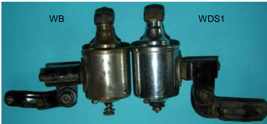
Bild 2.2: Vergleich der Dynamotypen WDS1 und WB
