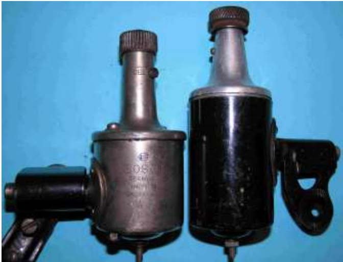
Bild 5.6: Unmittelbarer Größenvergleich der Bauformen WG und WGD
