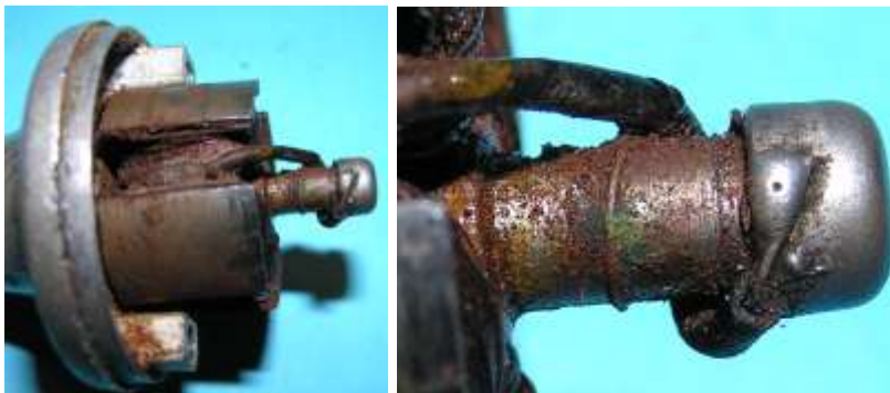
Bild 5.24: Kontaktierung der Spulenenden
