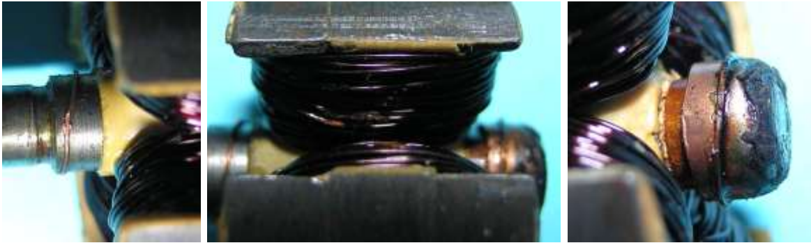
Bild 6.17: Kontaktierung auf beiden Seiten des Ankers beim WHC
