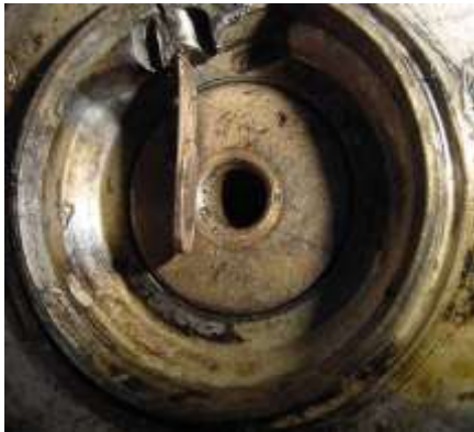
Bild 4.17: Blattfeder im Lagerhalsfuß zur elektrischen Überbrückung des Gleitlagers
