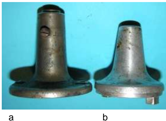
Bild 5.8: Reduzierung der Lagerhalslänge: a) WG, b) WGA, WGB, WGC und WGD
