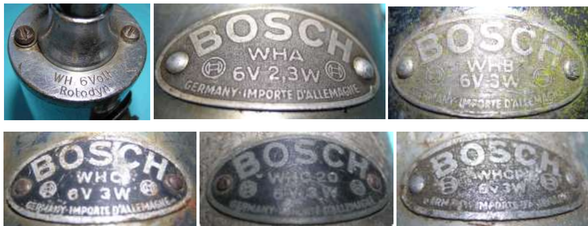
Bild 6.8: Leistungsschilder der Typen WH, WHA, WHB, WHC, WHC 20 und WHCP
