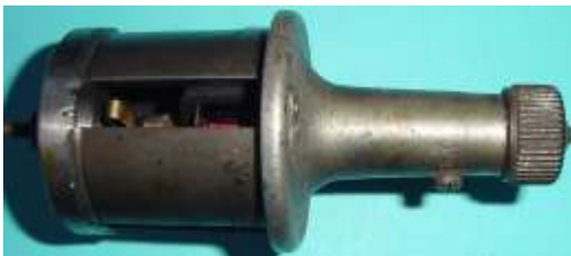
Bild 4.10: Dynamo ohne Gehäusetopf, Anker mit U-Flussleitstücken
