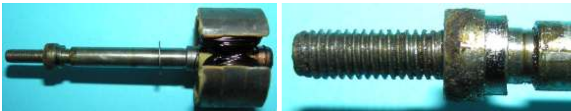
Bild 6.19: Abdichtung des Öldepots mit einem Konus
