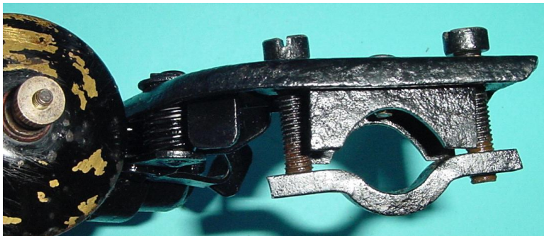
Bild 1.4: Kippvorrichtung mit integriertem Halter
