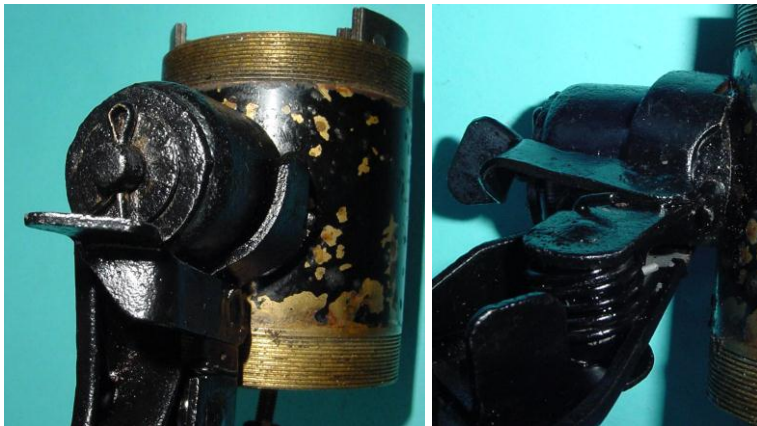
Bild 1.3: Fußhebel und Arretierungsfeder
