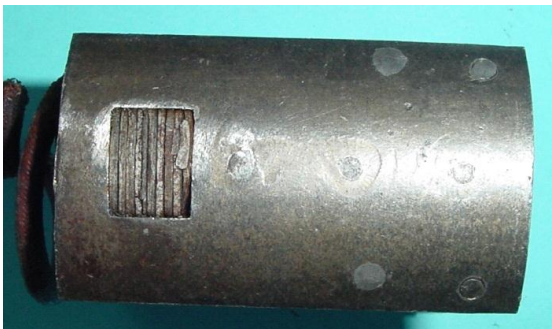
Bild 1.9: Verknüpfungspunkte der Polbleche
