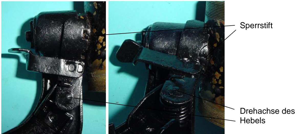
Bild 1.5: Hebel zur Ver- und Entriegelung des Dynamos
