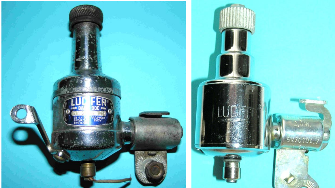
Bild 7.2: Beschriftungen des Baby 900 und des Lucifer-Blätterpoldynamo
