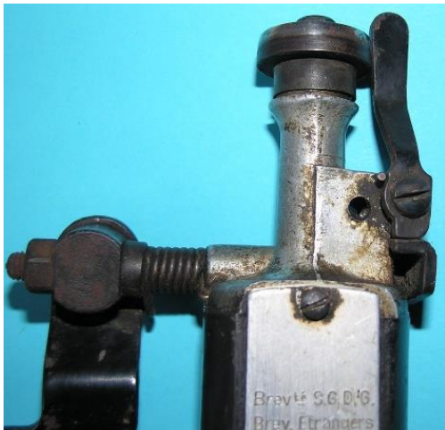
Bild 3.110: Hebelstellungen: a) Ruhestellung, b) Betriebsstellung und Beschriftung des hinteren Pollückenblechs
