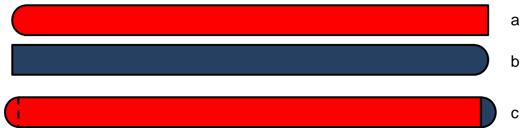
Bild 4.14: Ankerbleche (0,5 mm dick, 7 mm breit und 110 mm lang): a) Blech mit einer runden und einer geraden Schmalseite, b) Gedrehtes Ankerblech von a), c) Übereinander gelegte Bleche
