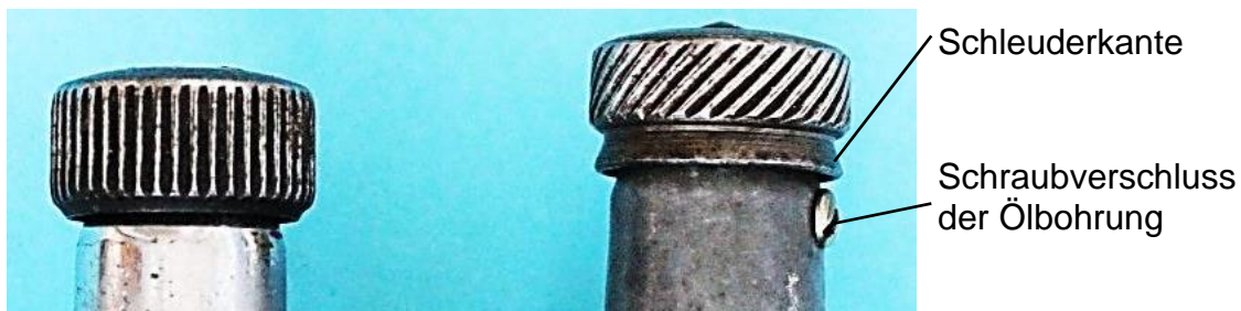
Bild 5.13: Veränderungen am Reibrad: a) Lucifer Baby 210166, b) Lucifer-Baby 700 B 727039
