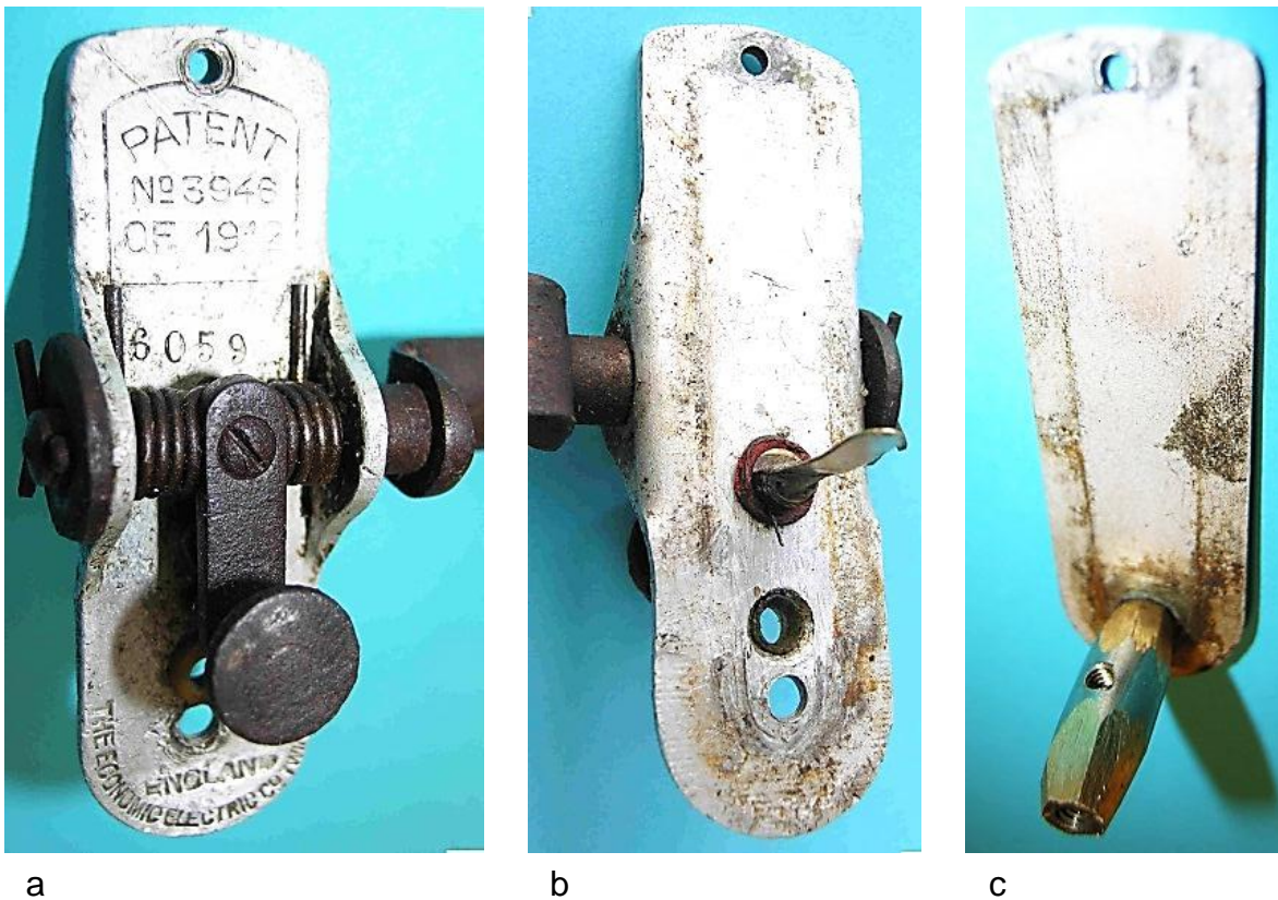
Bild 3.45: Pollückenbleche: a) Pollückenblech mit Kippvorrichtung und Beschriftung, b) Innenseite mit Kontaktfeder und Kabeldurchführung, c) Zweites Pollückenblech mit Verbindungselement
