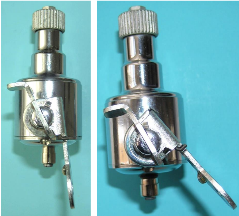
Bild 7.18: Stellungen des Dynamokörpers: a) Ruhestellung, b) Betriebsstellung
