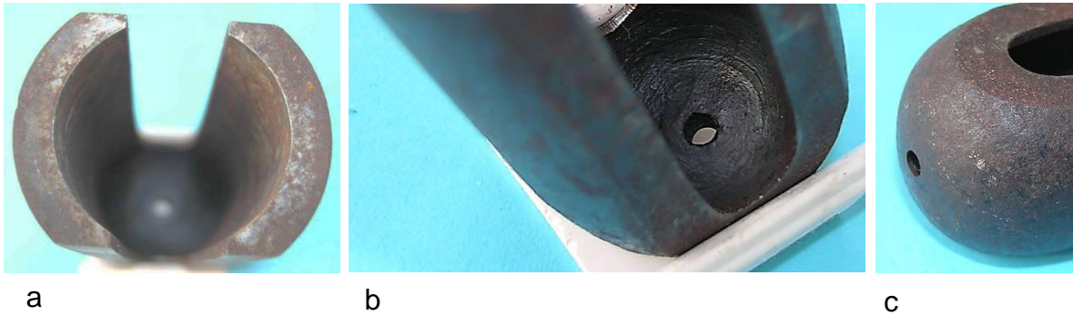
Bild 3.44: Tulpenmagnet: a) Gekrümmte Polflächen, b) Innenansicht des Jochs mit Bohrung für die Kabeldurchführung, c) Außenansicht des Jochs
