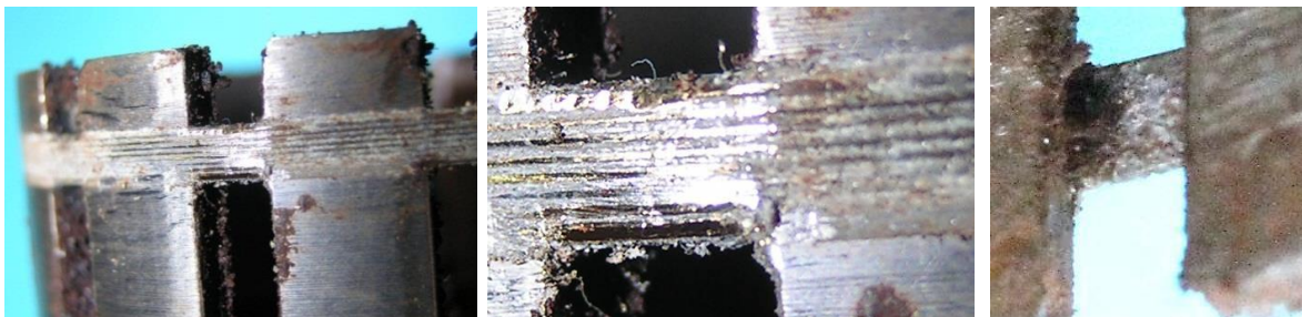
Bild 4.54: Verzinnete Kupferdrahtbandage: a) In Nuten eingelegte Drahtbandage, b) Verzinnete Windungen, c) Ansicht der Bandage von innen
