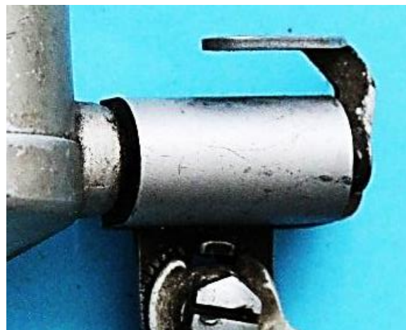
Bild 5.15: Weiterentwicklung der Kippvorrichtung durch die Anbringung eines Bedienungshebels: a) Lucifer Baby C 321 139, b) Lucifer Baby 700 F 305 718
