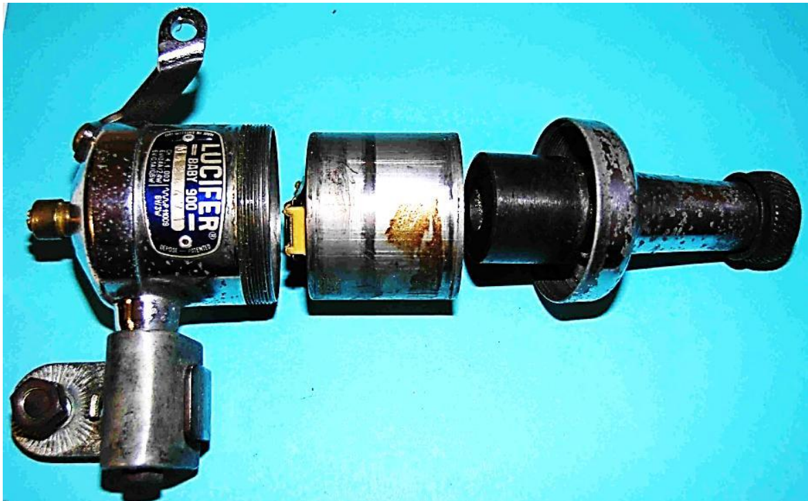
Bild 6.24: Baugruppen des Dynamos: a) Gehäusetopf mit Kippeinrichtung, Kabelanschluss und Lampenarm, b) Ankerjoch, c) Walzenmagnet, Durchmesser 24 mm, axiale Länge 20 mm
