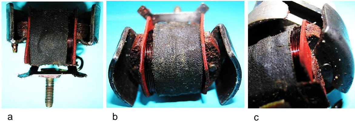
Bild 5.66: Positionierung der Polradpolschuhe zwischen den Ankerpolflächen
