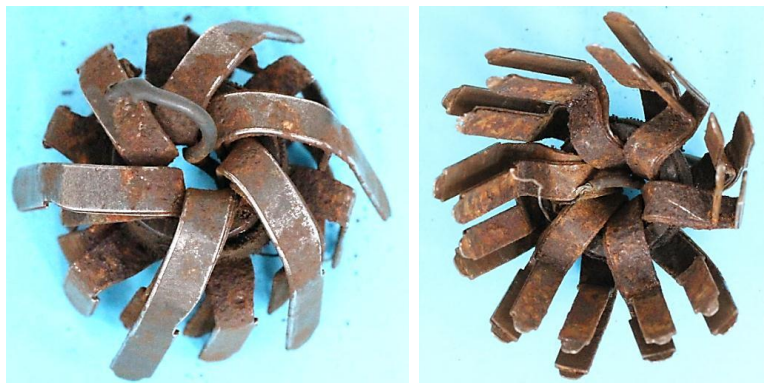
Bild 4.17: Anker mit den separaten Klauenpolpaaren a) Ansicht der Joche, b) Ansicht des Montage- raums
