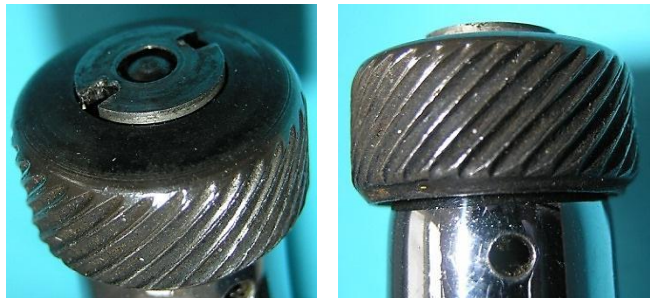
Bild 6.15: Reibrad in Vorgängervarianten ohne Schleuderkante
