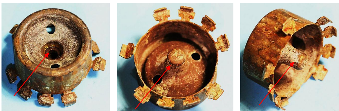
Bild 4.18: Montagezylinder: a) Kalottenlagerseite, b) und c) Unterseite mit Lagerdom
