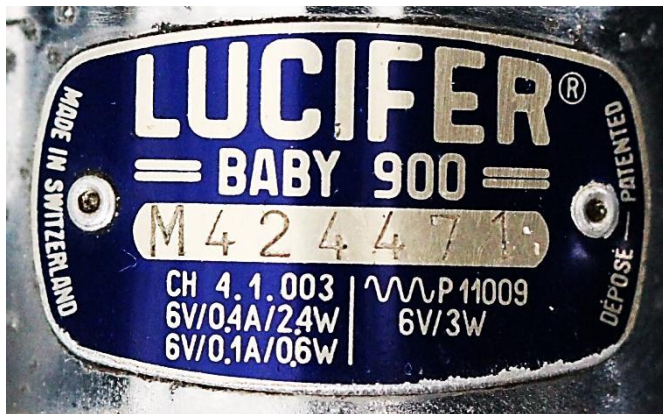
Bild 6.13: Leistungsschild mit der Leistungsaufteilung für Scheinwerfer und Rücklicht
