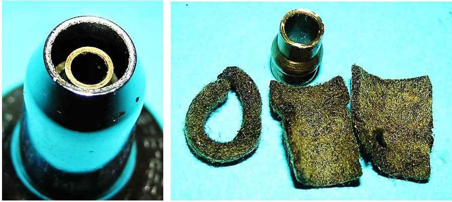
Bild 5.48: Oberes Kalottenlager mit Filzelementen
