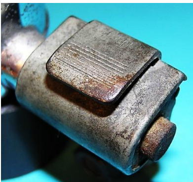
Bild 2.7: Basisblechfußhebel - Auslösung der Kippbewegung des Dynamokörpers durch einen am Basisblech gelagerten Fußhebel
