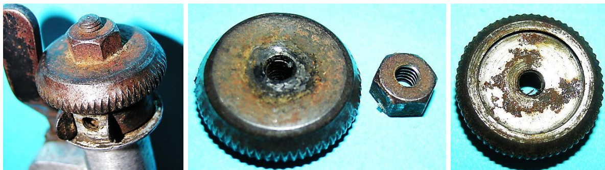
Bild 3.74: Befestigung massiven Reibrades auf der Welle
