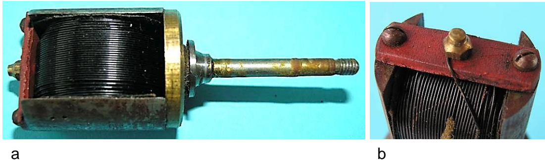
Bild 3.50: Anker (Pollänge 27,2 mm, Durchmesser 26,2 mm): a) Doppel-T-Anker mit Welle, b) Isoliersteg mit Schleifkontakt
