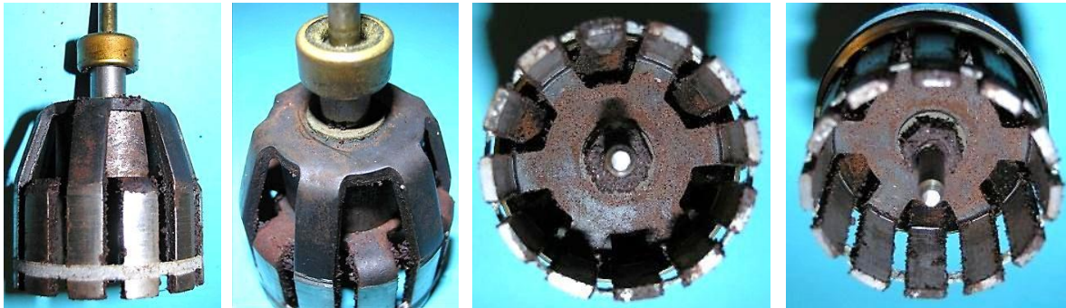
Bild 4.57: Klauenpolsystem des Läufers mit zweipoligem Dauermagneten
