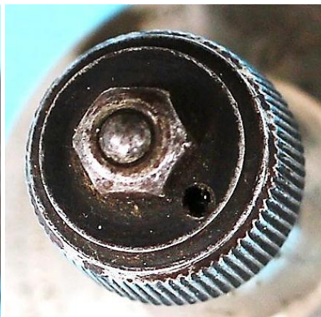
Bild 4.35: Schmiermittelversorgung des oberen Gleitlagers: a) Oberes Gleitlager, b) Ölbohrung im Reibrad
