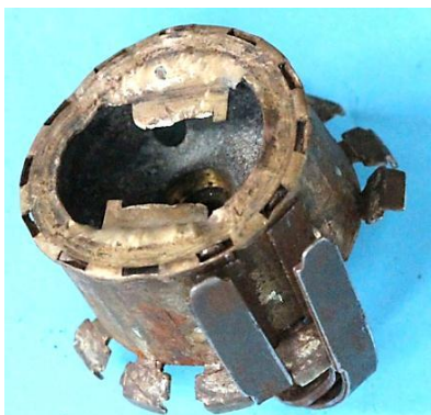
Bild 4.23: Montagekorb mit Ankerpolpaaren: a) Montagekorb mit Abstandsring, b) Abstandsring, c) Montagekorb mit den 6 Doppelpolpaaren
