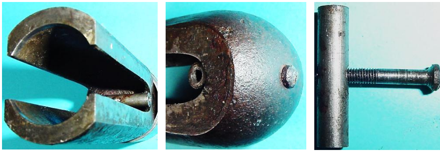
Bild 3.57: Positionierung des Rohrs mit Innengewinde zur Befestigung der Pollückenbleche
