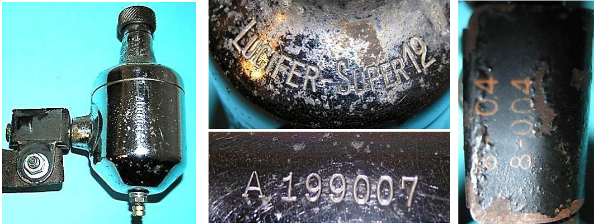
Bild 4.52: Beschriftungen auf dem Lagerhalsfuß, dem Gehäusemantel und der Abdeckung der Druckfeder
