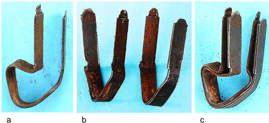
Bild 4.15: Elemente eines Ankerpolpaares: a) Geformtes Doppelblech, b) Zwei parallele Polpaare, c) Zwei parallele Polpaare zu einem Doppelpol vereinigt
