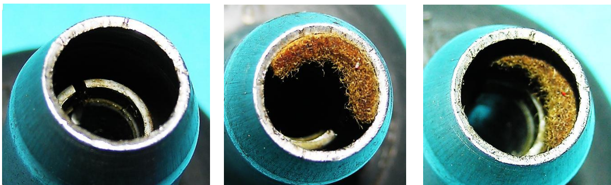
Bild 5.26: Einlegen einer Filzmatte: a) Raum zwischen der Gehäusewand und des Lagersitzes für Filzmatten, b) Einsetzen einer Filzmatte, c) Filzmattenposition
