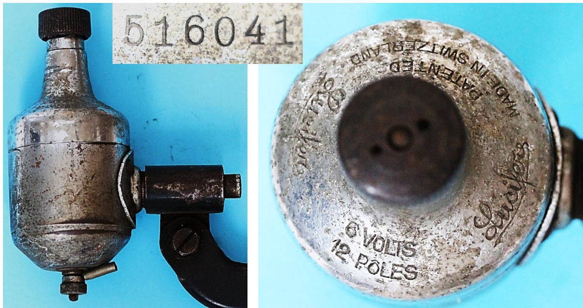
Bild 4.43: Lucifer-Dynamo mit 12 Einzelmagneten mit der Fertigungsnummer 516041
