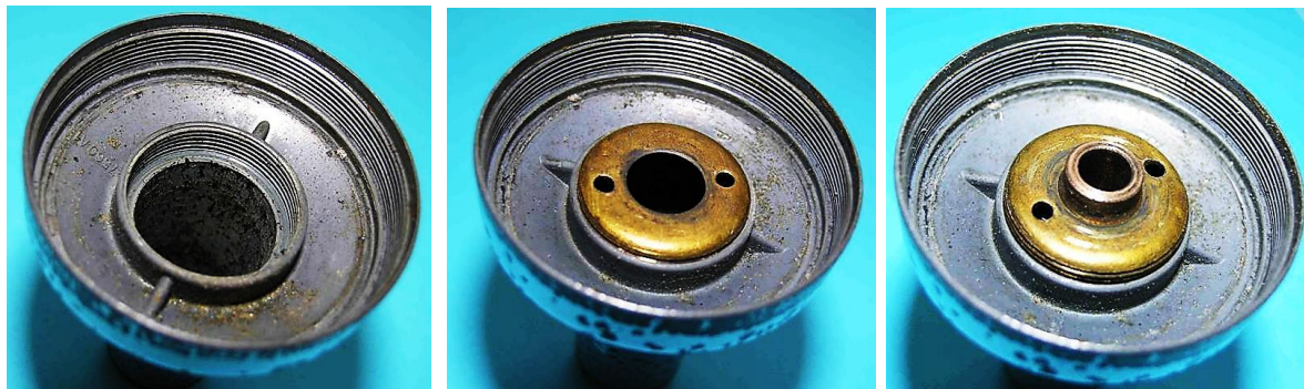
Bild 6.33: Lagerhalsfuß: a) Ohne Lager, b) Mit eingeschraubtem Lagerschild, c) Mit Kalottenlager
