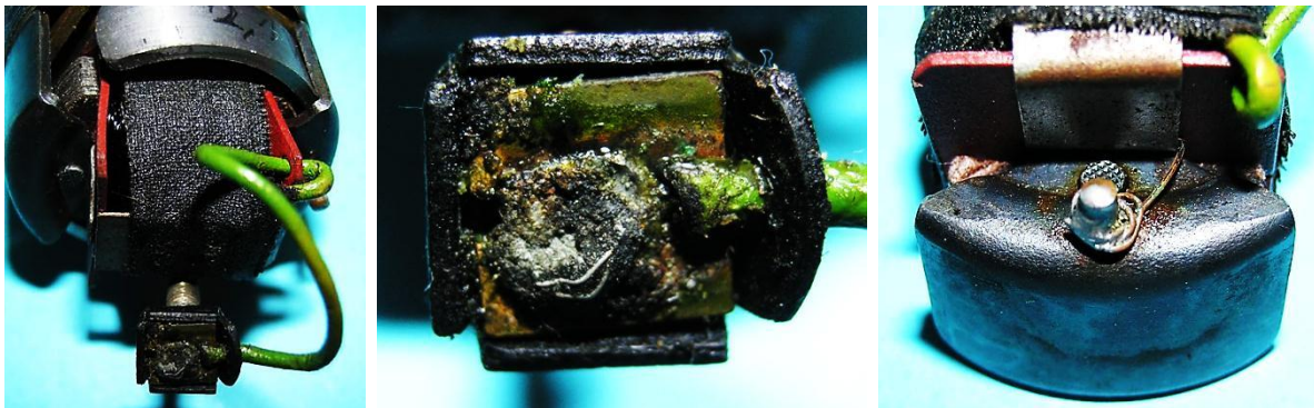
Bild 5.54: Kontaktierung: a) Befestigung der Anschlusslitze am Spulenkörper, b) Lötstelle am Kabelanschluss c) Massekontakt
