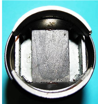
Bild 5.76: Polrad Lucifer 800a S403953 (Fe 57 %, Co 22 %, Ni 15 %, Cu 6 %)
