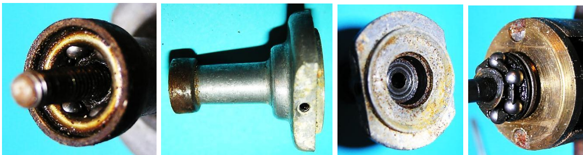
Bild 3.34: Lagerung: a) Oberes Kugellager, b) Lagerhals, c) Untere Lagerschale, d) Unteres Kugellager auf der Welle
