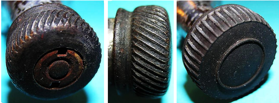
Bild 6.14: Reibrad (22 mm Durchmesser): a) Versenkte Schlitzmutter, b) Geschrägte Rippen und Schleuderkante, c) Gummikappe mit 31 mm Durchmesser
