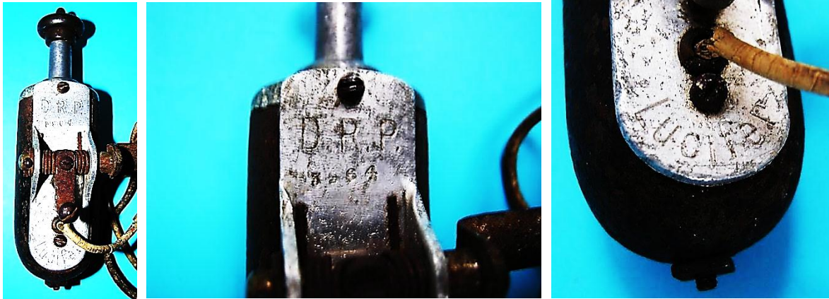
Bild 3.32: Beschriftungen: a) Pollückenblech mit der Kippvorrichtung, b) Initialen D.R.P. zum Hinweis auf ein patentiertes Erzeugnis, c) Markenname „Lucifer“
