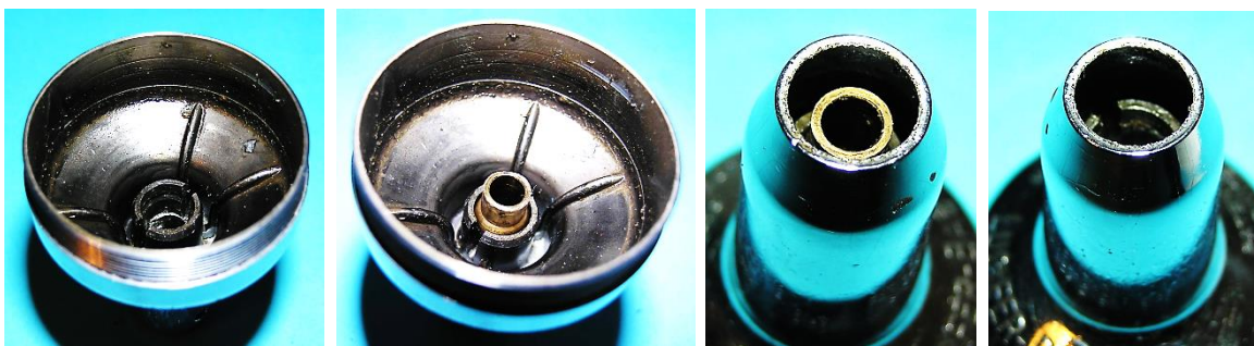
Bild 5.47: Lager: a) Lagerhalsfuß mit Kalottensitz, b) Lagerhalsfuß mit unterer Kalotte, c) Obere Kalotte, d) Oberer Kalottensitz
