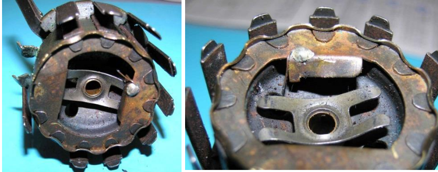
Bild 4.65: Montagezylinder mit Kalottenlagerschild
