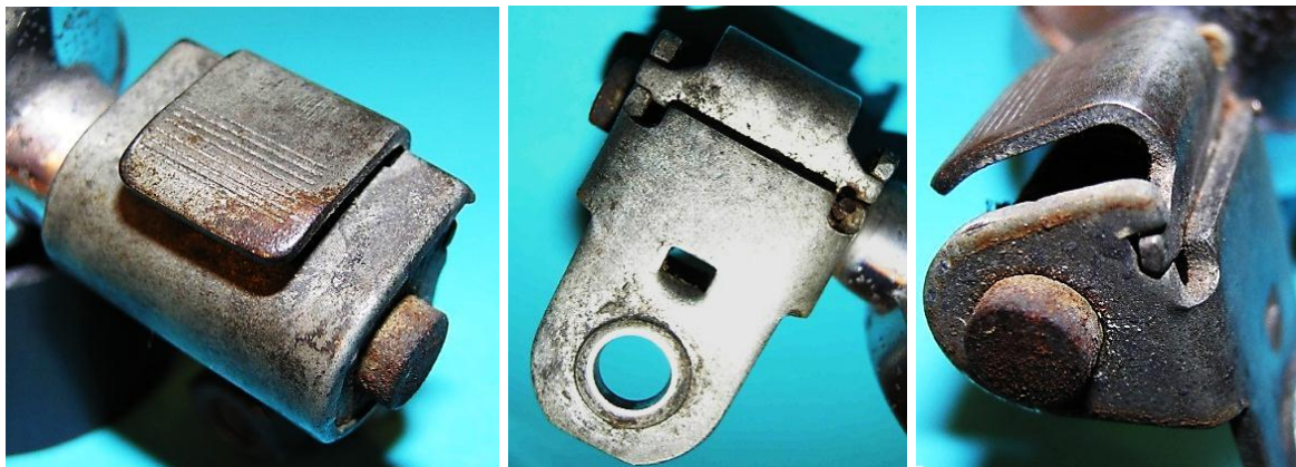
Bild 6.20: Kippvorrichtung mit Fußhebel: a) Fußhebel, b) und c) Lagerung des Fußhebels im Basisblech
