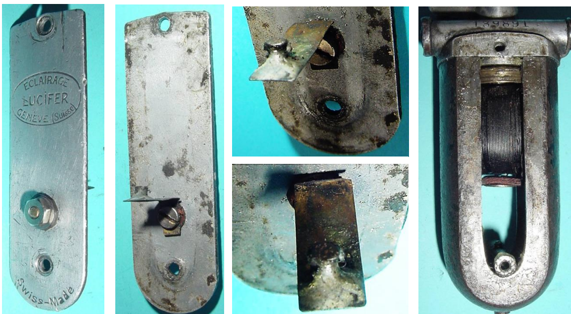
Bild 3.59: Abdeckung der Pollücke mit dem spannungsführenden Kontakt
