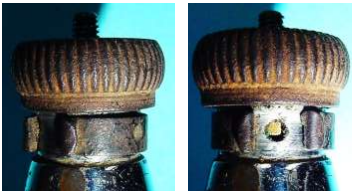
Bild 2.14: Federklammer zur Abdeckung des Ölloches
