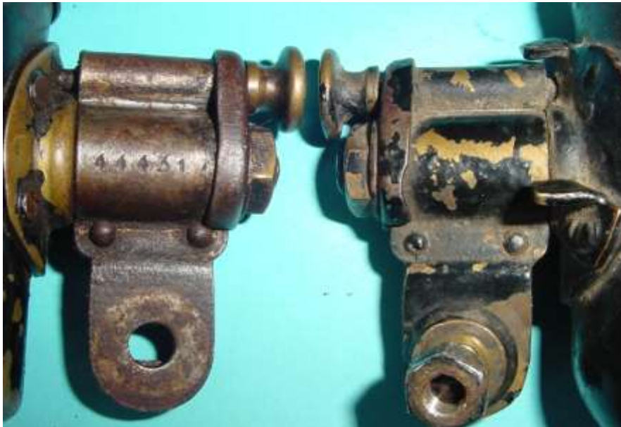
Bild 2.10: Kippvorrichtungen: a) Balaco-Record 204425, b) Balaco Record Nr. 602059
