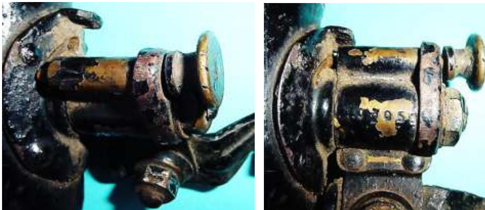
Bild 2.9: Beide Stellungen der Kippvorrichtung
