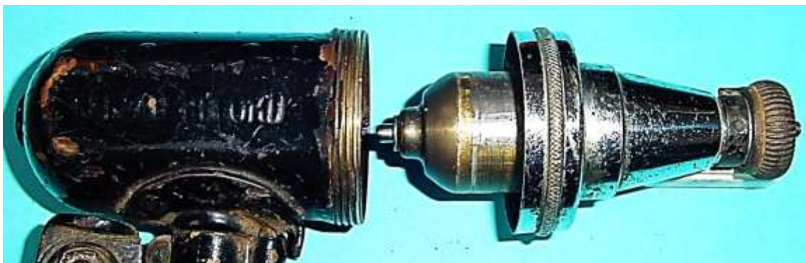
Bild 2.11: Gehäusetopf und Lagerhals mit Anker
