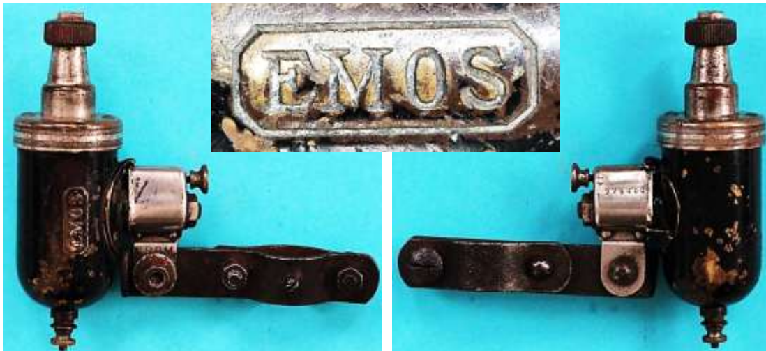
Bild 1.6: Emos, ein Balaco-Dynamo ohne Ausweisung des Produzenten
