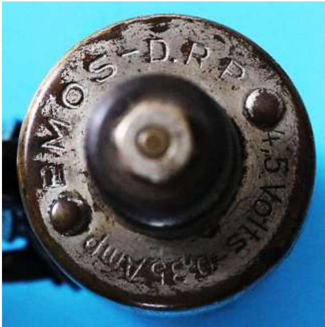
Bild 1.8. Beschriftung des Lagerhalsfußes mit dem Firmen- bzw. Typen- namen und den Nenndaten 4,5 V und 0,35 A
