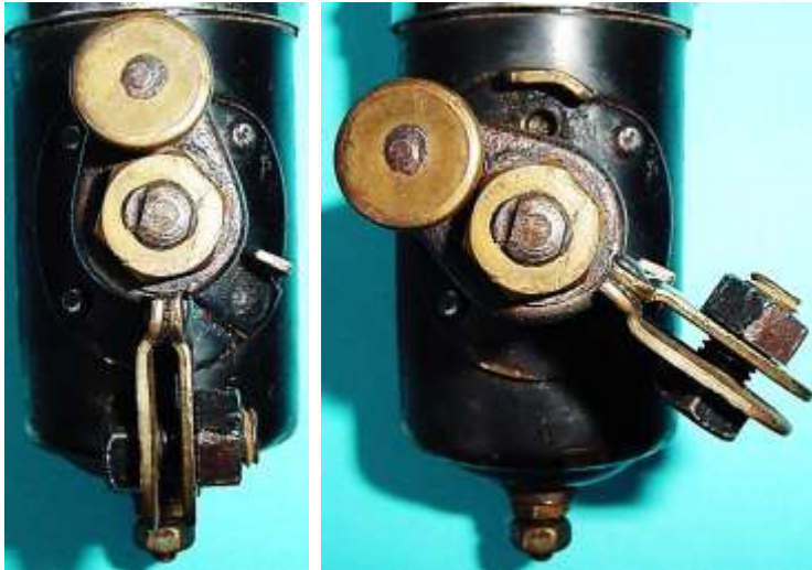
Bild 2.3: Zwei Stellungen der Kippvorrichtung
