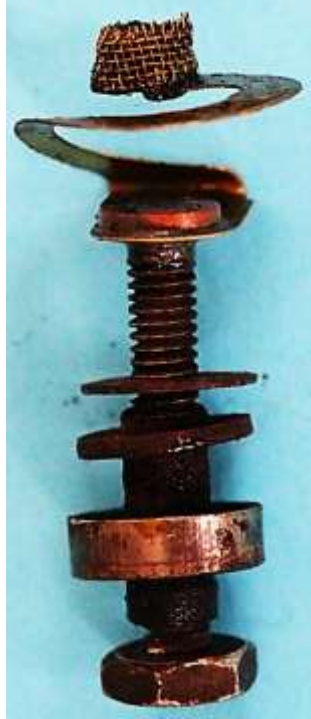
Bild 1.30: Kabelanschlussbolzen und Kupfergewebebürste
