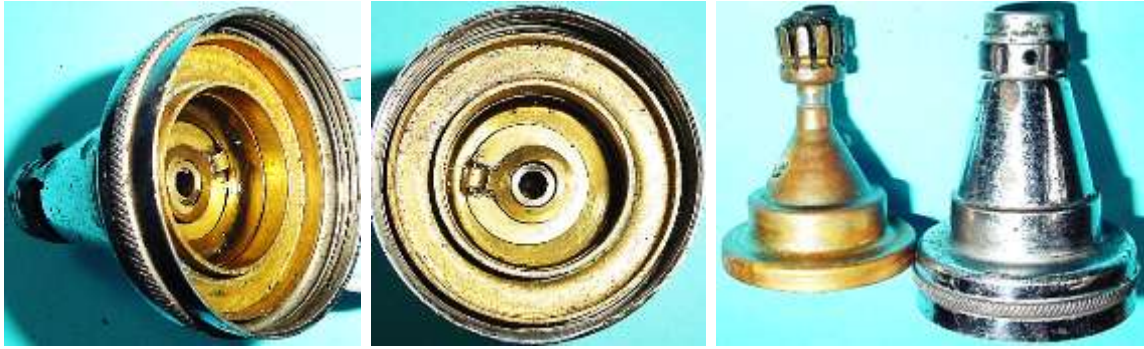
a) b) c) Bild 2.13: Innerer und äußerer Lagerhals
