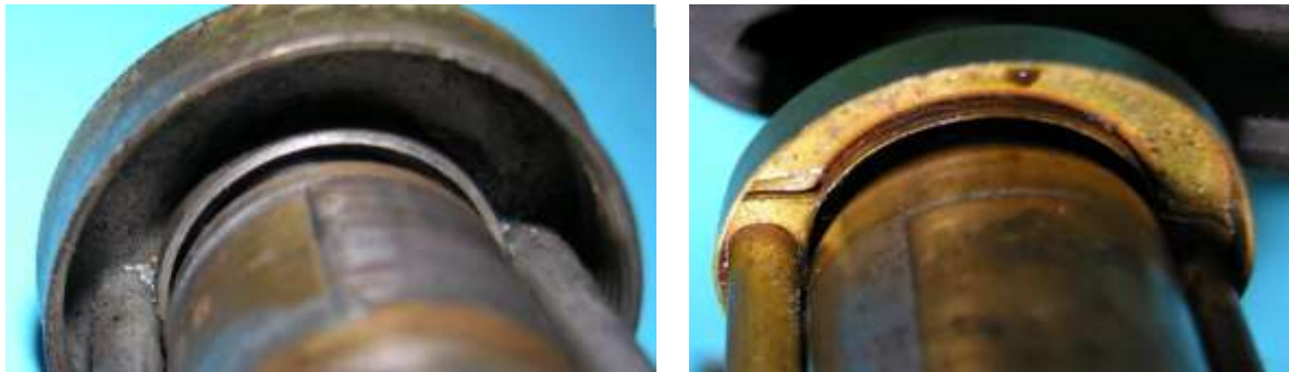
Bild 1.27: Anbringung der Stehbolzen: a) Am Lagerhalsfuß beim Vorgängertyp, b) Am oberen Lagerschild beim Baldauf-Dynamo
