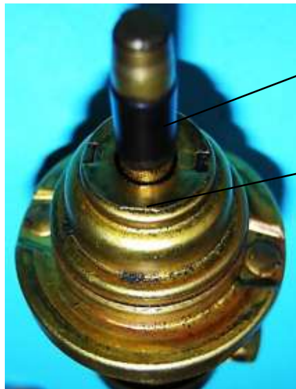
Bild 1.23: Lagerschilde: a) Unteres Lagerschild, b) Oberes Lagerschild
