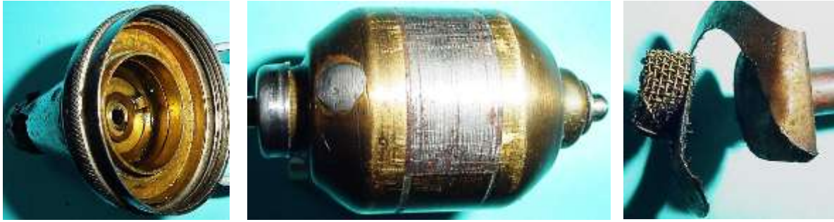
Bild 2.17: Kontaktierung des Ankers
