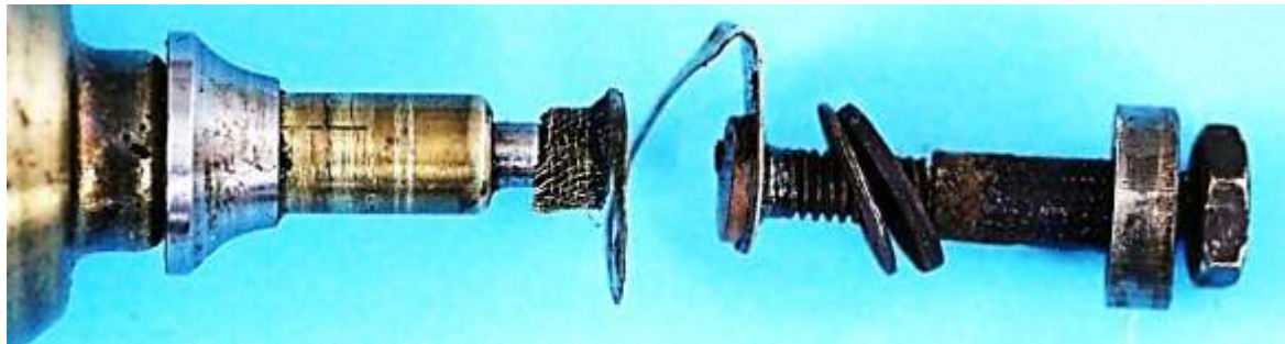
Bild 1.31: Abschnitt des elektrischen Stromkreises mit Schleifkontakt
