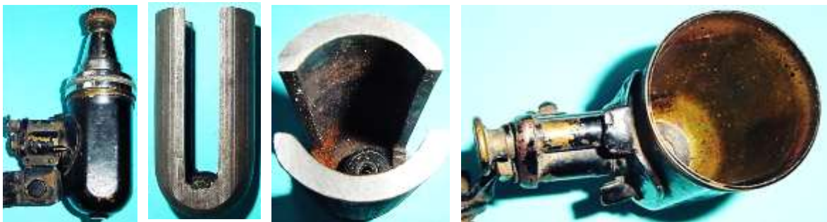
Bild 2.15: Gehäuse und Magnet
