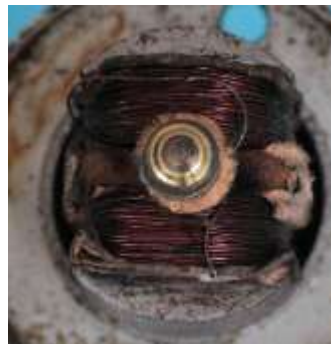
Bild 2.9: Anker: a) Stegisolation teilweise entfernt, b) Zwei Nuten in jeder Polücke
