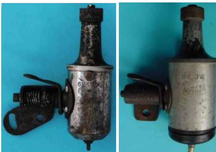
Bild 1.2: Ausführungsformen der Marke SESTA: a) 1,5 W, b) 3 W
