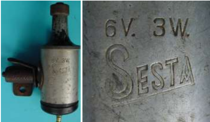
Bild 3.1: Ansicht des SESTA-Dynamos mit Schriftzug und Nenndaten
