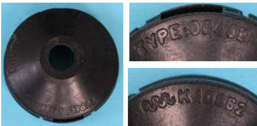
Bild 1.3: Typenbezeichnung und K-Nummer auf dem Boden
