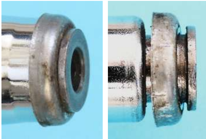
Bild 1.6: Oberes Gleitlager mit Schutzkappe
