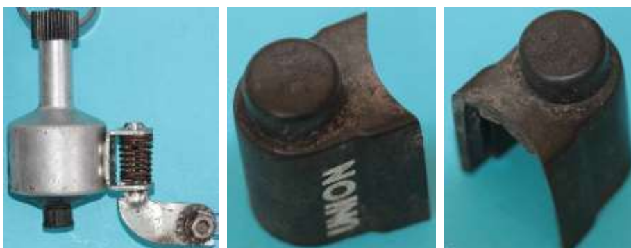
Bild 5.5: Schutzkappe der Kippvorrichtung und Druckfläche zum Entriegeln
