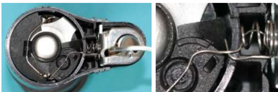
Bild 9.18: Masseverbindung mit Schraubenfeder
