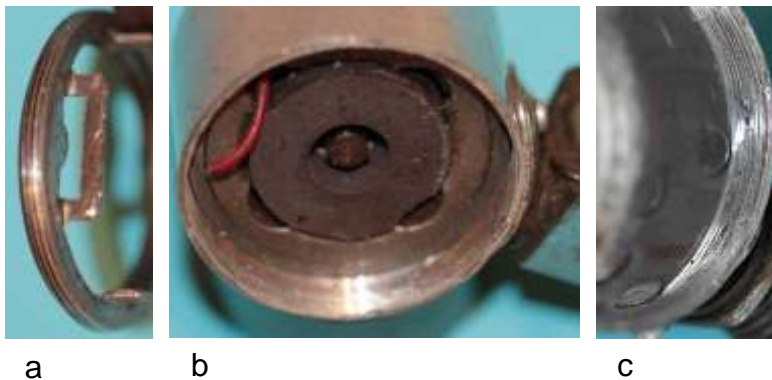
Bild 2.9: Verschraubung: a) Gewindering, b) Polrad und untere Stirnseite des Ankers c) Feingewinde im Gehäusemantel
