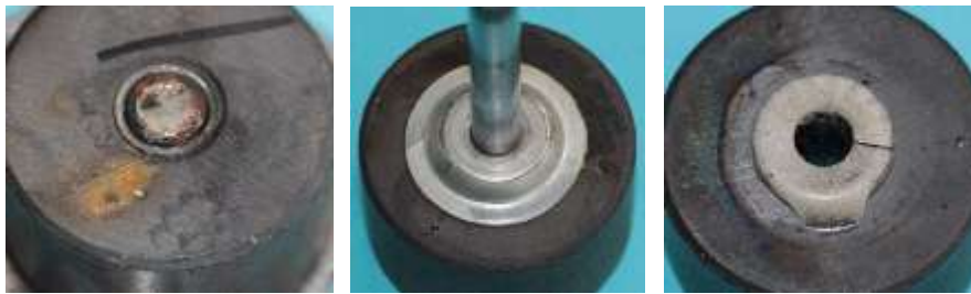
Bild 6.17: Welle im Magnetkörper: a) Untere Stirnseite, b) Oberseite mit Anlaufscheibe, c) Herausgeschlagene Welle
