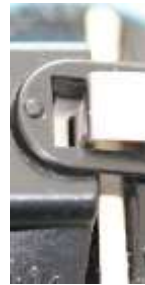
Bild 7.12: Prinzip der Kabelkontaktierung mit Federblechklemmen: a) Federschleufe b) Kabelkanal c) Eingelegter Draht
