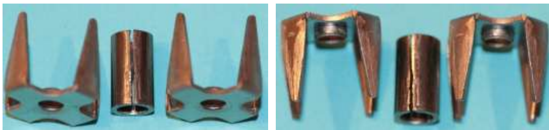
Bild 11.16: Zwei gleiche Polkränze und ein gerolltes Rohr als Spulenkern
