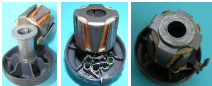
Bild 10.24: Befestigung des Ankers am Boden mit dem Spurlagerschaft a) Verdrehsichere Position des Spurlagerschafts b) Anker c) Montierter Anker
