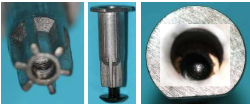
Bild 10.23: Spurlager a) Gewinde unterhalb des Spurlagers b) Spurlagerschaft c) Axiallagerkugel
