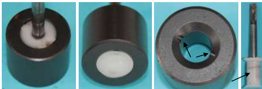
Bild 6.18: Im Magnetkörper eingegossene Welle a) Obere Stirnseite b) Untere Stirnseite c) Vorsprünge am Bohrungsrand d) Vergussmasse
