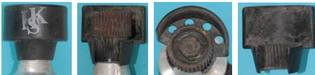
Bild 6.5: Spritzschutz: a) Außenseite, b) Innenseite mit Reibrad, c) Draufsicht des Reibrads und des Spritzschutzes, d) Innenansicht
