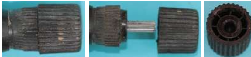
Bild 6.8: Einteiliges Reibrad aus Kunststoff
