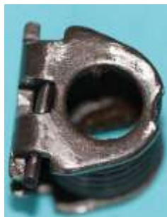
Bild 11.8: Basisblech und Druckfeder: a) und b) Abstützung der Feder am Basisblech, c) Federenden zum Anlegen am Drehbolzen, d) Drehbolzen und Federenden
