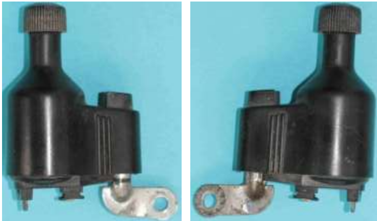
Bild 9.7: Union-Dynamo mit der Beschriftung: TP GBi 7193 BS 6102/3
