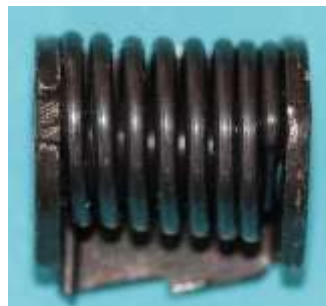
Bild 11.8: Basisblech und Druckfeder: a) und b) Abstützung der Feder am Basisblech, c) Federenden zum Anlegen am Drehbolzen, d) Drehbolzen und Federenden
