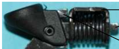
Bild 11.7: Axiale Verschiebung des Dynamos auf dem Drehbolzen: a) Ruhestellung, b) Arbeitsstellung
