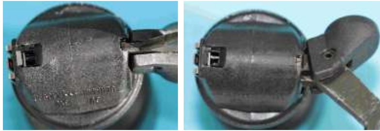
Bild 11.9: Im Boden eingesetzte Kippvorrichtung: a) Ruhestellung, b) Arbeitsstellung
