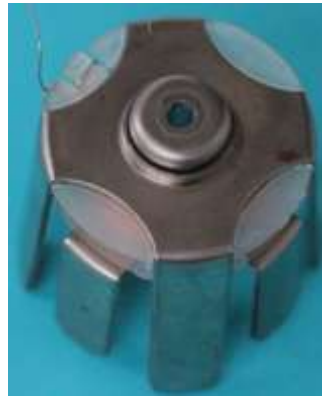
Bild 9.3: Zweiteiliges Klauenpolsystem mit gebrochenen Klauenpolkränzen a) NR.307 und Nr. 309 b) Nr.410.0
