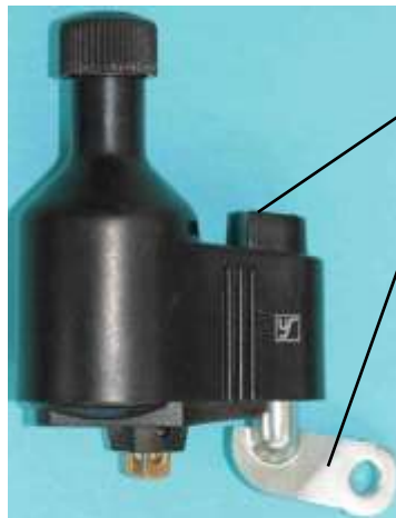
Bild 9.4: Zwei Ausführungen des Typs GBi 7193 BS 6102/3 a) Diagonal angeordnete unterschiedliche Klemmen b) Zwei Schraubenfederklemmen
