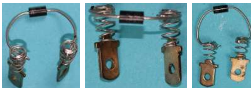
Bild 9.21: Baugruppe bestehend aus der Zenerdiode, den Kontaktfedern und den Kabelanschlussblechen
