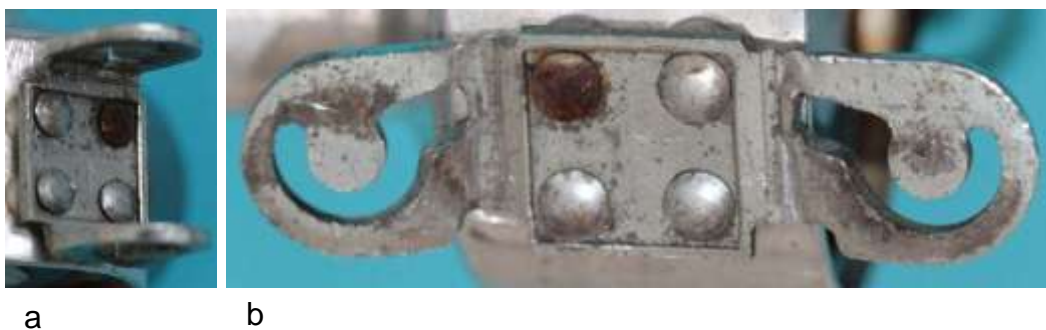
Bild 5.8: Basisblech: a) Abgewinkelte Seitenbleche, b) Aufgebogene Seitenbleche zur Demonstration des Schnittbildes
