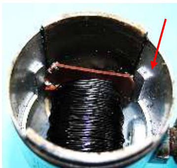
Bild 2.5: Gehäusetopf: a) und b) Position des Ankers im Gehäusetopf, c) Gehäusetopf mit Kabelanschlussbolzen und Drehbolzenstutzen
