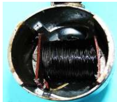
Bild 2.5: Gehäusetopf: a) und b) Position des Ankers im Gehäusetopf, c) Gehäusetopf mit Kabelanschlussbolzen und Drehbolzenstutzen
