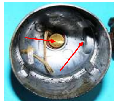
Bild 2.5: Gehäusetopf: a) und b) Position des Ankers im Gehäusetopf, c) Gehäusetopf mit Kabelanschlussbolzen und Drehbolzenstutzen
