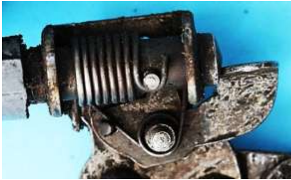
Bild 2.3: Aufbau der Kippvorrichtung: a) Ruhestellung, b) Betriebsstellung
