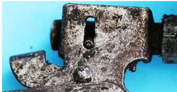
Bild 2.4: Positionen des Sperrstiftes im Basisblech: a) Ruhestellung, b) Betriebsstellung
