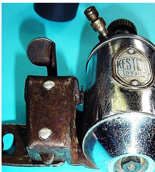
Bild 7.24: Sichtbares Stößelende unter der Kippvorrichtung
