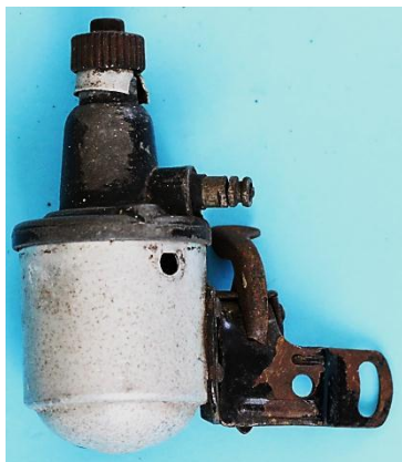
Bild 10.7: 2,1 W-Variante mit reduzierten Abmessungen der Kippvorrichtung
