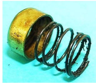
Bild 11.8: Komponenten des Strompfads: Schraubenfeder und Kontaktkappe
