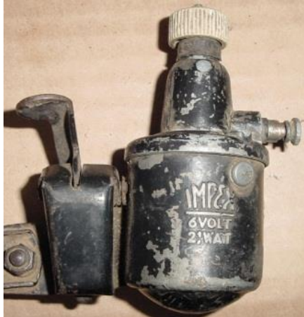
b) Impex vierpolig 6 V. 2,1 W m: 450 g
