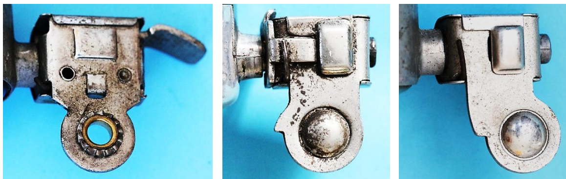
Bild 12.47: Halterarmrückseiten der Impex-Kugeldynamos
