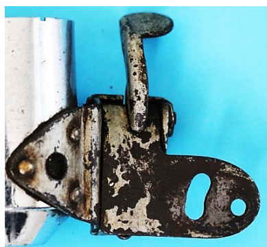
Bild 3.10: Halterarmvarianten zweipoliger Dynamos
