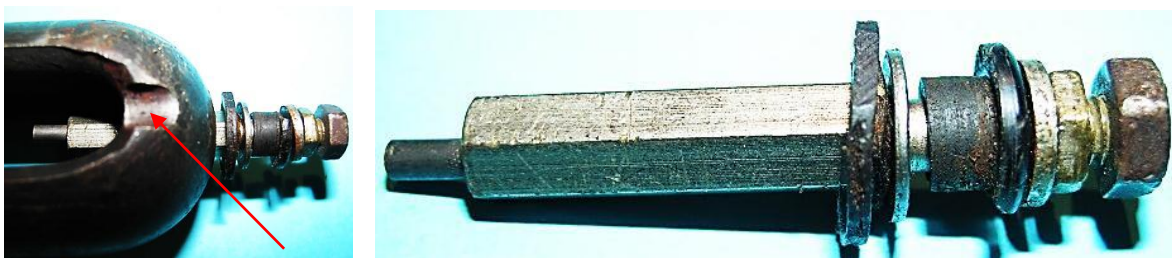
Bild 8.9: Kombination aus Kabelanschlussbolzens und Bürstenhalter
