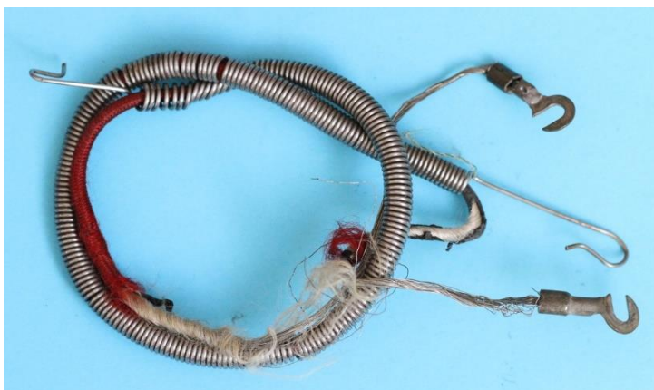
Bild 12.16: Lampenkabel, verzinnnte Litze mit Stahldrahtummantelung
