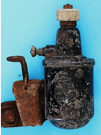
a) Impex vierpolig 6 V. 3 W m: 515 g
