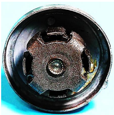
Bild 12.30: Baugruppen: a) Achtepoliges Klauenpolrad mit zweipoligem Magneten. b) Gehäusetopf mit der Kippvorrichtung
