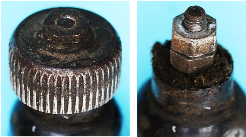
Bild 6.4: Reibrad mit Innensechskant zwischen zwei Muttern befestigt
