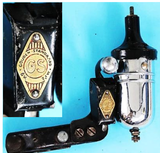
Bild 3.6: Gouden Standard, 6 V, 2,1 W: a) Unbeschriftetes Exemplar, b) Gouden Standard, niederländisches Produkt
