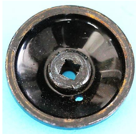
Bild 12.73: Äu- ßere und innere Ansicht des Duroplastbo- dens
