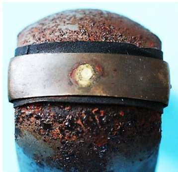
Bild 9.30: Kontaktblechbasis: a) Isolierte Lage auf dem Joch, b) Kontaktblech von unten, c) Oberfläche des Kontaktblechs (Pfeile zeigen auf die gleiche Kontaktblechkante)
