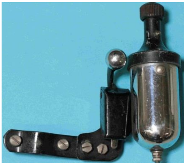
Bild 3.6: Gouden Standard, 6 V, 2,1 W: a) Unbeschriftetes Exemplar, b) Gouden Standard, niederländisches Produkt
