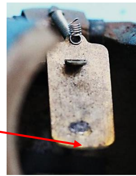
Bild 9.30: Kontaktblechbasis: a) Isolierte Lage auf dem Joch, b) Kontaktblech von unten, c) Oberfläche des Kontaktblechs (Pfeile zeigen auf die gleiche Kontaktblechkante)
