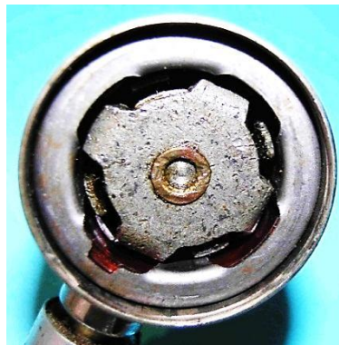
Bild 12.33: Abgenommener Boden: a) Steg mit Bodenschraube, b) Stirnseiten des Polrades und des Ankers
