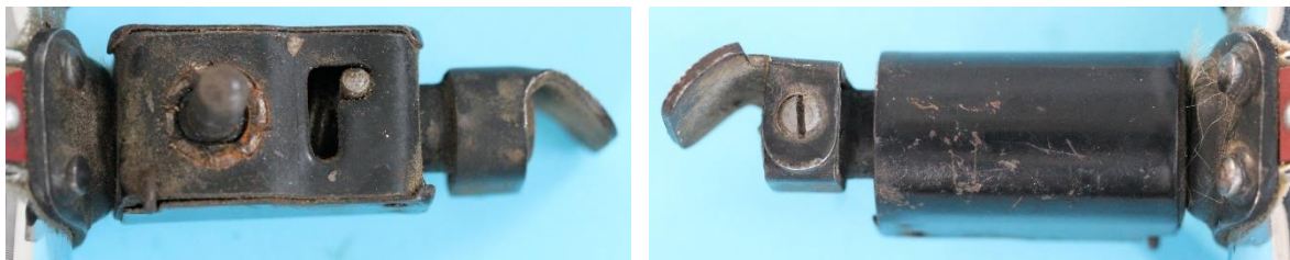
Bild 12.8: Geschlossene Kippvorrichtung: a) Halterbolzen und Winkelkulissee, b) Schraubverbindung des Fußpedals mit dem Drehbolzen
