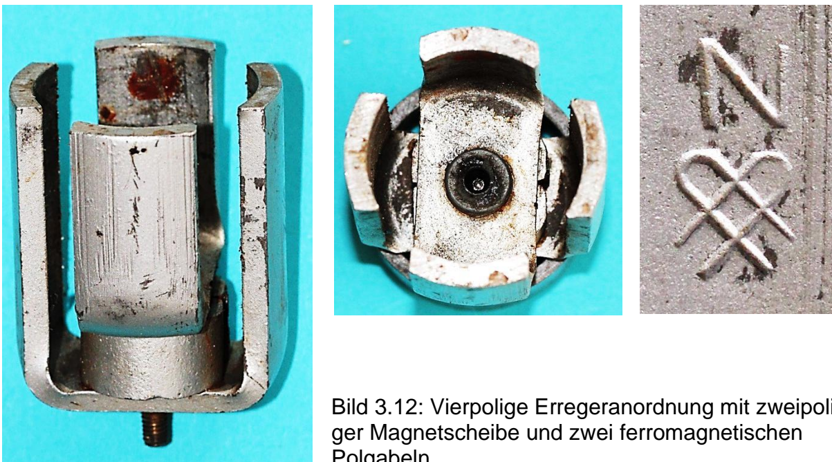
Bild 3.11: Ausführungen mit AlNi-Magnetmaterial: a) Unlesbares Firmenschild, b) Gabelpoldynamo Vaterland mit Kippvorrichtung des Impex-Dynamos im Bild 3.8c
