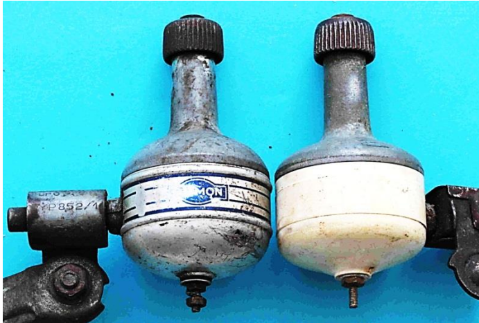
Bild 3.14: Aufnahme der Dynamo- produktion nach dem Krieg a) Typischer Daimler-Benz-Dynamo b) Impex-Kugeldynamo von 1955- 1962
