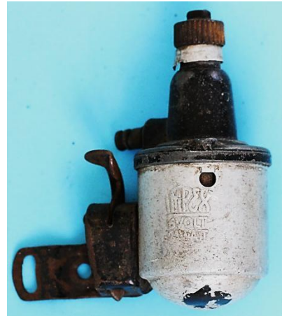
c) Impex vierpolig 6 V. 2,1 W m: 410 g
