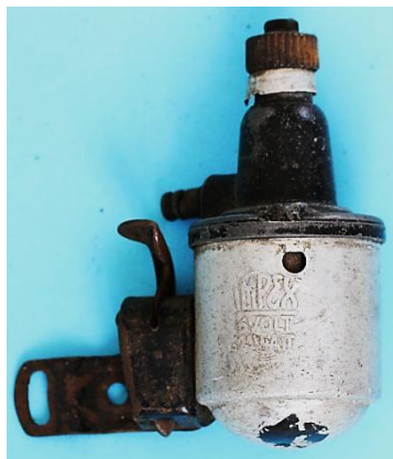
Bild 10.7: 2,1 W-Variante mit reduzierten Abmessungen der Kippvorrichtung
