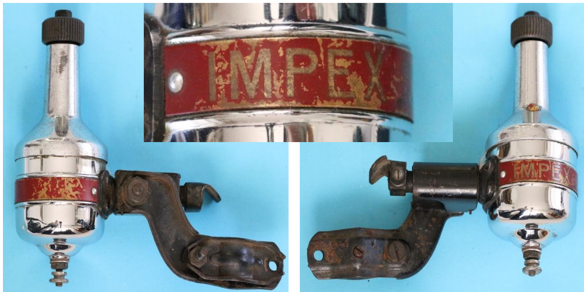
Bild 3.13: Zweipoliger Impex-Dynamo mit Blätterpolanker
