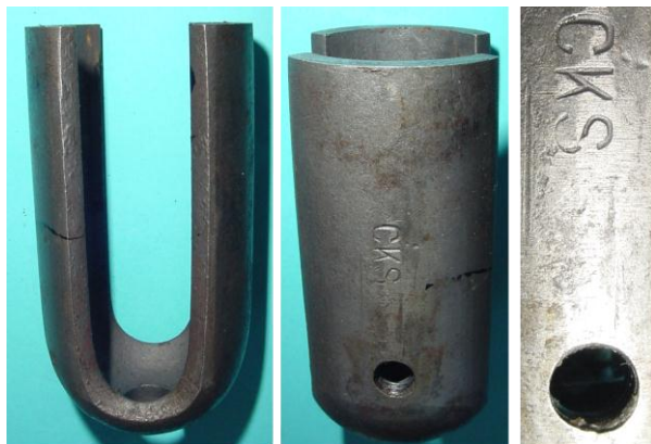
Bild 1.2 Magnetsystem: a) Pollücke, b) Polschenkel, c) Stempel CKS
