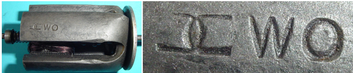
Bild 1.7: Kennzeichnung des Magneten mit zwei ineinander verschlungenen Hufeisenmagneten und den Buchstaben WO
