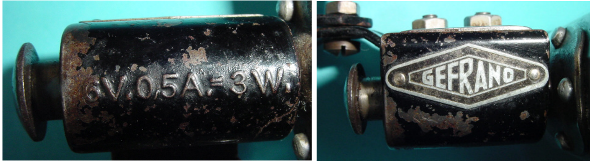
Bild 1.6: Beschriftungen auf der Abdeckung der Kippvorrichtung
