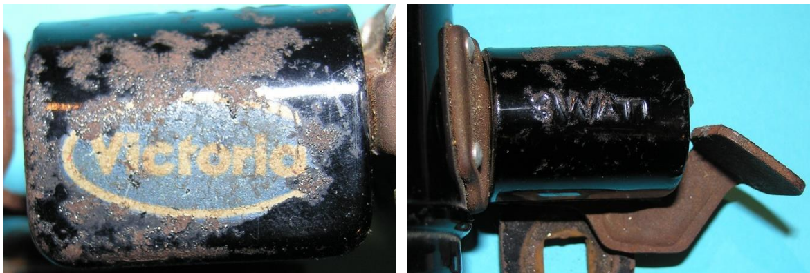
Bild 2.12: Beschriftung der Kippvorrichtungsabdeckung durch ein Abziehbild mit der Typenbezeichnung und durch die Einprägung der Nennleistung
