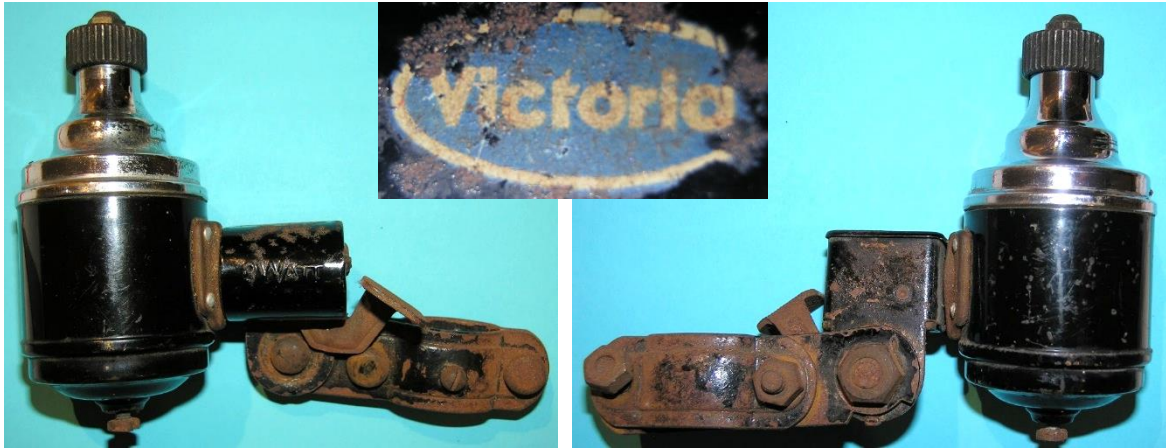
Bild 2.13: 3 W-Dynamo mit der Typenbezeichnung „Victoria“, Gewicht 465 g
