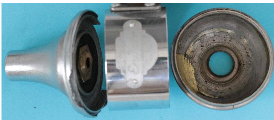
Bild 3.2: Dreiteiliges Gehäuse a) Lagerhals, b) Gehäusemantel c) Boden
