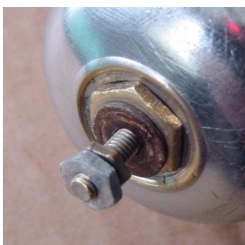
Bild 3.7: Spannung führender Kontakt: a) Hülse mit Kabelanschlussbolzen und Blattfeder, b) Blattfeder mit Kupferbürste
