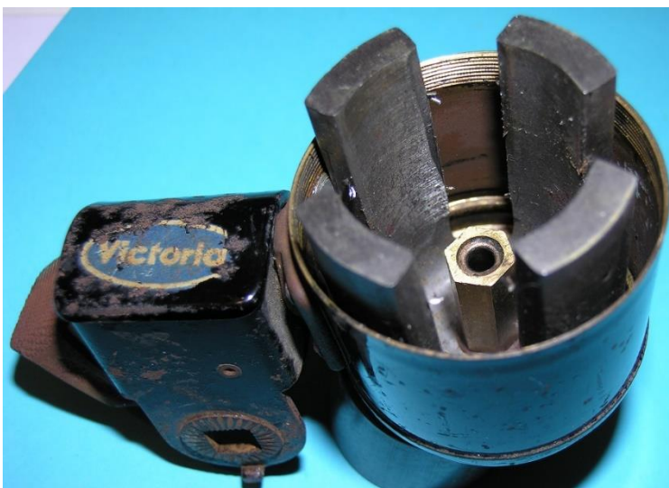
Bild 2.21: Platzsituation im Gehäusetopf: Magnetaußendurchmesser 44 mm, Gehäusetopffinnendurchmesser 49 mm
