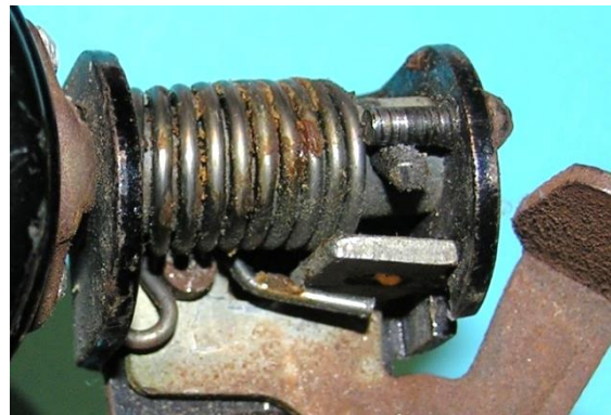
Bild 2.15: Einzelheiten der Kippvorrichtung (Ruhestellung)
