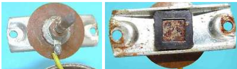
Bild 1.11: Tragsteg: a) Spulenanschluss, b) Kopf des Kabelbolzens
