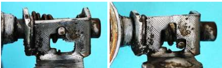
Bild 1.20: Raststellungen: a) Ruhestellung b) Arbeitsstellung
