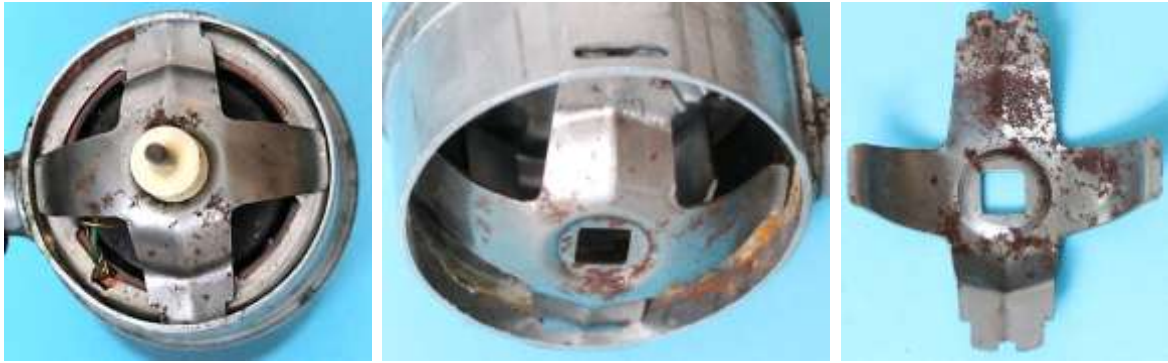
Bild 1.23: Montagegesteg des Kabelanschlussbolzens: a) Tragsteg mit Kabelanschlussbolzen, b) Tragsteg eingesetzt im Lagerhalstopf, c) Tragsteg
