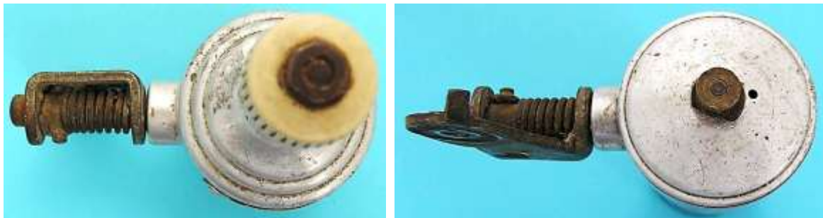
Bild 1.8: Ansichten: a) Reibrad, Lagerhals und Kippvorrichtung, b) Boden mit Lüftungsbohrung
