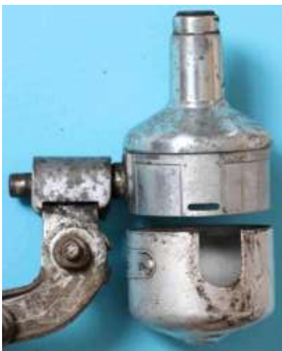
Bild 1.2: Zweiteiliges Gehäuse aus Lagerhalstopf und Gehäusetopf
