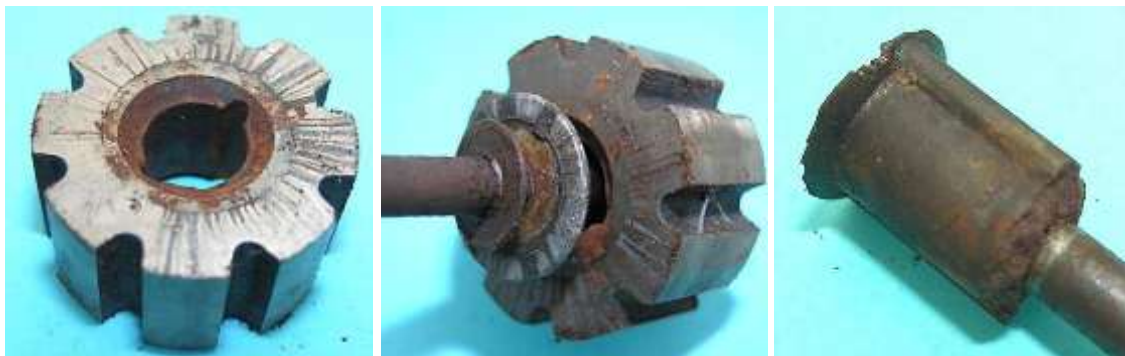
Bild 1.16: Sternpolrad: a) Achtpoliger Magnetkörper, b) Magnetkörper mit Welle, c) Kunstharzkörper auf der Welle
