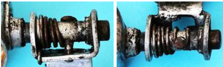
Bild 1.19: Fixierung der Feder: a) am Basisblech b) am Sperrstift
