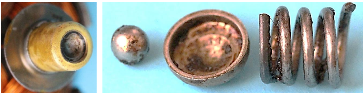
Bild 27: Axiallagertopf: a) Positionierung auf der Innenseite des Magnetjochs, b) Axialspiausgleichsfeder im Topf, c) Untere Lagerschale mit Kugel auf der Schraubenfeder
