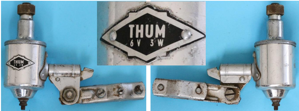
Bild 1: Thum 3 W, vierpoliger Tulpenmagnetdynamo, Gewicht ohne Halter: 400 g
