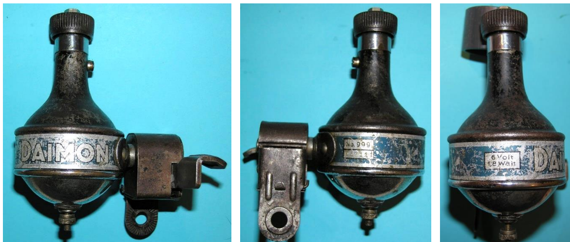
Bild 1.1: Daimon No.999, 6 V, 1,8 W, Fertigungsnummer 037111
