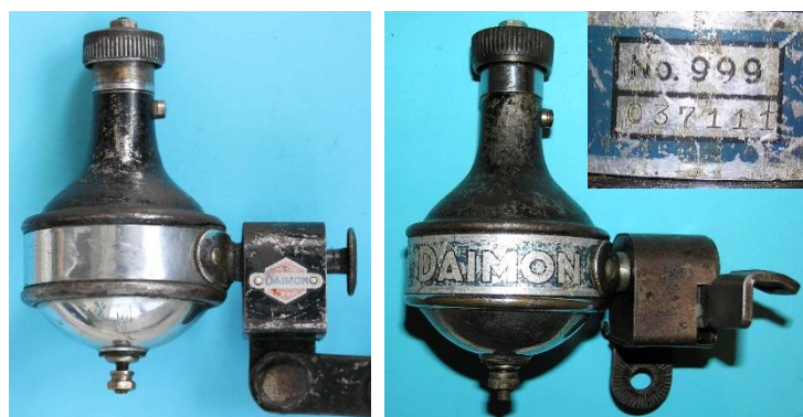
Bild 1.3: Übereinstimmende Dynamokörper mit unterschiedlichen Kippvorrichtungen
