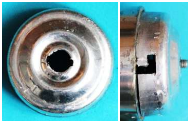
Bild 4.4: Bajonettverschluss zum Einklinken des Bodens
