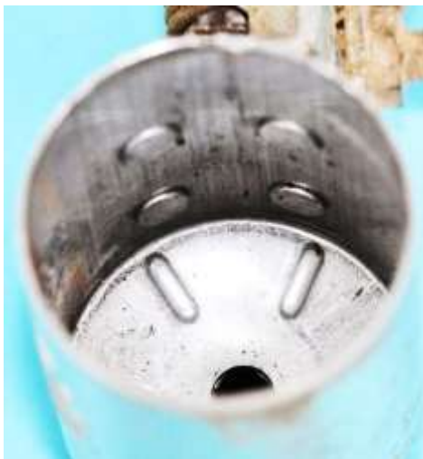
Bild 3.4: Befestigung der Kippvorrichtung am Gehäusetopf
