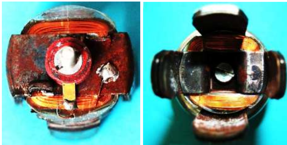
Bild 4.6: Ankerkonstruktion: a) Spulenschlüsse, b) Pole des Ankers
