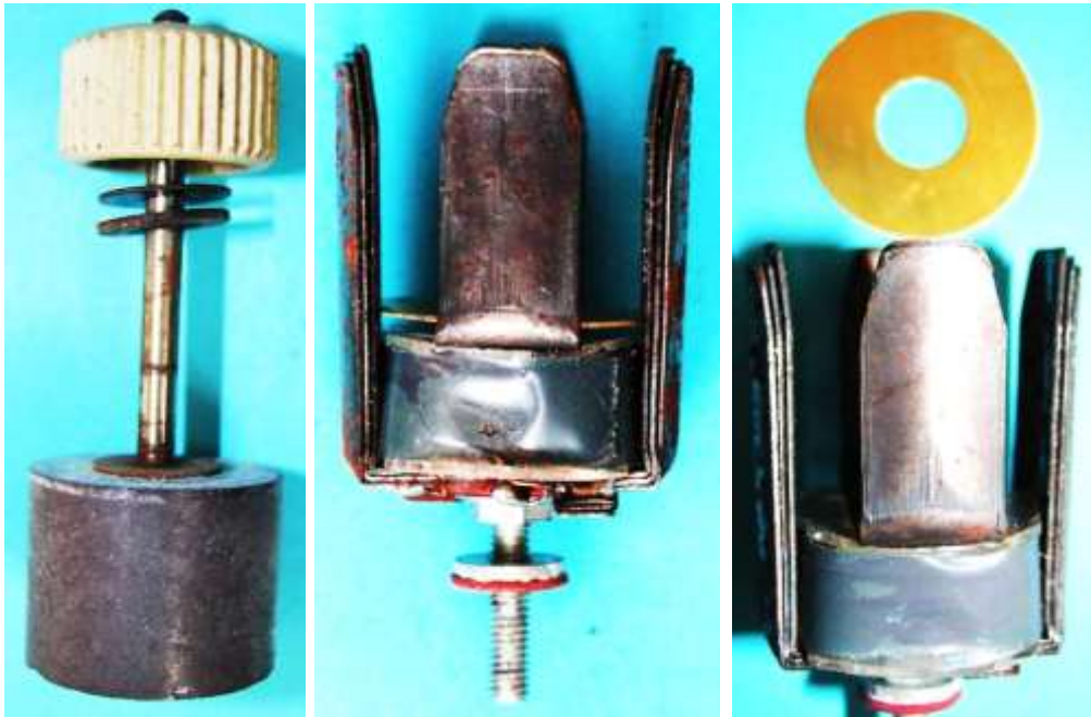
Bild 4.7: Generatorbauteile: a) Polrad mit Reibrad, b) Blätterpole des Ankers, c) Messingscheibe zur Sicherung des Luftspalts zwischen Polrad und Ankerpolen
