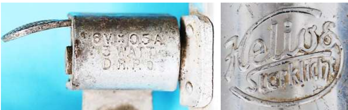
Bild 3.2: Beschriftungen: a) Nenndaten auf der Abdeckung der Kippvorrichtung, b) Firmenschriftzug und Markenname auf dem Mantel eingeprägt
