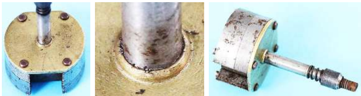
Bild 3.15: Befestigung der Welle senkrecht auf der oberen Messingplatte
