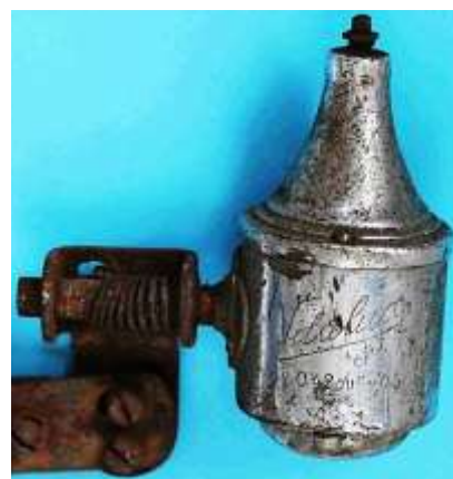
Bild 1.4: Wechsel vom ruhenden Tulpenmagneten zum rotierenden AlNi-Blockmagneten: a) Vitalux, Tulpenmagnetdynamo für 8 V und 0,25 A, b) Vita Baby, AlNi-Blockmagnetdynamo für 6 V und 0,3 A, c) Vitalux, AlNi-Blockmagnetdynamo für 6 V und 0,42 A
