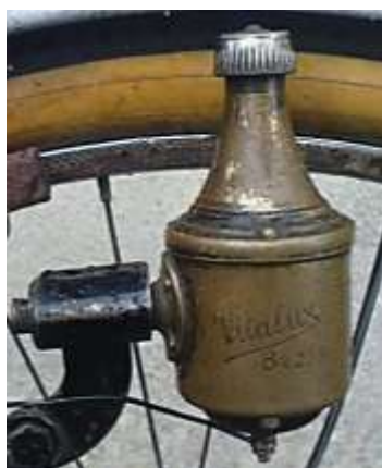
Bild 1.4: Wechsel vom ruhenden Tulpenmagneten zum rotierenden AlNi-Blockmagneten: a) Vitalux, Tulpenmagnetdynamo für 8 V und 0,25 A, b) Vita Baby, AlNi-Blockmagnetdynamo für 6 V und 0,3 A, c) Vitalux, AlNi-Blockmagnetdynamo für 6 V und 0,42 A
