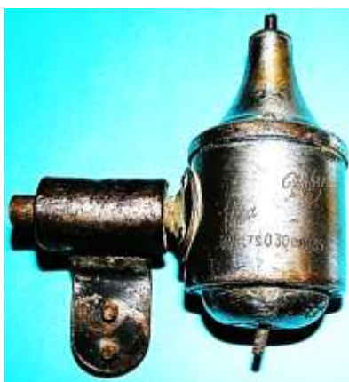
Bild 1.4: Wechsel vom ruhenden Tulpenmagneten zum rotierenden AlNi-Blockmagneten: a) Vitalux, Tulpenmagnetdynamo für 8 V und 0,25 A, b) Vita Baby, AlNi-Blockmagnetdynamo für 6 V und 0,3 A, c) Vitalux, AlNi-Blockmagnetdynamo für 6 V und 0,42 A
