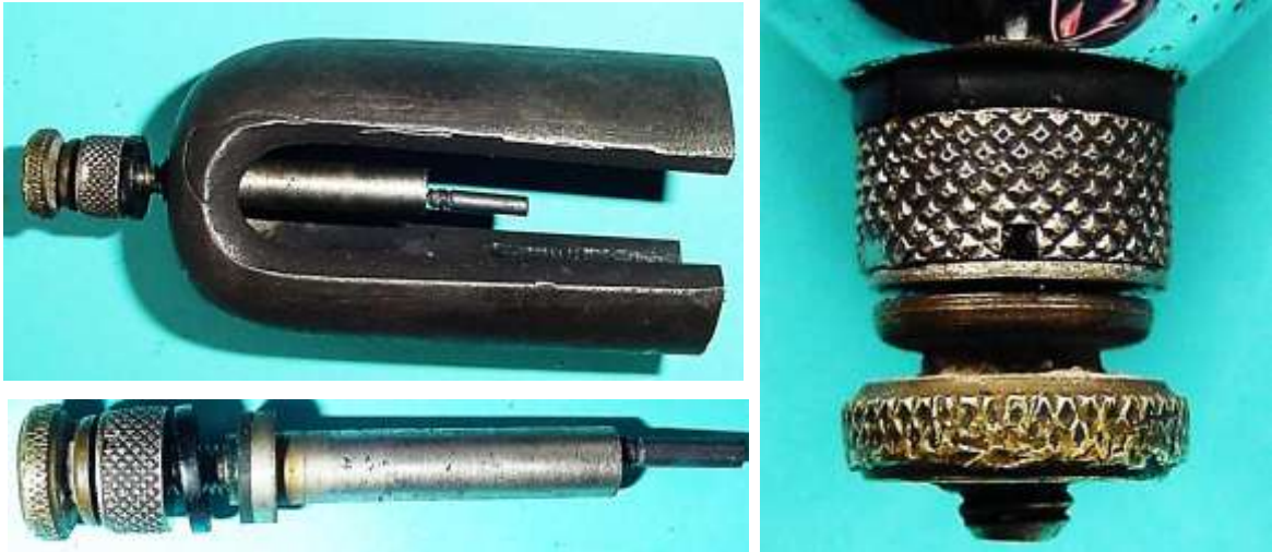
Bild 2.9: Anordnung und Gestaltung des Spannung führenden Kontakts
