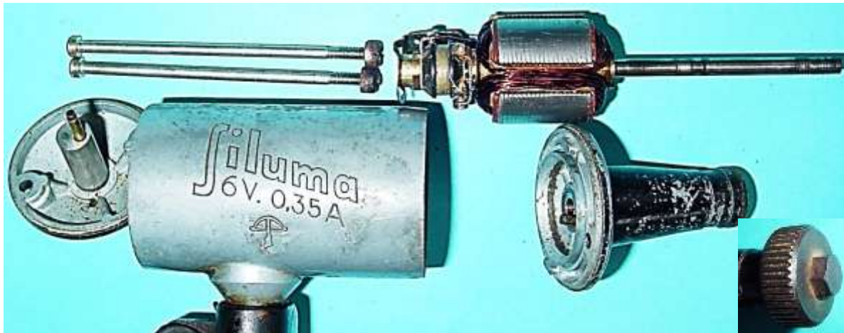
Bild 4.7: Baugruppen: Reibrad, Lagerhals, Anker mit Fliehkraftschalter, Gehäusemantel, Boden und Spannbolzen
