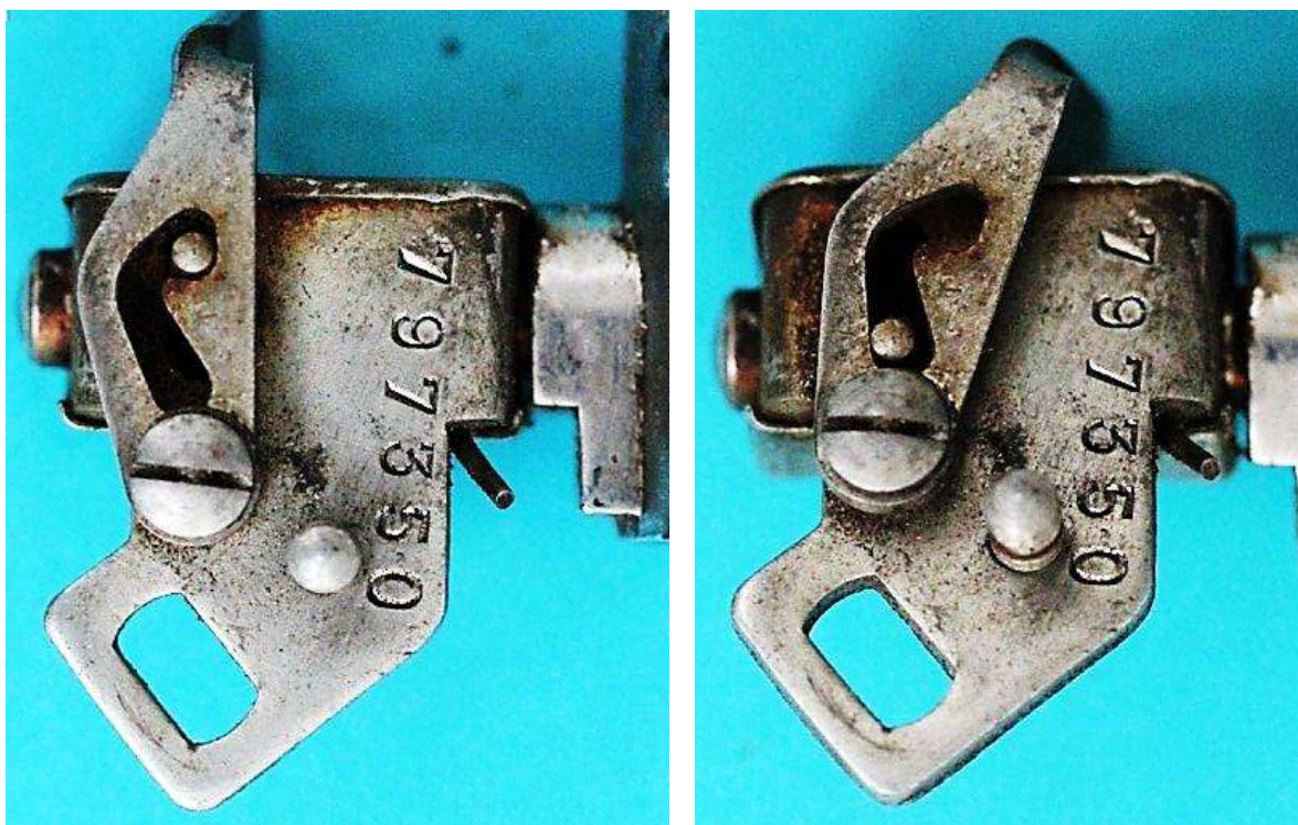
Bild 7.5: Bedienungshebel mit der Fertigungsnummer: 797350: a) Ruhestellung . b) Betriebsstellung
