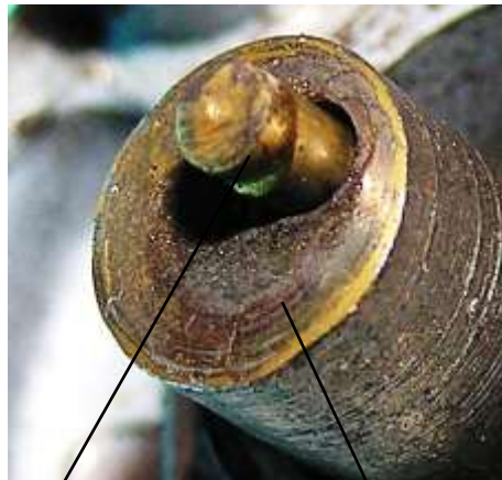
Bild 3.9: Spannung führender Schleifkontakt: a) Beweglicher Kontaktring, b) Schleifkappe, c) Bürste, d) Bürstenhalter
