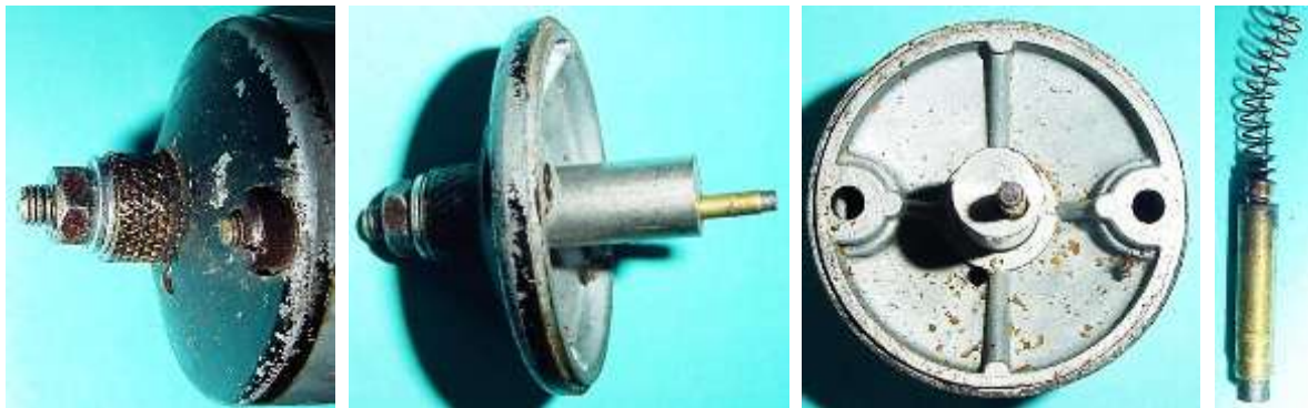
Bild 4.13: Boden mit Bürste und Kabelanschluss
