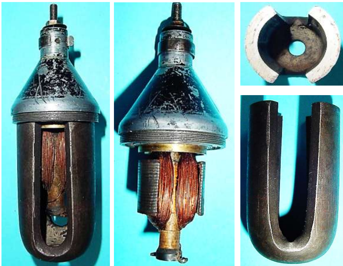
Bild 2.3: Erregersystem und Anker mit Lagerhals
