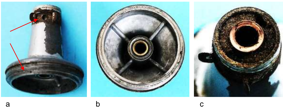
Bild 5.6: Lagerhals: a) Verschließbares Ölloch und Außengewinde, b) Stege des Lagerdoms, c) Öldepot
