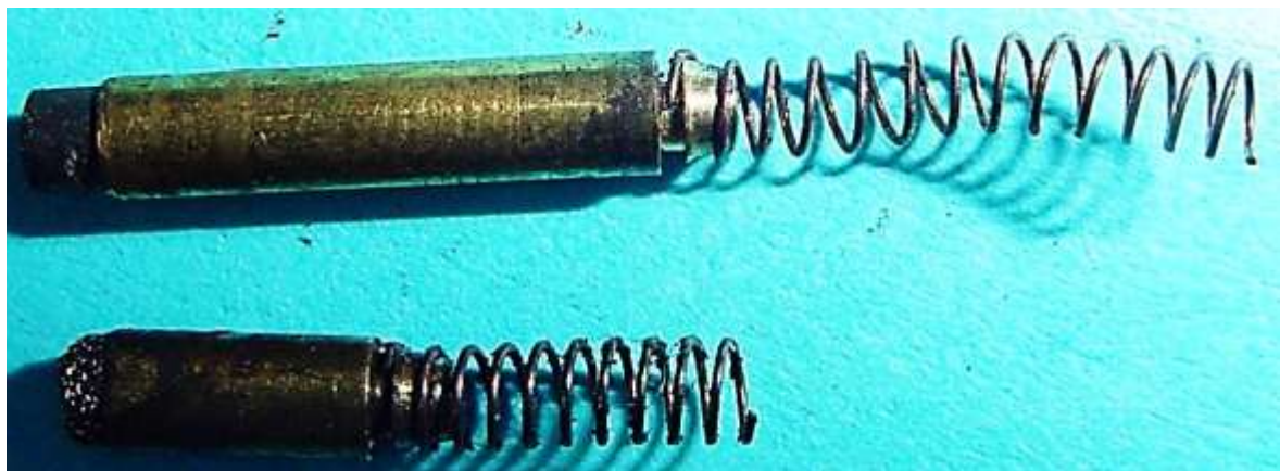
Bild 4.14: Spannung führende Bürste (oben) und Massebürste (unten)
