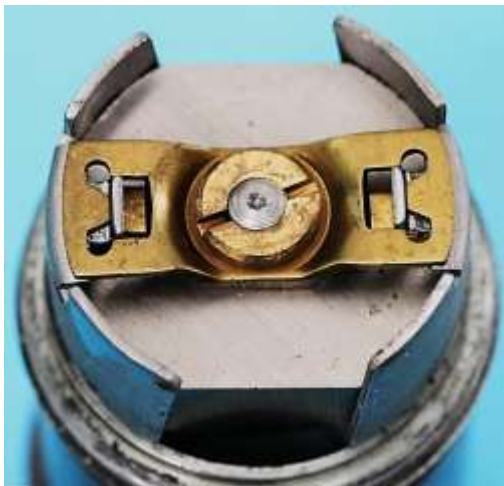
Bild 5.10: Befestigung des unteren Stegs mit einer Schlitzmutter
