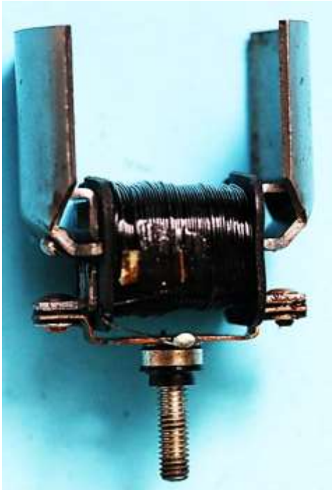
Bild 5.11: Zweipoliger Blätterpolanker mit einem dreiteiligen Ankereisen
