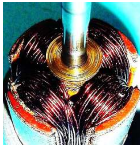
Bild 4.17: Wicklungsausführung: a) Lagenwicklung im Siluma 011470, b) Drahtknäuel im Siluma 254036
