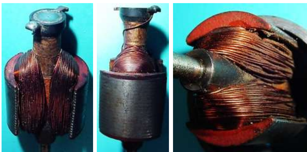
Bild 2.6: Gleiche Gestaltung der Wicklungsköpfe auf beiden Seiten des Ankers
