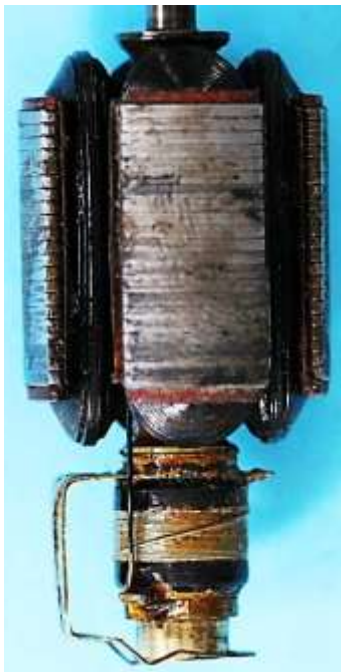
Bild 3.10: Aufbau des Flihkraftreglers: a) Anker mit Flihkraftregler, b) Flihkraftregler
