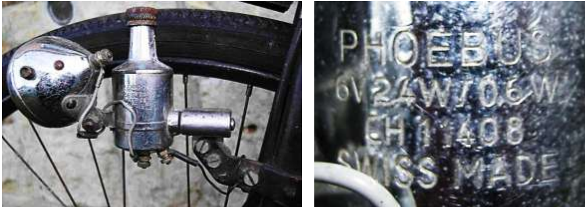
Bild 1.5: Phöbus-Dynamo mit eingepprägten Firmen- und Leistungsdaten
