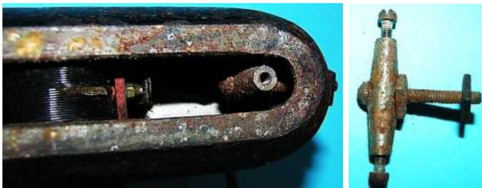
Bild 1.5: Konstruktionsteil zur Befestigung der Pollückenbleche
