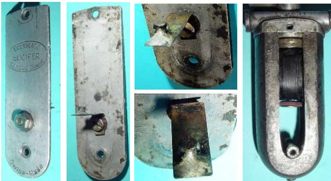
Bild 3.5: Abdeckung der Pollücke mit dem Spannung führenden Kontakt
