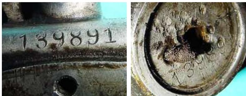
Bild 3.2: Kennzeichnung des Dynamos mit der Nummer 139891: a) am Lagerhalsfuß und b) auf dem Bürstenhalter des Massekontakts
