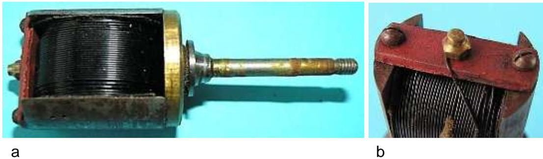
Bild 2.14: Anker (Pollänge 27,2 mm, Durchmesser 26,2 mm): a) Doppel-T-Anker mit Welle, b) Isoliersteg mit Schleifkontakt
