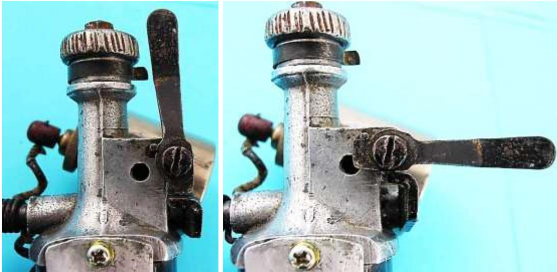
Bild 6.6: Stellung des Handhebels in den beiden Betriebsarten
