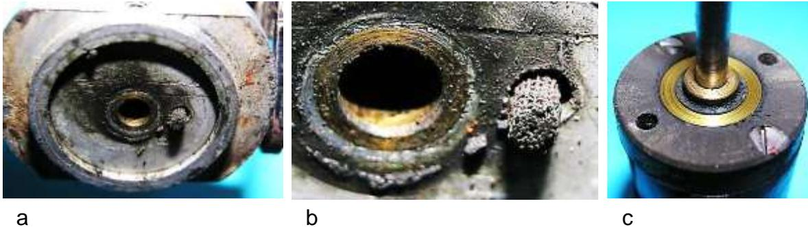
Bild 4.9: Massekontakt: a) Bund zur Positionierung des Magneten, b) Gleitlager und Kupfergewebebürste im Lagerhalsfuß, c) Schleifbahn auf dem Ankerflansch
