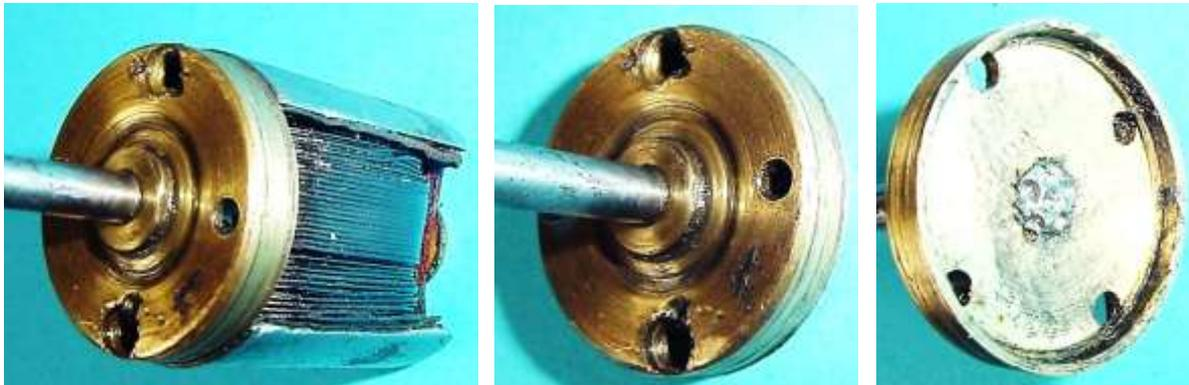
Bild 3.9: Kappe zur Befestigung des Ankers an der Welle
