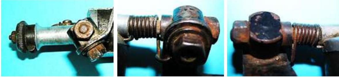
Bild 4.6: Druckfeder mit den Einspannstellen an der Halterung und am Lagerhals
