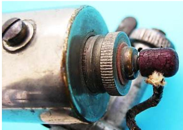
Bild 6.11: Lampenanschluss
