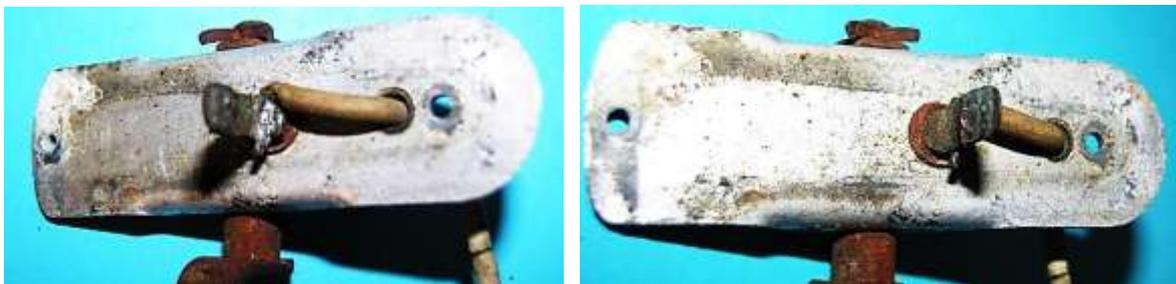
Bild 1.12: Innenseite des Pollückenblechs mit dem Schleifkontakt und dem Kabelanschluss
