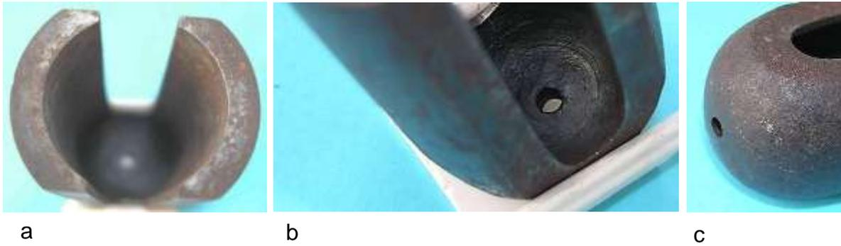
Bild 2.8: Tulpenmagnet: a) Gekrümmte Polflächen, b) Innenansicht des Jochs mit Bohrung, c) Außenansicht des Jochs
