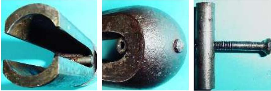
Bild 3.3: Positionierung des Rohrs mit Innengewinde zur Befestigung der Pollückenbleche
