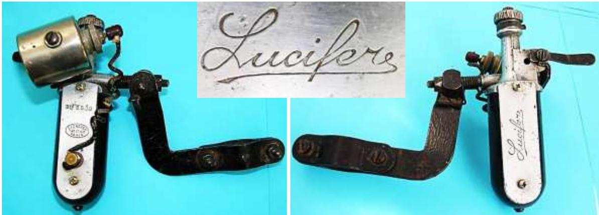
Bild 6.1: Dynamo-Lampen-Kombination von Lucifer mit Halterung
