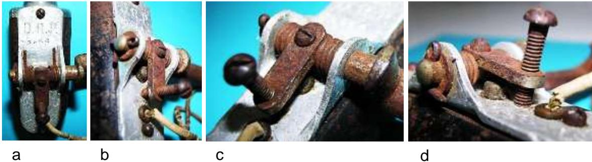
Bild 1.8: Funktionsprinzip der Kippvorrichtung: a) Konstruktive Anordnung der Kippvorrichtung, b) Kippvorrichtung und Kabelauführung, c) Druckfeder und Verstellhebel, d) Verstellschraube zur Einstellung der Betriebsstellung
