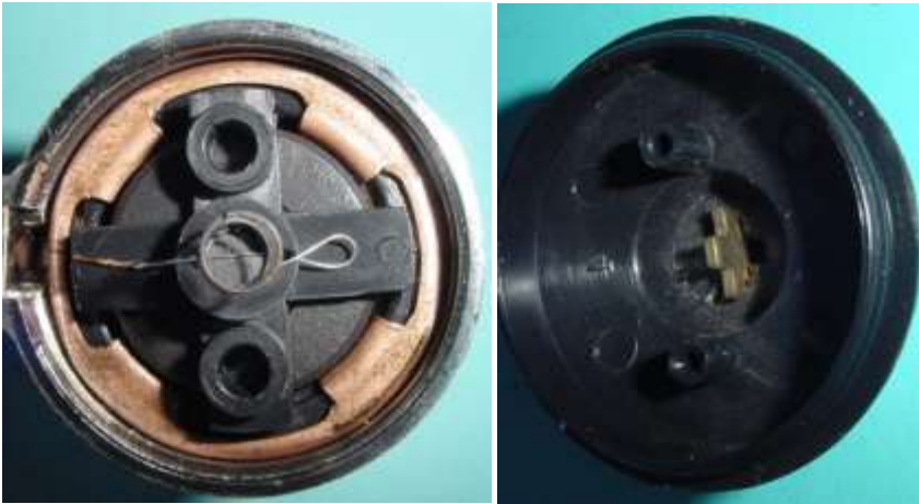
Bild 1.25: Kabelanschluss a) Kreuzförmiger Kontaktsteg mit Feder b) Kabelanschlussblech
