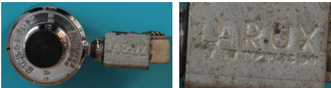
Bild 1.10: Beschriftungen auf der Abdeckung der Kippvorrichtung: a) Ansicht des Dynamos von oben, b) LARUX, 6 V, 3 W, Typ MUSOO
