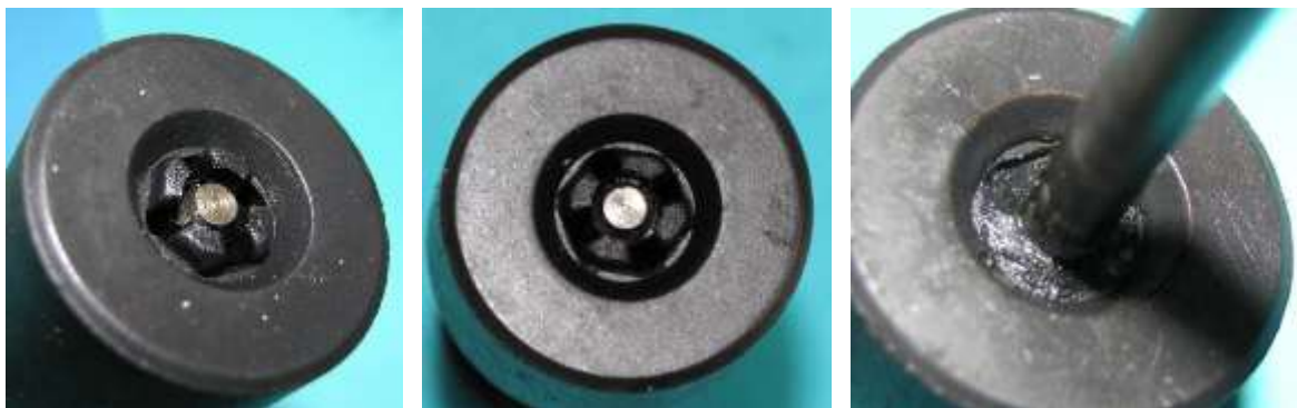
Bild 1.8: Mit einer Kunststoffbuchse eingefügt Welle: a) Gegliedertes Kunststoffteil, b) Sechseckiger Innenraum des Magneten, c) Stabilisierter oberer Bereich
