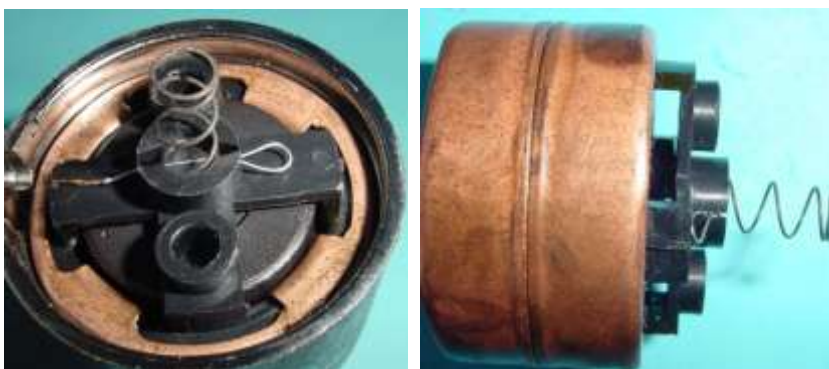
Bild 1.24: Schraubenfe- der für die Stromlei- tung zum Kabelanschluss
