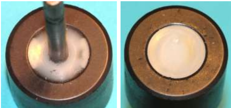
Bild 1.7: Mit Kunstharz eingegossene Welle a) Obere Stirnseite b) Untere Stirnseite
