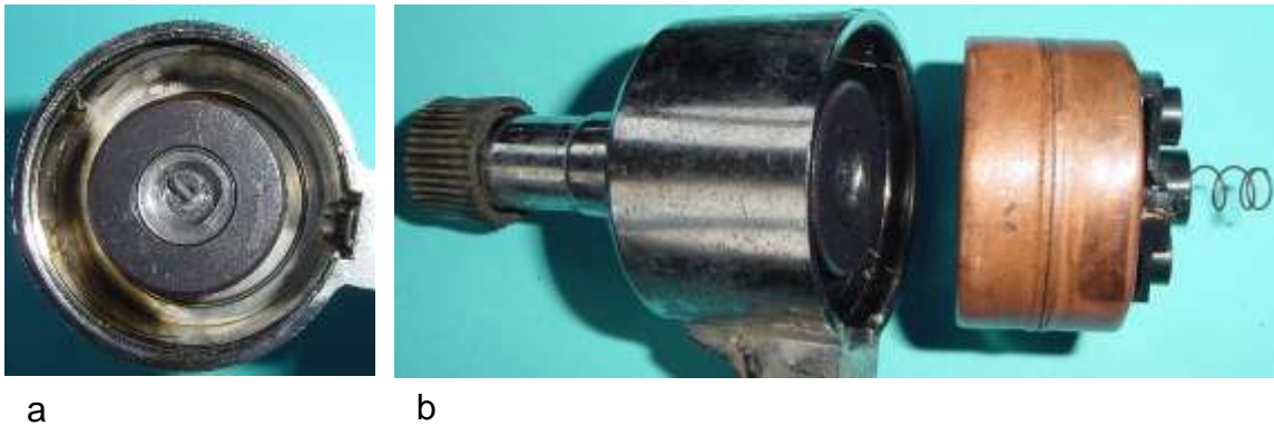
Bild 1.18: Baugruppen des Dynamos: a) Lagerhals mit Polrad, b) Anker vor dem Einbau ins Gehäuse
