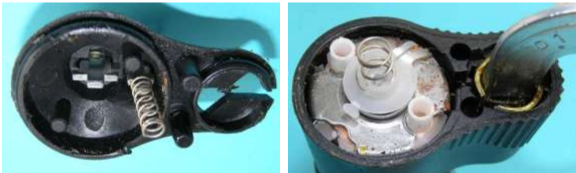
a b Bild 2.7: Stromführende Schraubenfedern: a) Kontaktbleche und Massekontaktfeder , b) Eingesetzter Anker mit Spannung führender Feder.
