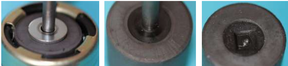
Bild 1.6: Polrad: Axiale Länge 21 mm, Durchmesser 26 mm, Gewicht 57 g: a) Polrad mit Anlaufscheibe, b) Obere Stirnfläche, c) Untere Stirnseite
