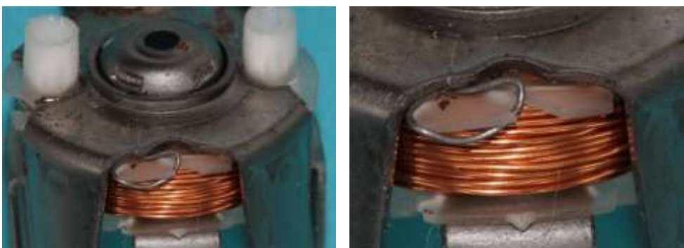
Bild 2.14: Massekontakt mit einem Klauenpolring
