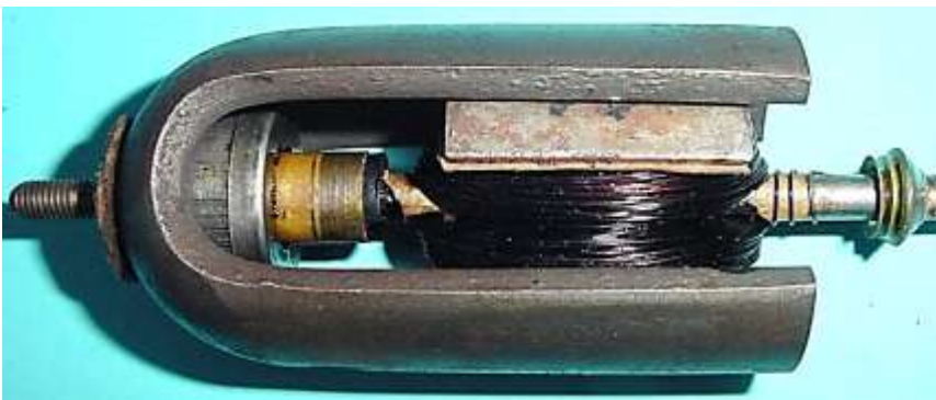
Bild 1.12: Axiale Position des Ankers im Polsystem
