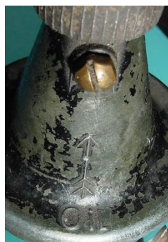
Bild 2.2: Reibrad und Ölschraube
