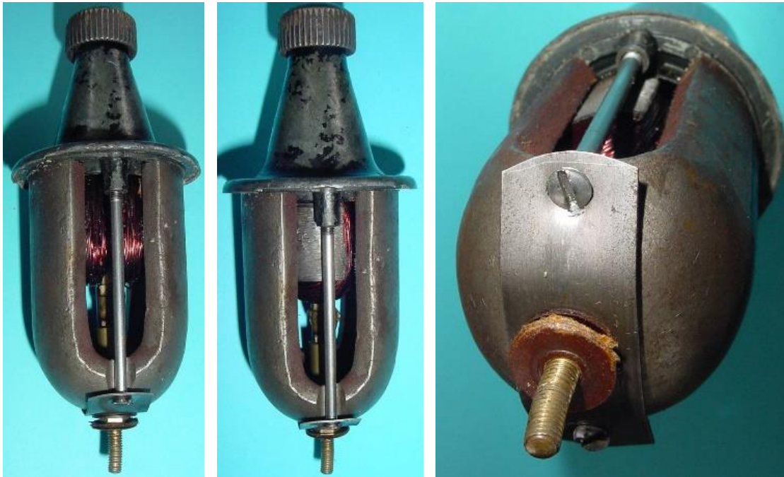
Bild 2.5: Befestigung des Dauermagneten am Lagerhals
