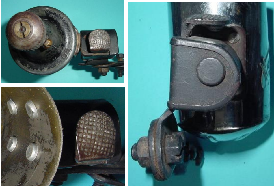
Bild 2.3: Fußhebel und Befestigung der Kippvorrichtung
