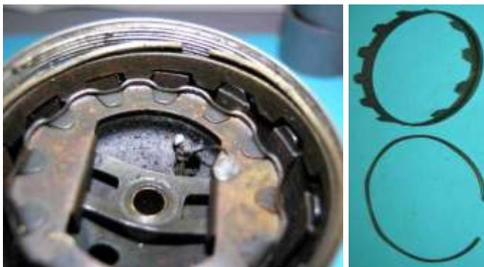
Bild 4.18: Pollückenschablone und offener Federring zur Sicherung der Schablonenposition
