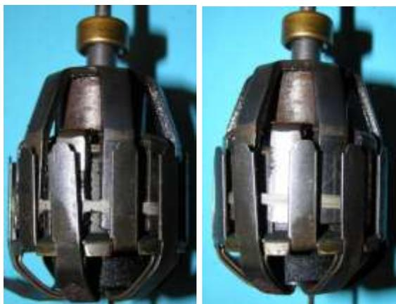
Bild 4.7: Zwei ausgewählte Stellungen des Polrades im Luftspalt, Zusammensetzung des Magnetmaterials:
