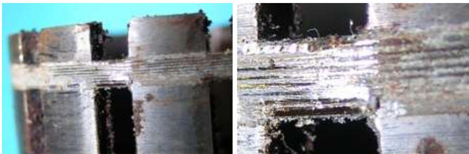
Bild 4.4: Verzinnete Stahldrahtbandage
