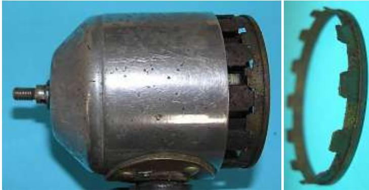
Bild 2.15: Stabilisierungsrings zur Fixierung der Pollücken
