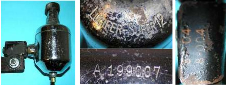
Bild 4.2: Beschriftungen auf dem Lagerhalsfuß, dem Gehäusemantel und der Abdeckung der Druckfeder
