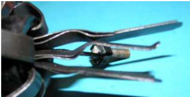
Bild 4.14: Durchführung der langen Polbleche durch die Spule
