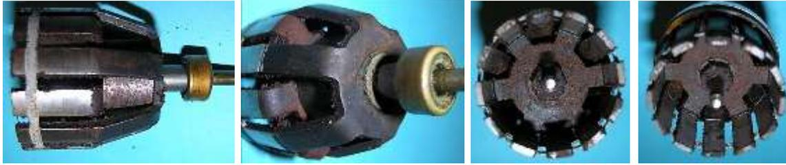
Bild 4.5: Klauenpolsystem des Läufers mit zweipoligem Dauermagneten
