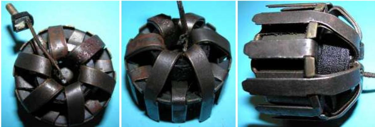
Bild 1.2: Anker mit Spreizpolen
