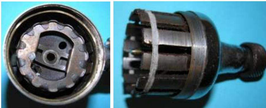
Bild 4.3: Gehäusetopf mit Anker und Lagerhals mit Läufer
