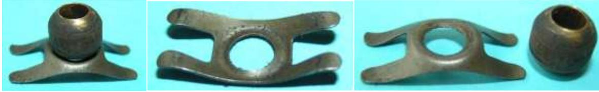
Bild 4.16: Unteres Kalottenlager
