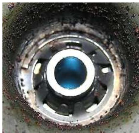
Bild 2.8: Kalottenlager im Lagerhals
