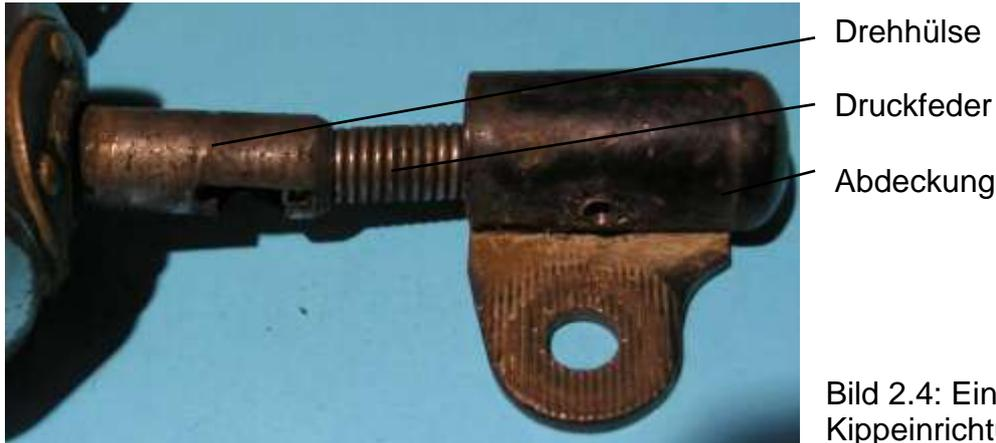
Bild 2.4: Einzelteile der Kippeinrichtung
