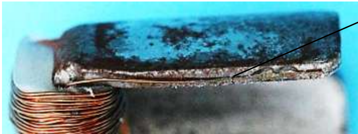
Bild 5: Kontaktierung der Spulenanschlüsse
