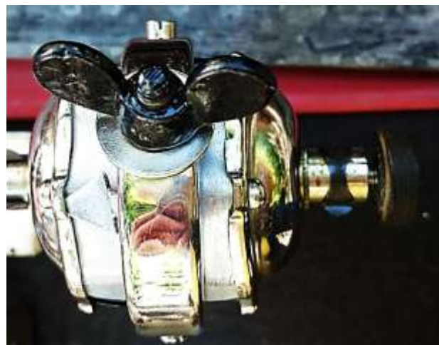
Bild 3.2: Gelenkige Aufhängung: a) Ansicht des V-Magneten mit Haltebügel b) Haltebügel und Flügelmutter
