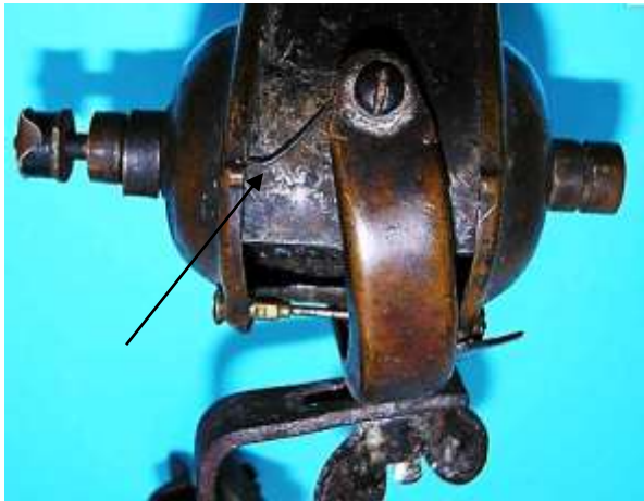
Bild 2.16: Drahtfedern zur Realisierung der Kippbewegung nach oben: a) Betriebsstellung, b) Ruhestellung
