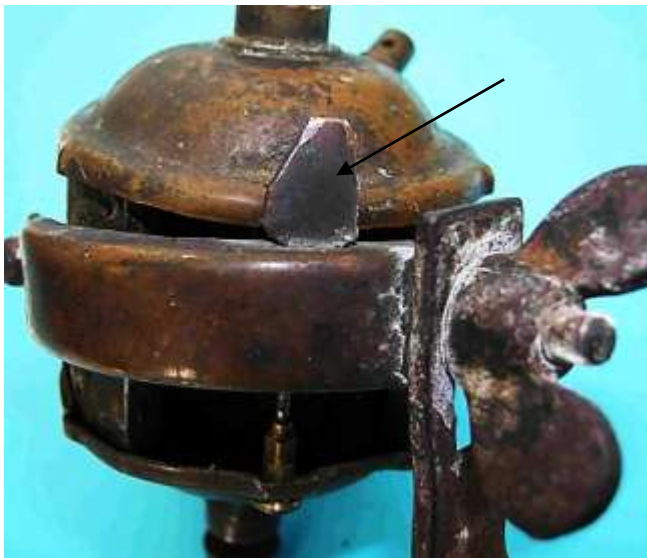
Bild 2.17: Halteplättchen: a) Betriebsstellung, b) Arretierung des Dynamos in der Ruhestellung
