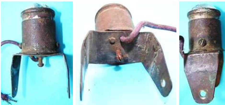
Bild 2.2: Lampe: a) Lampe mit Halter, b) Massekontakt, c) Seitenansicht
