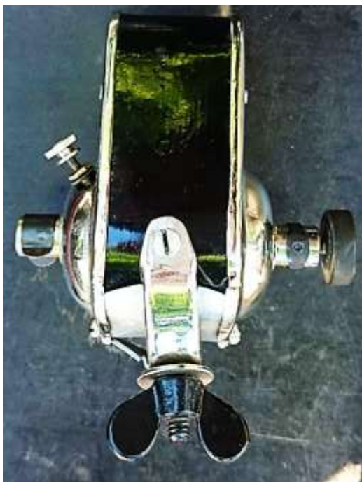
Bild 3.2: Gelenkige Aufhängung: a) Ansicht des V-Magneten mit Haltebügel b) Haltebügel und Flügelmutter
