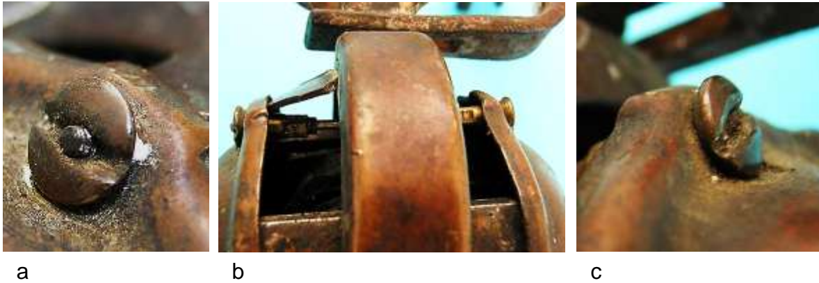
Bild 2.8: Spannstab: a) und c) Speichennippel, b) Lage des Spannstabs in der Pollückenmitte
