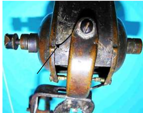
Bild 2.16: Drahtfedern zur Realisierung der Kippbewegung nach oben: a) Betriebsstellung, b) Ruhestellung
