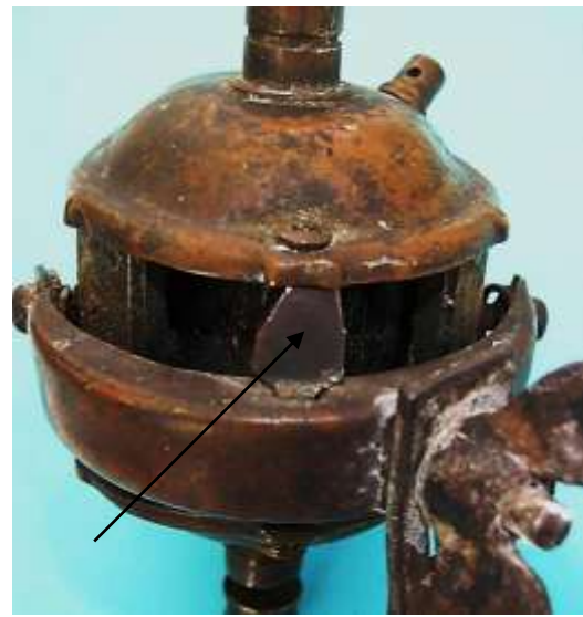
Bild 2.17: Halteplättchen: a) Betriebsstellung, b) Arretierung des Dynamos in der Ruhestellung
