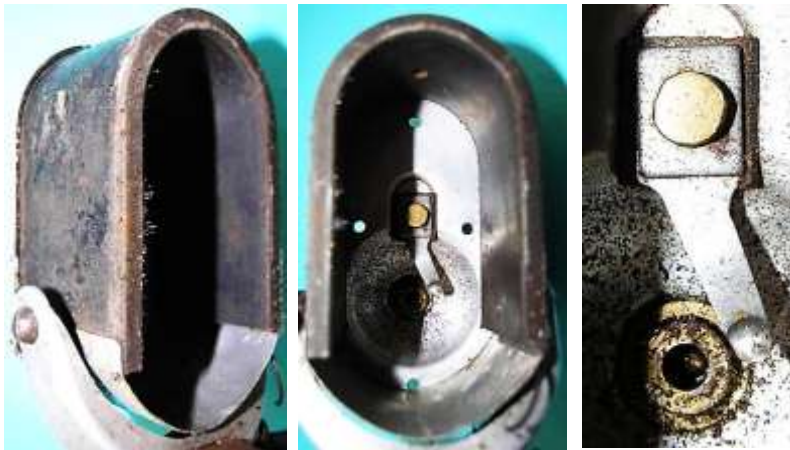
Bild 4.4: Hufeisenmagnet mit gewölbtem Stirn- oder Pollückenblech und mit der Blattfederbürste
