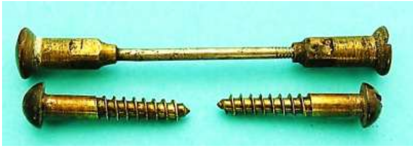
Bild 2.7: Holzschrauben und Spannstab zur Befestigung der Lagerschilde
