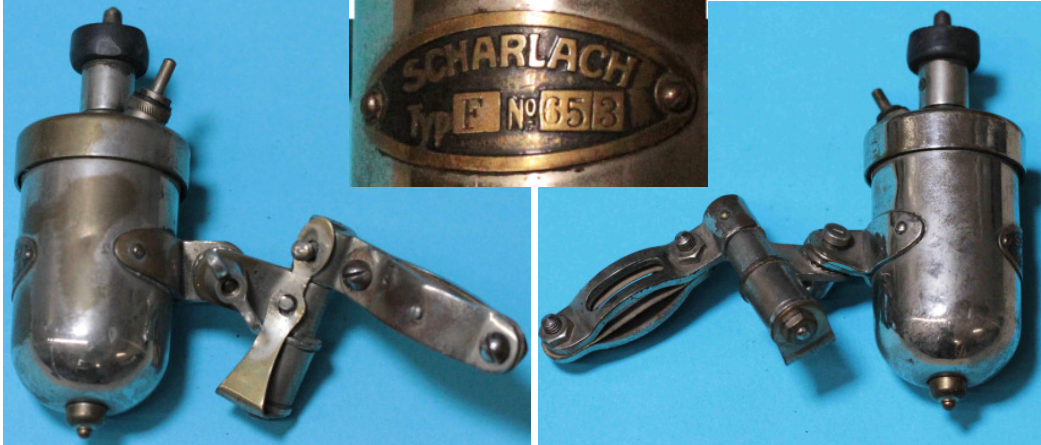
Bild 1.5: Scharlach 65/3 mit rotierendem Magneten
