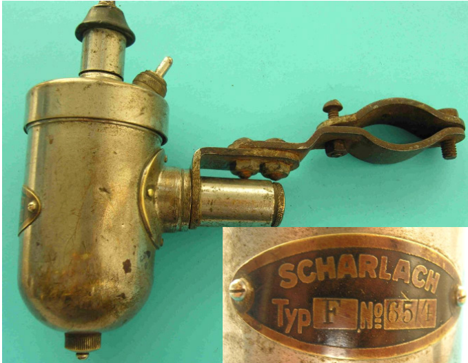
Bild 1.6: Scharlach 53907 Typ F No 65/4, rotierender Magnet
