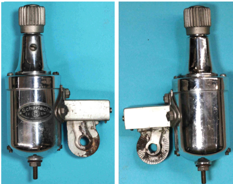
Bild 1.37: Doppelter Flansch und rechteckige Abdeckung
