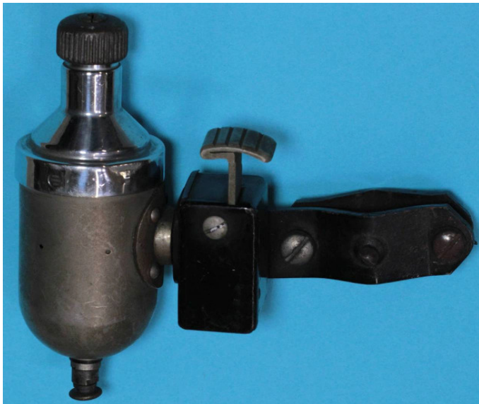
Bild 1.22: Kippvorrichtung, die durch identische Bedienung des Fußpedals sowohl die Ruhestellung als auch die Betriebsstellung auslöst
