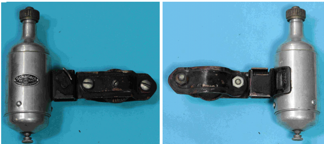
Bild 1.32: Vernietetes Gehäuse 1,8 W
