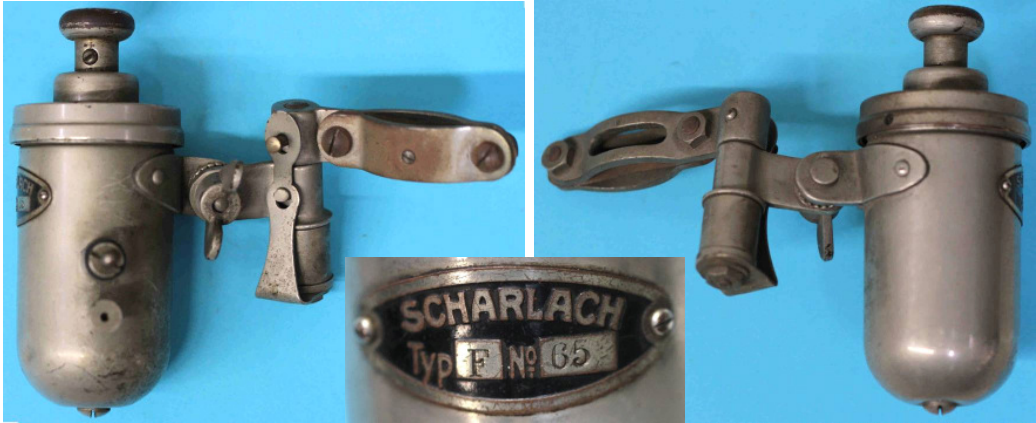
Bild 1.3: Scharlach F 65, rotierender Anker mit Spannungsregler
