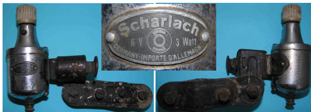
Bild 1.35: Vierpoliger Dynamo mit zweipoligem Dauermagneten der Firma „Otto Scharlach“ aus Nürnberg, Nr 769452
