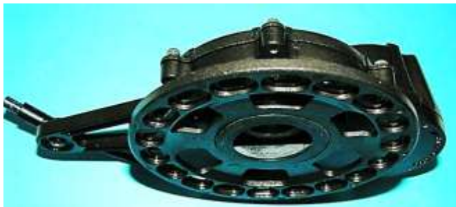
Bild 4: Position der Schellen: a) Angeschraubte Schellen, b) Speichenseite ohne Schellen
