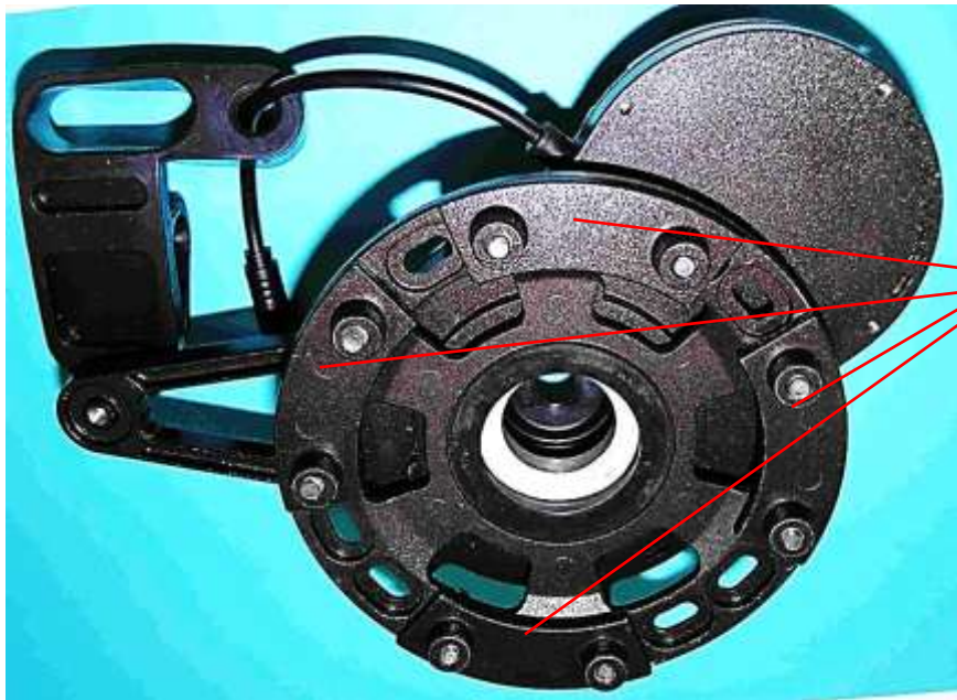
Bild 3: Speichenseite mit vier Schellen zur Befestigung an den Speichen
