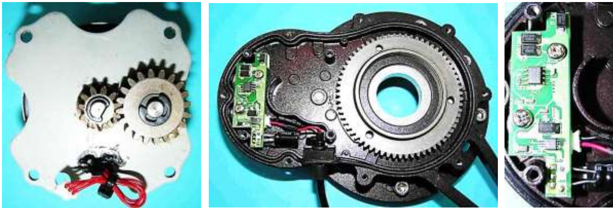
Bild 10: Gleichrichter und Getriebe: a) Bestückte Leiterkarte, b) Getriebeendstufe, c) Wellenritzel und Getriebezwischenstufe
