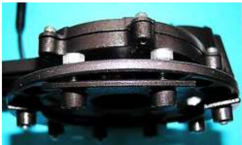
Bild 4: Position der Schellen: a) Angeschraubte Schellen, b) Speichenseite ohne Schellen
