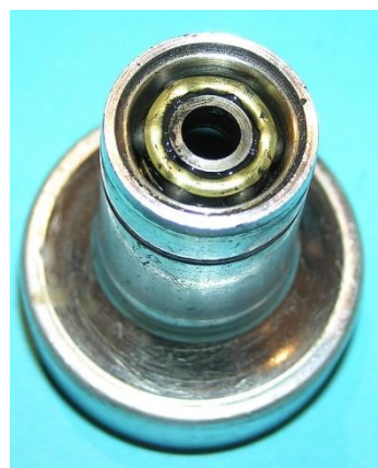
Bild 2.28: Lagerhals mit zwei Kugellagern: a) Unterer Kugellagerring, b) Oberes Kugellager, c) Lagerhals mit Welle
