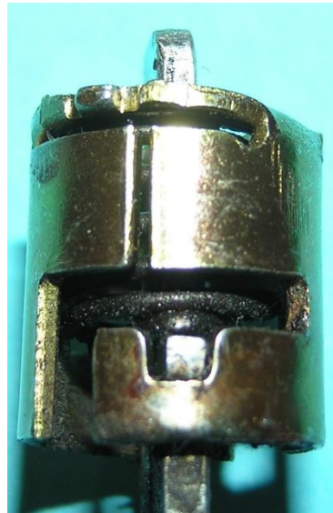
Bild 3.29: Eingriff des Sperrstifts auf beiden Seiten des Kulissenzylinders in der Ruhestellung
