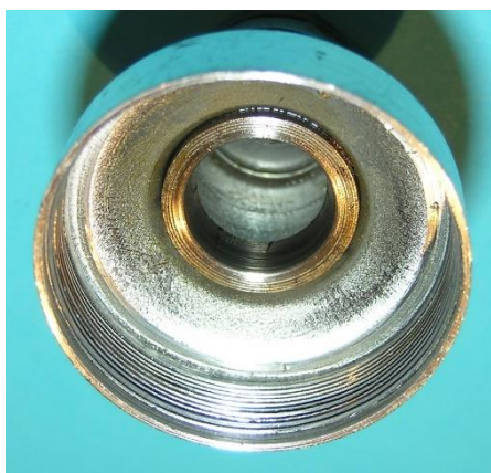
Bild 2.28: Lagerhals mit zwei Kugellagern: a) Unterer Kugellagerring, b) Oberes Kugellager, c) Lagerhals mit Welle
