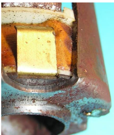
Bild 2.15: Spulenanschlüsse: a) Scheinwerferkontakt, b) Rücklichtkontakt, c) Masse
