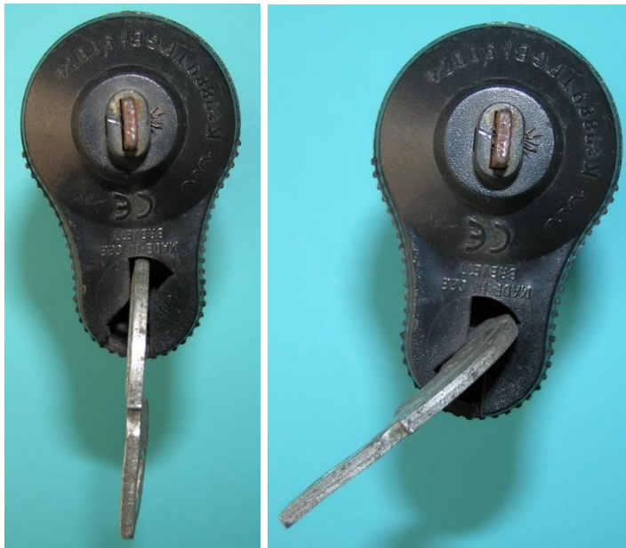
Bild 3.25: Verdrehung des Dynamokörpers: a) Ruhestellung, b) Betriebsstellung
