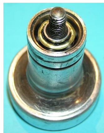
Bild 2.28: Lagerhals mit zwei Kugellagern: a) Unterer Kugellagerring, b) Oberes Kugellager, c) Lagerhals mit Welle
