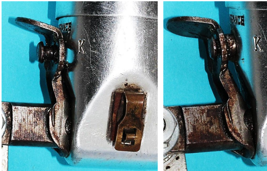
Bild 2.18: Stellungen des Bedienungshebels: a) Ansicht der Ruhestellung mit dem Rücklichtanschluss, b) Betriebsstellung
