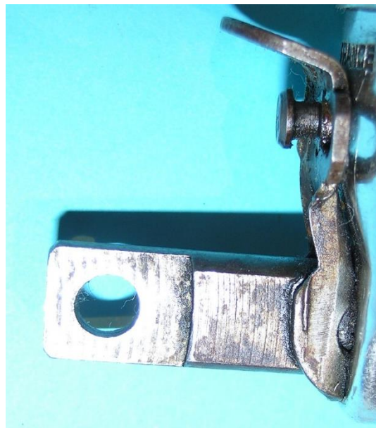
Bild 2.2: Abgesetztes Drehbolzenende beim Typ T
