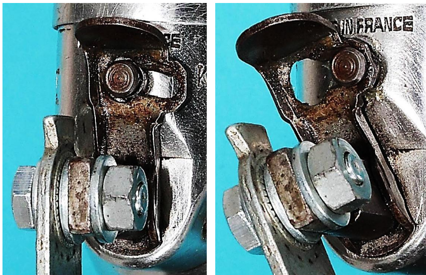
Bild 2.19: Positionen des Sperrstifts in der Kulisse des Hebels: a) Ruhestellung b) Betriebsstellung, c) Ausnehmungen im Bedienungshebel
