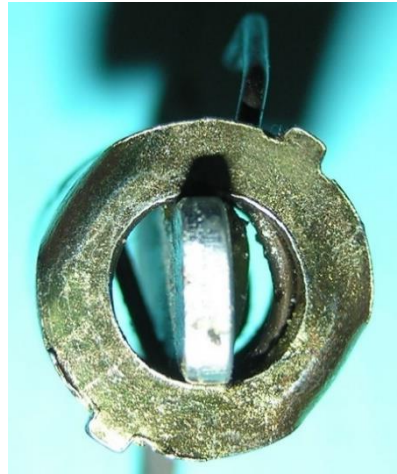
Bild 3.28: Führung des Stanzteils im Kulissenzyylinder: a) Halterarm am unteren Rand b) Drehbolzen am oberen Rand
