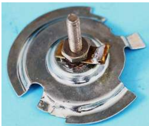
Bild 1.8: Spannung führender Anschluss: a) Kabelbolzen mit Lötstützpunkt, b) Oberseite der Kontaktplatte mit isoliert eingesetztem Kabelbolzen
