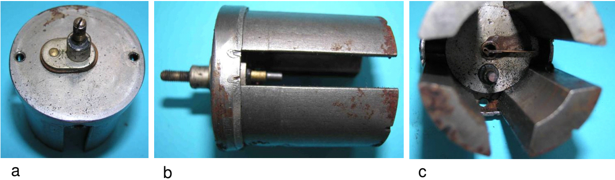
Bild 1.6: Erregersystem mit Schleifkontakten: a) Joch mit Spannung führendem Kontakt, b) Vier Stabmagnete mit Joch, c) Spannung führende Kohlebürste und Flachfeder zur Masseverbindung
