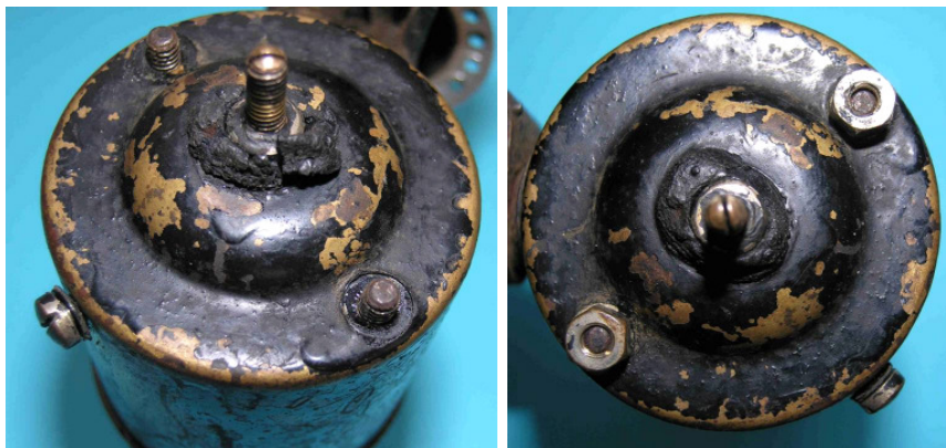
Bild 1.4: Befestigung des Gehäusetopfes durch Muttern auf den Gewindebolzen
