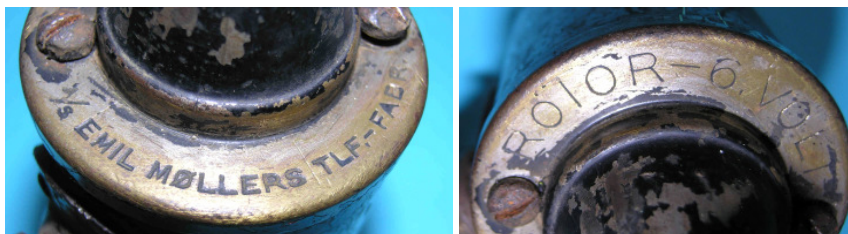
Bild 1.2: Beschriftung auf dem Lagerhalsfuß: A/S Emil Moellers TLF.-FABR., ROTOR - 6 VOLT
