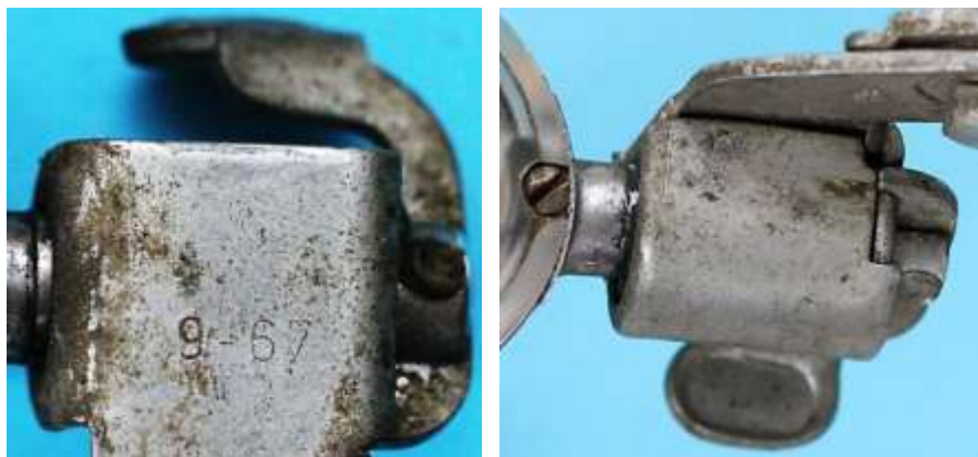
Bild 3.13: Kippvorrichtung: a) Rückseite mit dem Fertigungsdatum 9-67, b) Unterseite der Kippvorrichtung mit eingerastetem Bedienungshebel
