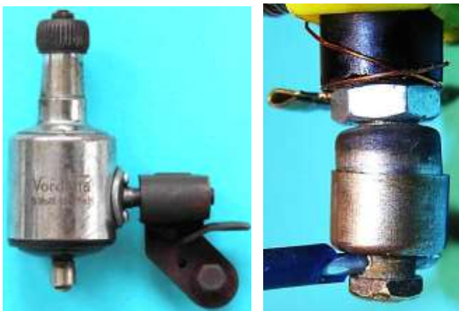
Bild 3.21: Dynamomarkte „Vordana“ mit der Federdruckklemme des Dansi-Musters 4
