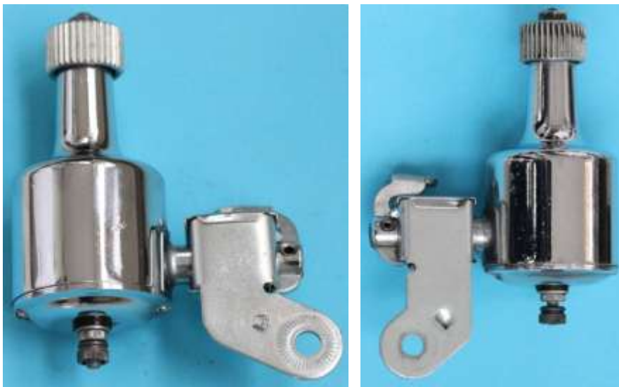
Bild 3.26: Vergleich der Halterarme: a) Muster 2, 3, 4 u. 6 b) Muster 5
