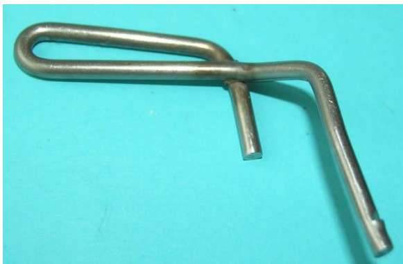
Bild 4.53: Bedienungshebel ist aus 3 mm starkem Stahldraht gebogen und an der Kreuzung verschweißt
