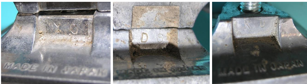
Bild 4.2: Kennzeichnung der Ausführungen mit zwei Buchstaben: a) YO, b) DS, c) KU
