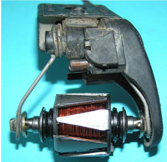
Bild 4.114: Einspannung des Ankers zwischen den Druckfedern: a) Ohne Lagerschalen des Polrades, b) Mit einer Polradlagerschale
