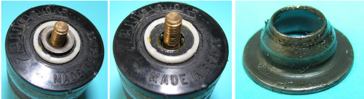
a b c Bild 4.45: Lagerkonus auf der Achse: a) Montiertes Kugellager, b) Rand der Teflonlagerschale, c) Lagerkonus zum Aufpressen auf die Ankerachse
