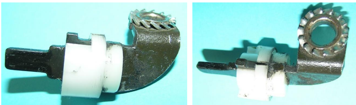
Bild 4.37: Drehbolzen mit dem Halterarm und einem Passstück für den Achsgabelschenkel und für das Gehäuse der Kippvorrichtung
