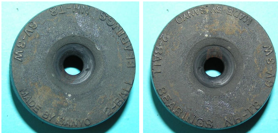
Bild 3.5: Laufringbeschriftungen; Made by Sanyo, 2-ball bearings, NH-T8, 6 V, 3 W
