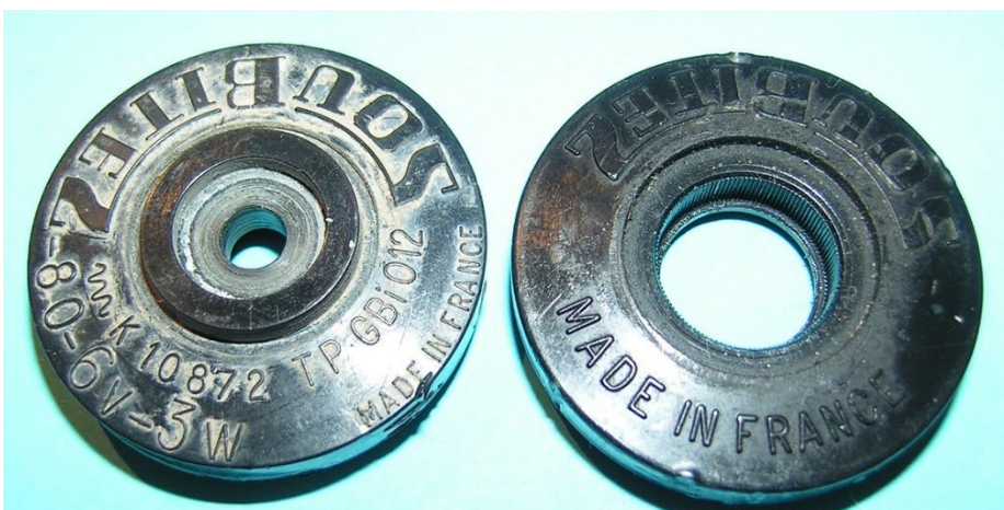
Bild 4.44: Lagerschilder: a) Mit Gleitlager, b) Mit Kugellager
