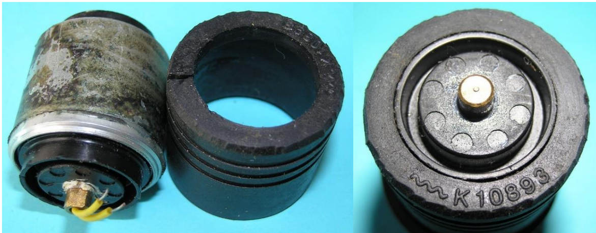
Bild 3.27: Generator mit Gummikappe: a) Glatte Walzenoberfläche, b) Aufgeschnittenes Gummirohr mit , c) Stirnseite des Ankers mit der K-Nummer K 10893
