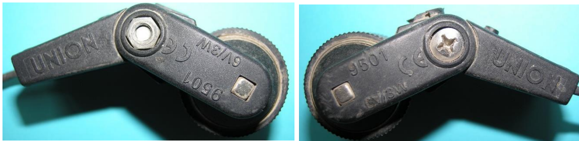
Bild 4.88: Gleiche Beschriftung der Seiten mit dem Markennamen, dem CE-Zeichen, der Typennummer und den Nenndaten
