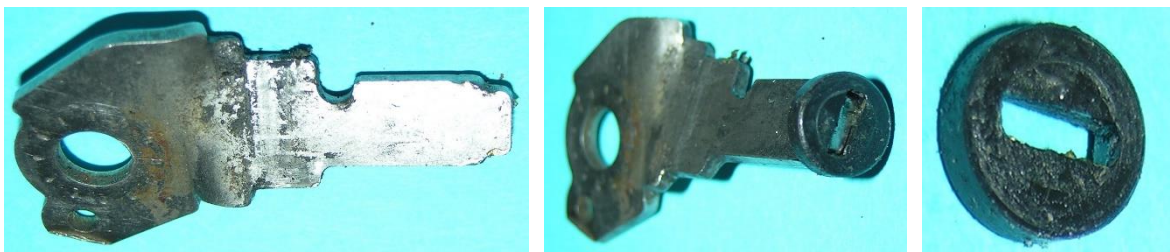
Bild 3.13: Drehbolzen und Halterarm: a) Blechschnitt, b) Position der Justierscheibe auf dem Drehbolzen, c) Geschlitzte Justierscheibe
