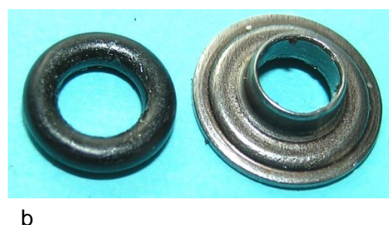
Bild 4.111: Kunststoffadapter, ein Teil der Ankerachse a) Metallhülse mit Krempe auf dem Adapter b) Gummiring und Lagerschild c) Gummiring und Lagerschale auf der Metallhülse
