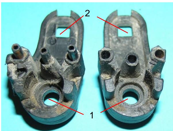
Bild 4.95: Bauteile der Basisgabel: a) Ansicht der inneren Strukturen, b) Demonstration des Aneinanderfügens der zwei gleichen Kunststoffteile, 1- Passungen für das Drehrohr, 2- Viereckige Durchbrüche für die Ankerachse, 3- Passstifte
