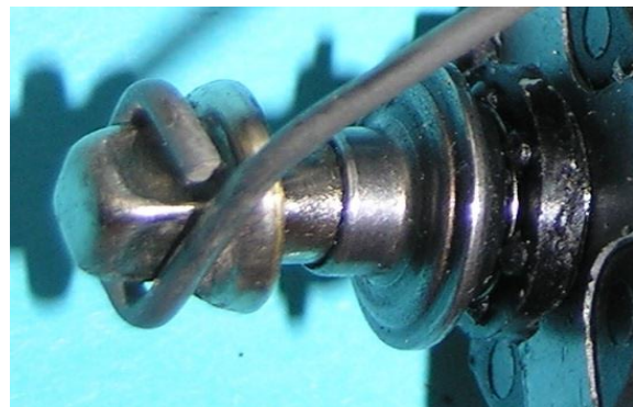
Bild 4.113: Stromfluss von der Metallhülse durch die Staubkappe zur Druckfeder
