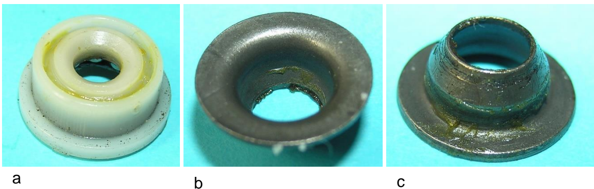
a b c Bild 4.47: Lagerschalen: a) Im Lagerschild eingepresste Seite der Teflonlagerschale, b) Anlagefläche zur Staubkappe, c) Konus
