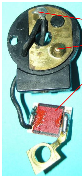
Bild 3.18: Überspannungsschutz und Ankerwicklungsanschluss a) Eingebaute Kontaktplatte b) Anschlüsse der Ankerspule und des Überspannungsschutzes
