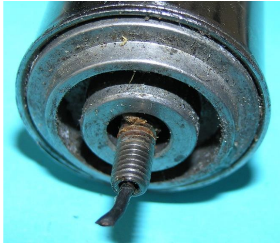
Bild 3.19: Befestigung der Generatorachse am Montageschild: a) Befestigung des Kabelschuhs der Zener-Diode auf der Generatorachse, b) Lagerschild des Generators
