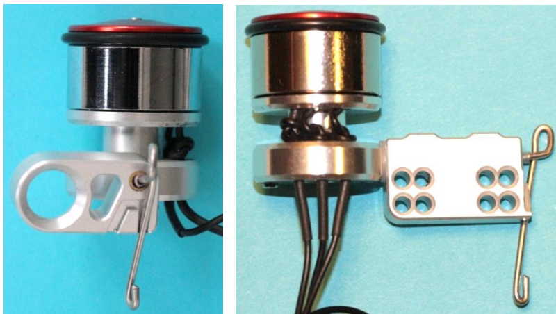
Bild 5.8: Felgendynamo: a) Mit Bremssockeladapter b) Mit Rahmenstrebenadapter
