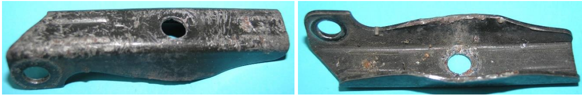
Bild 4.27: Halter aus 1,5 mm starkem Blech geformt
