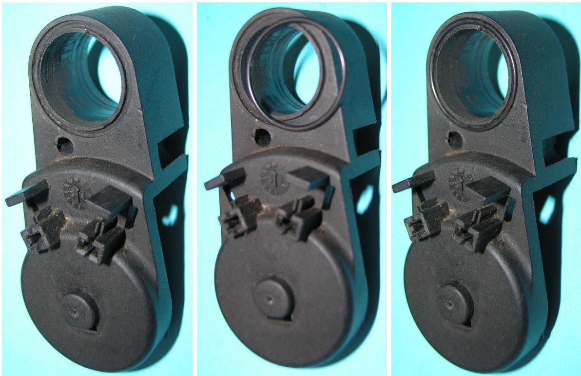
Bild 4.66: Schenkel der Achsgabel mit O-Ring: a) Umlaufende Nut, b) Einzulegender O-Ring, c) Eingepasster O-Ring
