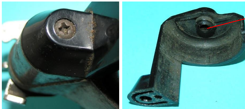
Bild 3.7: Achsenhalter: a) Am Montageschild angeschraubter Achsenhalter, b) Achsenhalter,
