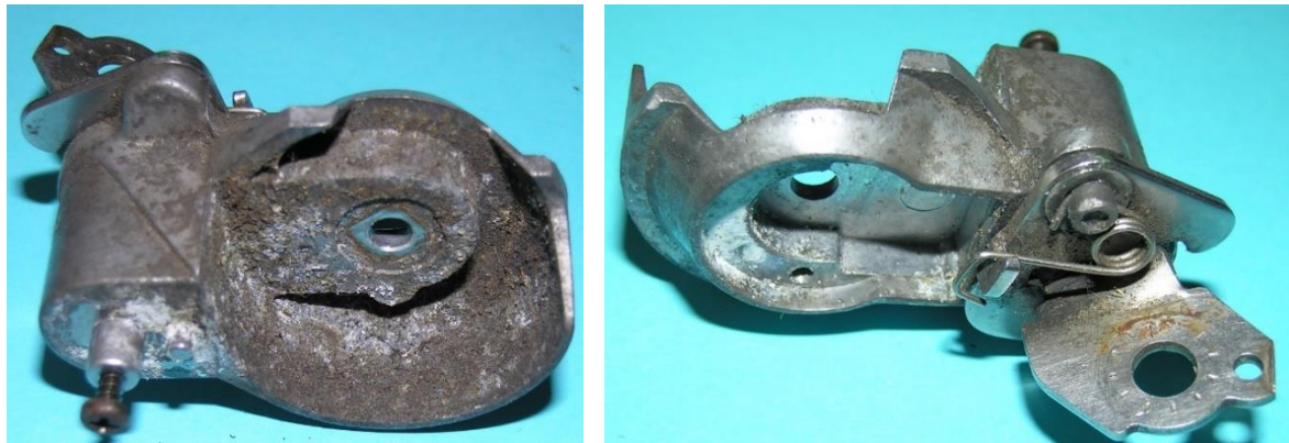
Bild 3.8: Montageschild mit Kippvorrichtung: a) Generatorseite, b) Bodenseite
