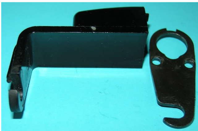
Bild 4.29: Zwei Teile der Achsgabel: a) Abgewinkelter Schenkel mit dem Gehäuse der Kippvorrichtung, b) Achsgabelschenkel
