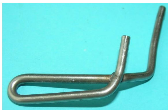
Bild 4.53: Bedienungshebel ist aus 3 mm starkem Stahldraht gebogen und an der Kreuzung verschweißt
