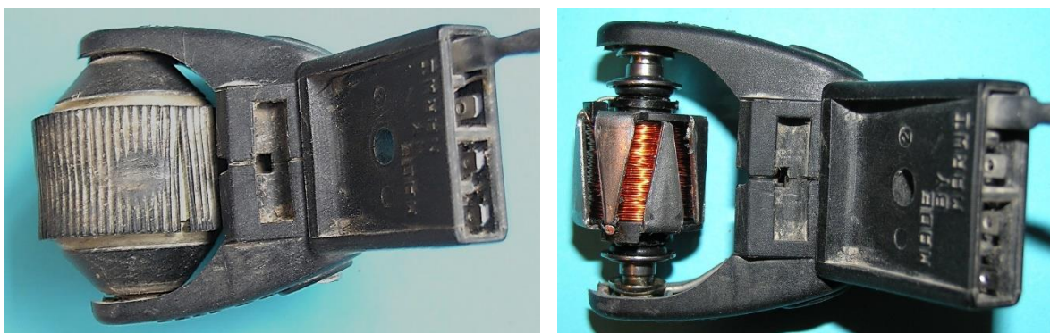
Bild 4.91: Dynamokörper: a) Walze mit Gummimanschette, b) Anker zwischen zwei Halterarmen verdrehsicher eingespannt
