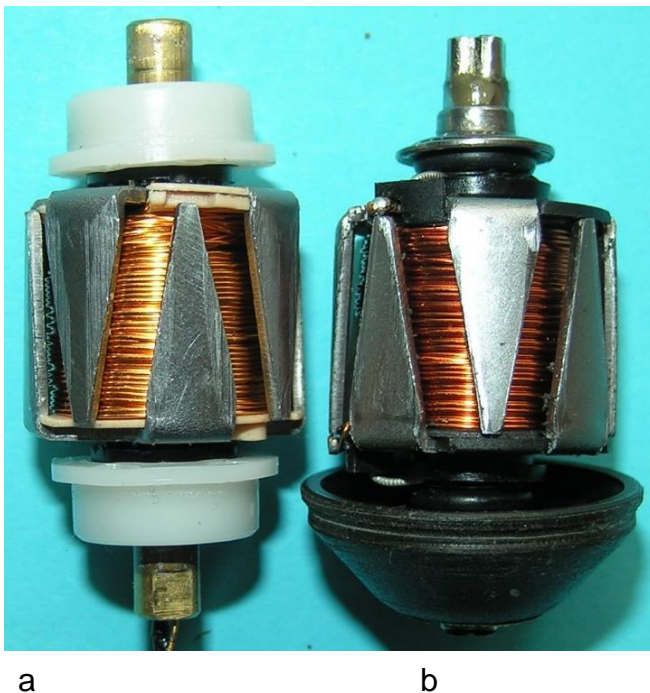
Bild 4.104: Vergleich der Klauenpolanker: a) K 10879, b) K 10900 Durchmesser 21 mm, Länge 18 mm Gewicht 30 g
