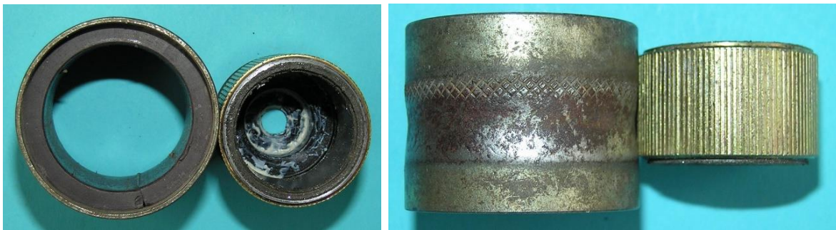
a b a b Bild 4.108: Vergleich der Magnetrings aus kunststoffgebundenem und aus gespritzten NdFeB: a) Soubitez, b) K-10900
