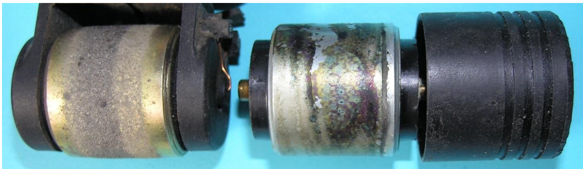
Bild 3.28: Oberflächenbeschichtung: a) Granulat, b) Gummirohr
