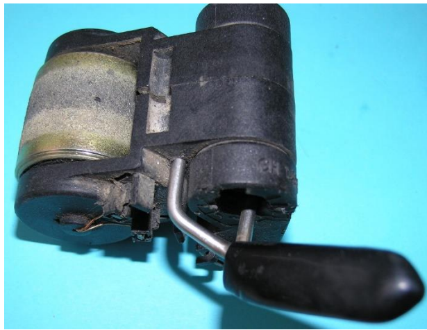
Bild 4.52: Verdrehung der Achsgabel: Ruhestellung, b) Maximale Verdrehung in der Betriebsstellung
