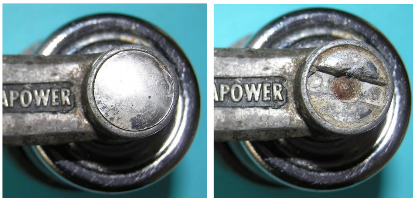
Bild 4.4: Befestigung der Achsgabel auf der Ankerachse: a) Mit einer Kreuzschlitzschraube, b) Von außen keine Sicherungsmaßnahme erkennbar
