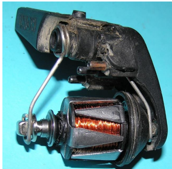
Bild 4.114: Einspannung des Ankers zwischen den Druckfedern: a) Ohne Lagerschalen des Polrades, b) Mit einer Polradlagerschale
