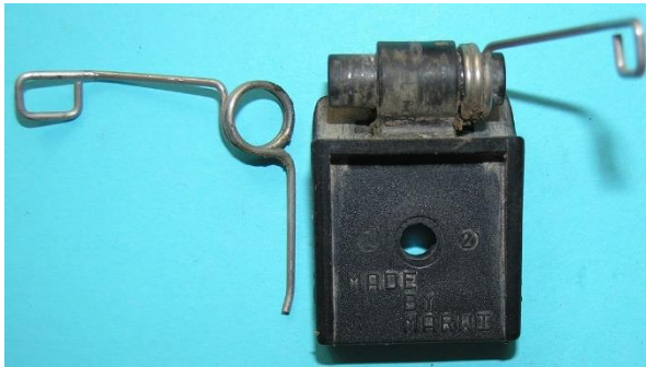
Bild 4.94: Am Halterarm angespritztes Drehrohr: a) Separate Feder, b) Im Schacht eingefügte Feder
