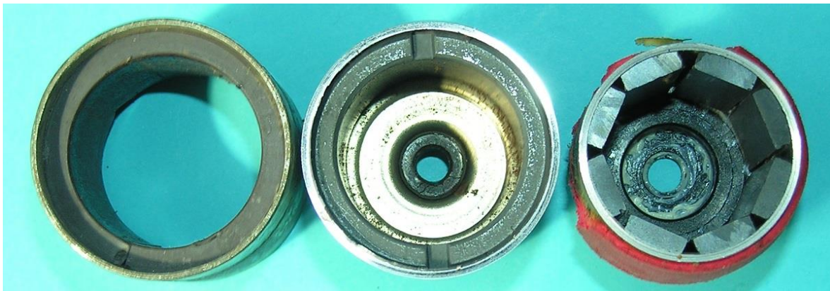
Bild 2.5: Magnetbestückung der Polräder: a) Soubitez: Kunststoffgebundener NdFeB-Streifen, b) NdFeB-Ringmagnet, c) Acht NdFeB-Segmente
